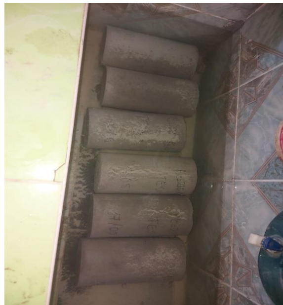
Foto 2: Pruebas cilíndricas curadas
