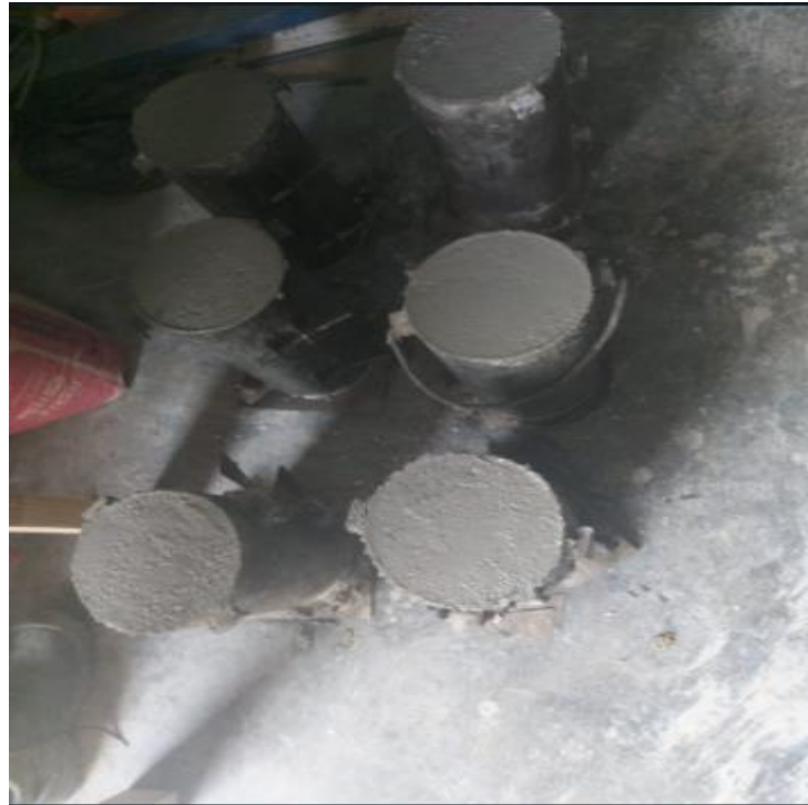
Foto 1: Pruebas cilíndricas de rotura
