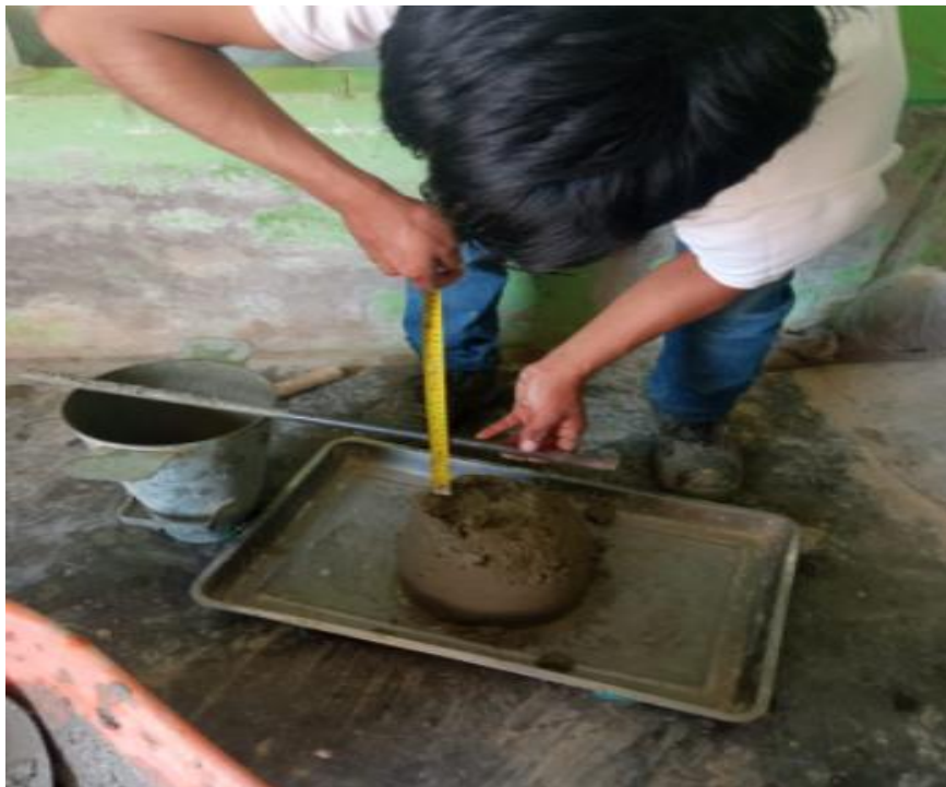
Foto 4. Medida de la prueba del slump
