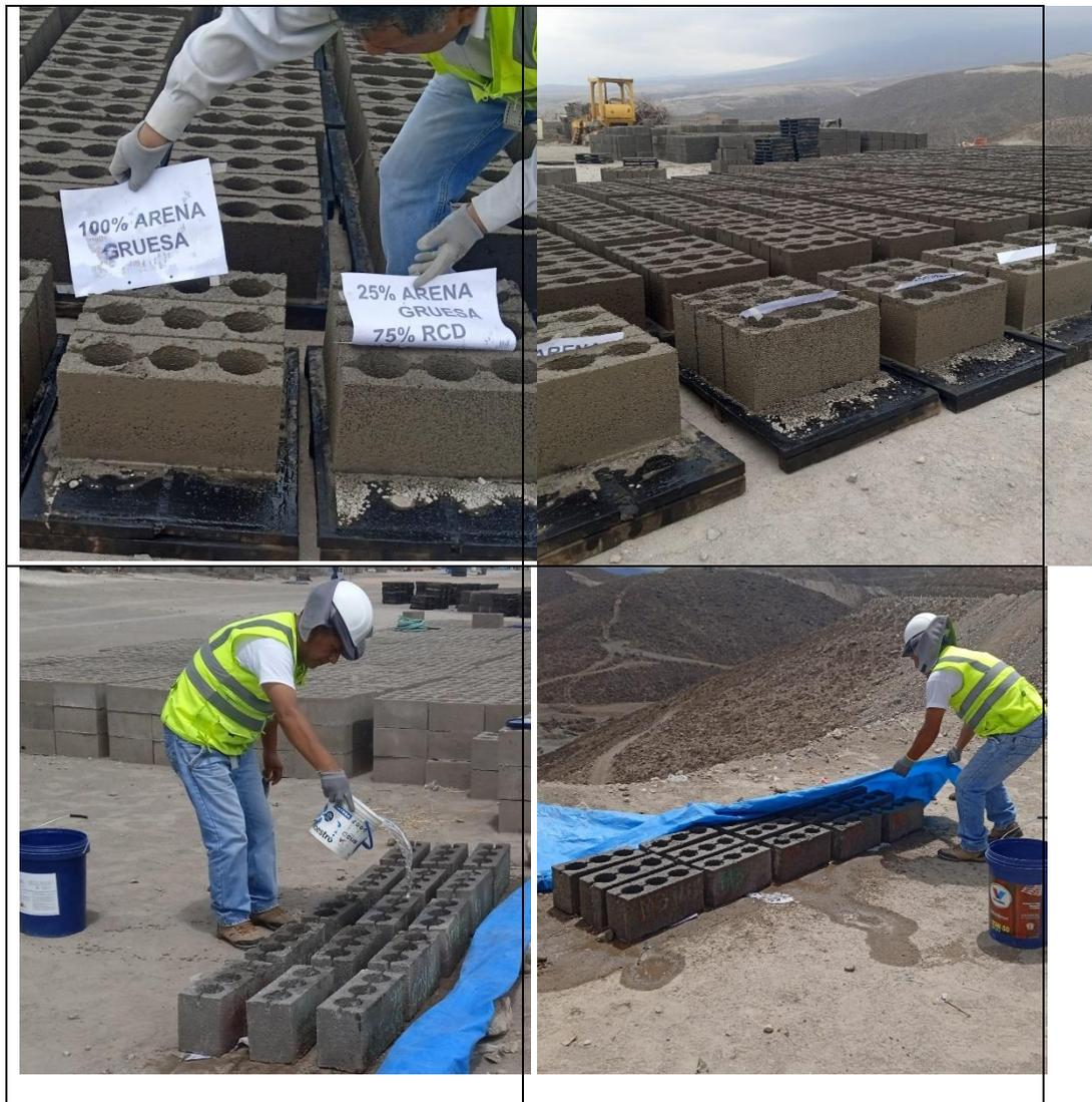
*Figura 9 en área de secado y curado las bloquetas*
