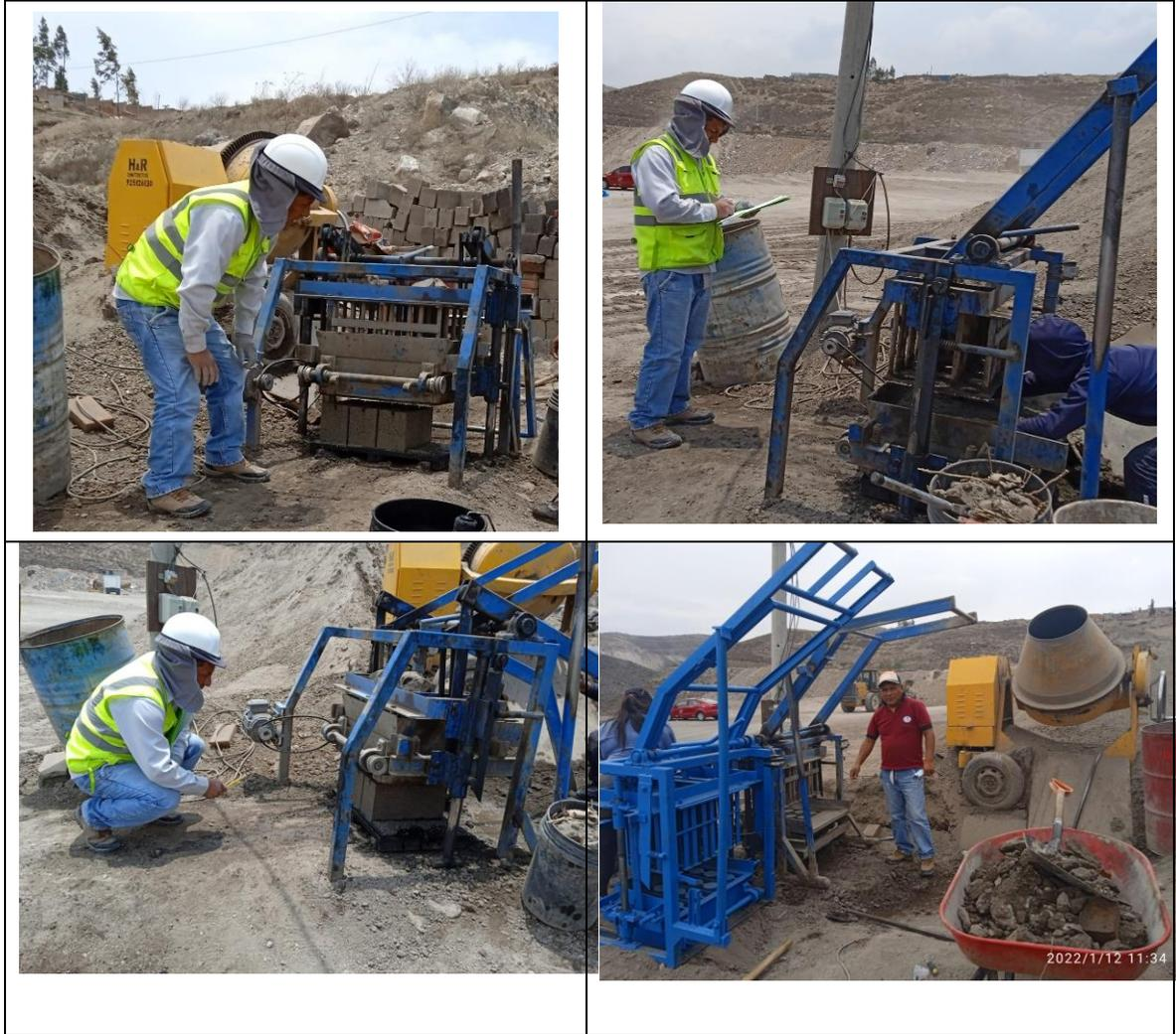
*Figura 8 Construcción de las bloquetas ecológicas.*
