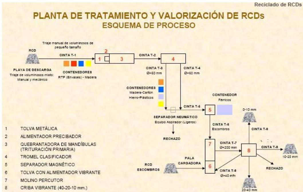
*Figura 2 Planta de Tratamiento y Valorización de RCD.*
