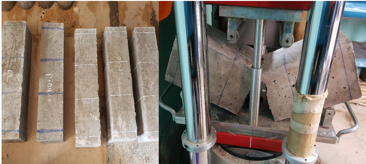
Figura 47. Probetas rotas en resistencia en flexión
