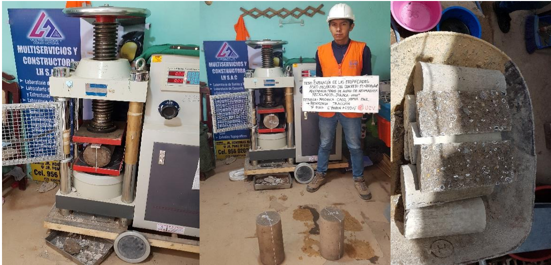
Figura 42. Probetas rotas en resistencia en tracción
