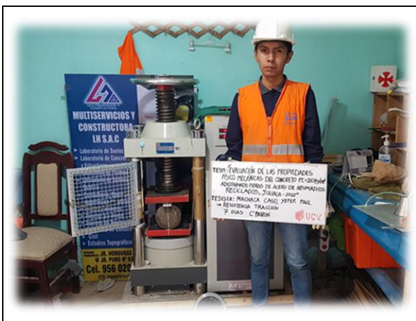
FECHA DE LA FOTOGRAFÍA 22 DE FEBR DEL 2022 Evidencia Fotográfica Nº 29 Ensayo de resistencia en tracción del concreto.
