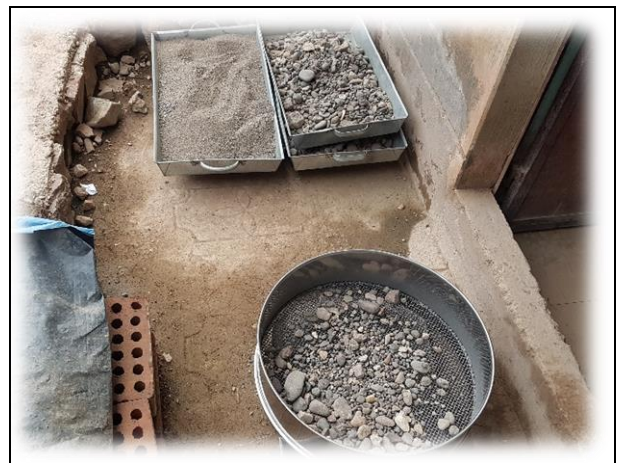
FECHA DE LA FOTOGRAFÍA 07 DE FEBR DEL 2022 Evidencia Fotográfica Nº 16 Separado de AF y AG por malla Nº4.
