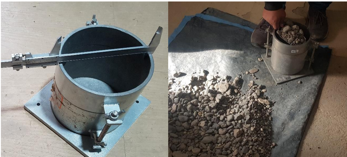
Figura 30. Proceso de determinación del ensayo de peso unitario del agregado
