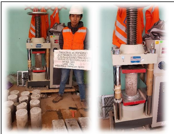
FECHA DE LA FOTOGRAFÍA 22 DE FEBR DEL 2022 Evidencia Fotográfica Nº 27 Ensayo de resistencia en compresión.
