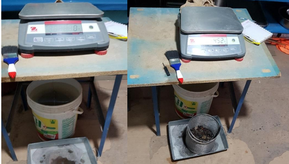
Figura 32. Ensayo de gravedad específica del agregado grueso
