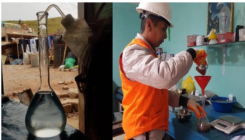
Figura 31. Ensayo de gravedad específica del agregado fino
