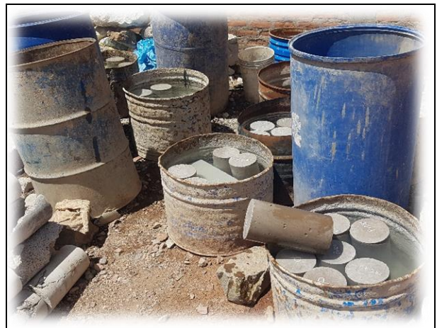
FECHA DE LA FOTOGRAFÍA 09 DE FEBR DEL 2022 Evidencia Fotográfica Nº 26 Curado de probetas y vigas de concreto.
