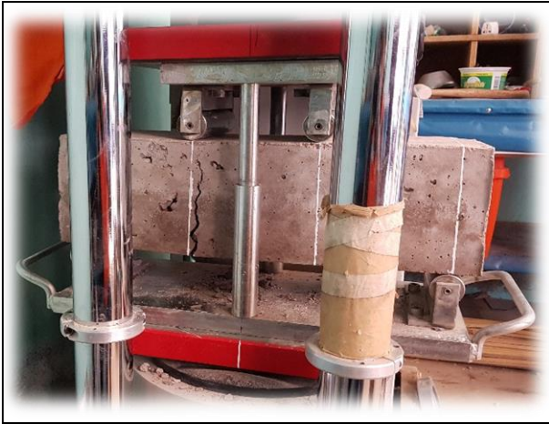
FECHA DE LA FOTOGRAFÍA 08 DE MAR DEL 2022 Evidencia Fotográfica Nº 31 Ensayo de resistencia en flexión.
