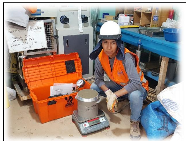
FECHA DE LA FOTOGRAFÍA 08 DE FEBR DEL 2022 Evidencia Fotográfica Nº 24 Peso unitario del concreto (PUC)
