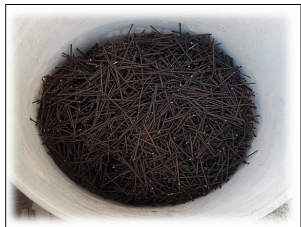
FECHA DE LA FOTOGRAFÍA 06 DE FEBR DEL 2022 Evidencia Fotográfica Nº 12 FANR sin oxido lista para incorporación en concreto.
