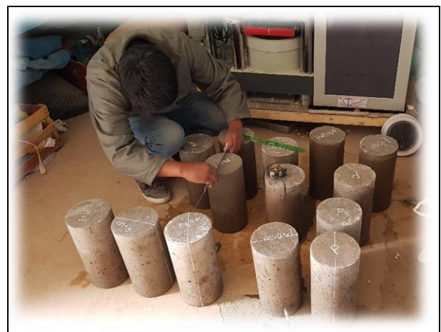
FECHA DE LA FOTOGRAFÍA 08 DE MAR DEL 2022 Evidencia Fotográfica Nº 34 Medición de diámetro y altura de probetas de C°.
