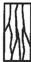
Tipo 3 Fisuras verticales enclumadas a través de ambos extremos, conos no bien formados.
