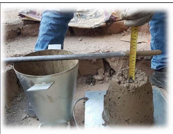
FECHA DE LA FOTOGRAFÍA 08 DE FEBR DEL 2022 Evidencia Fotográfica Nº 23 Asentamiento del concreto.
