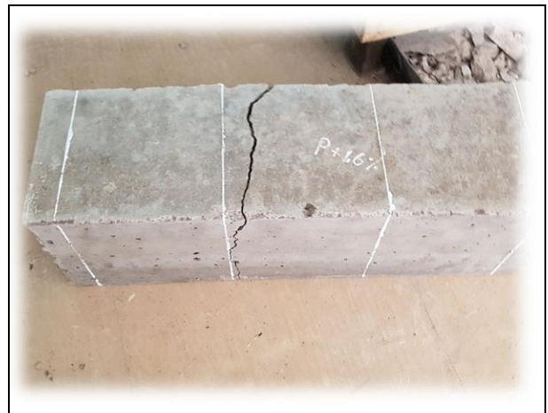
FECHA DE LA FOTOGRAFÍA 08 DE MAR DEL 2022 Evidencia Fotográfica Nº 32 Ruptura de vigas de concreto en RF.
