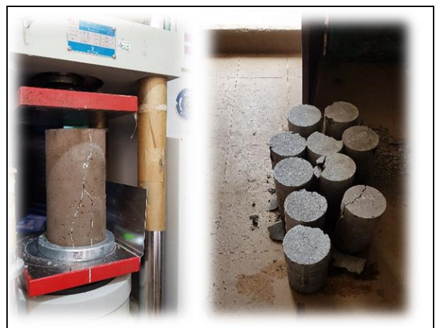
FECHA DE LA FOTOGRAFÍA 22 DE FEBR DEL 2022 Evidencia Fotográfica Nº 28 Ruptura de probetas de concreto en RC.
