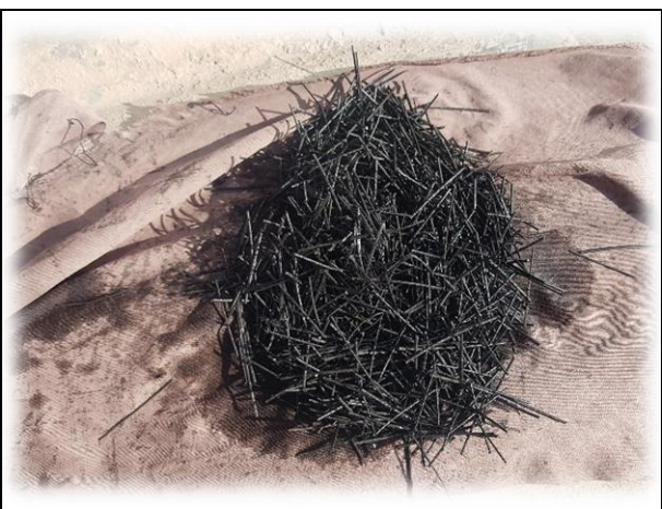
FECHA DE LA FOTOGRAFÍA 06 DE FEBR DEL 2022 Evidencia Fotográfica Nº 11 Secado de la fibra después de tratamiento.
