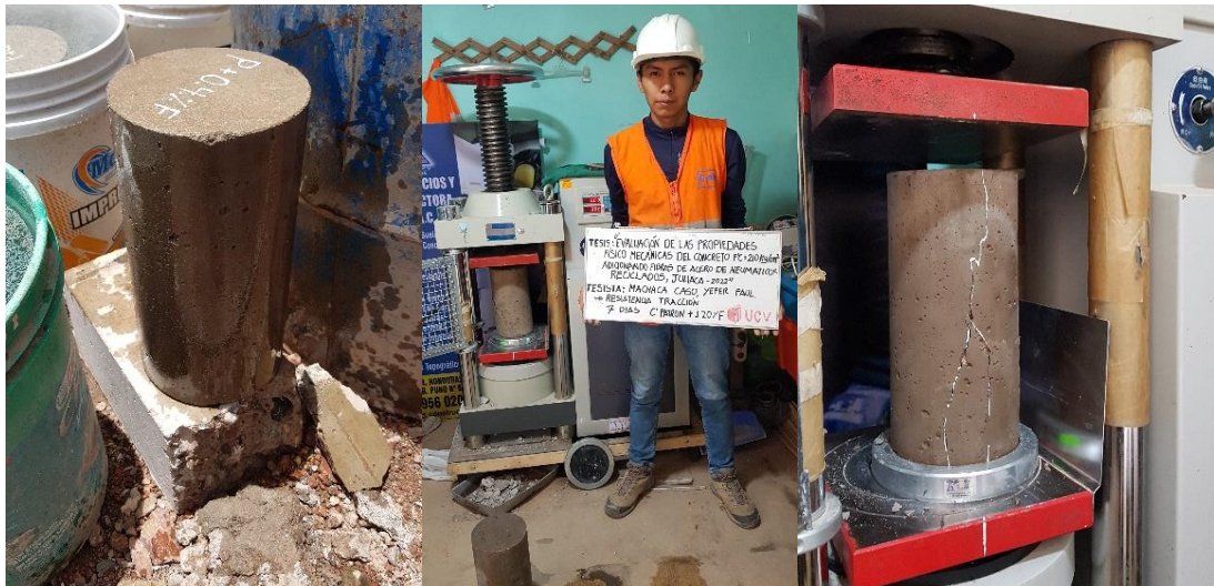
Figura 37. Probetas rotas en resistencia en compresión
