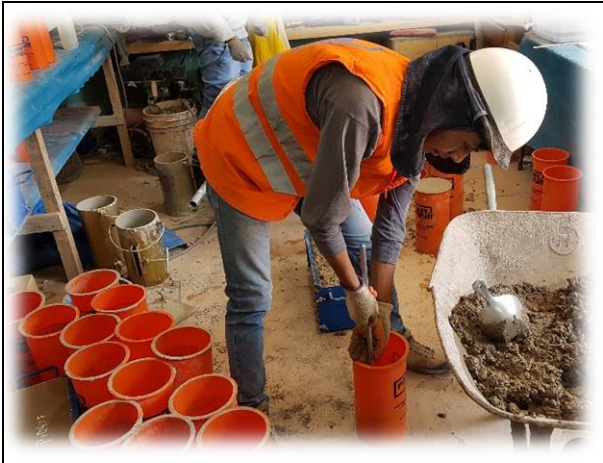
FECHA DE LA FOTOGRAFÍA 08 DE FEBR DEL 2022 Evidencia Fotográfica Nº 25 Elaboración de probetas y vigas de concreto.
