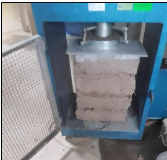
**Figura 14:** Compresion pila adobe.
