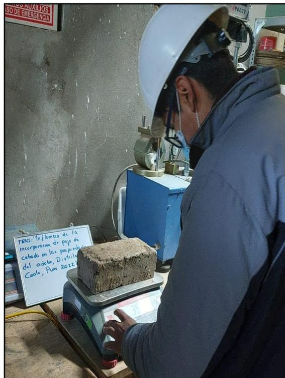
**Fotografía 38:** Pesado de muestras de adobe para ensayo de absorción
