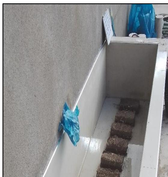
**Figura 18** Ensayo absorcion
