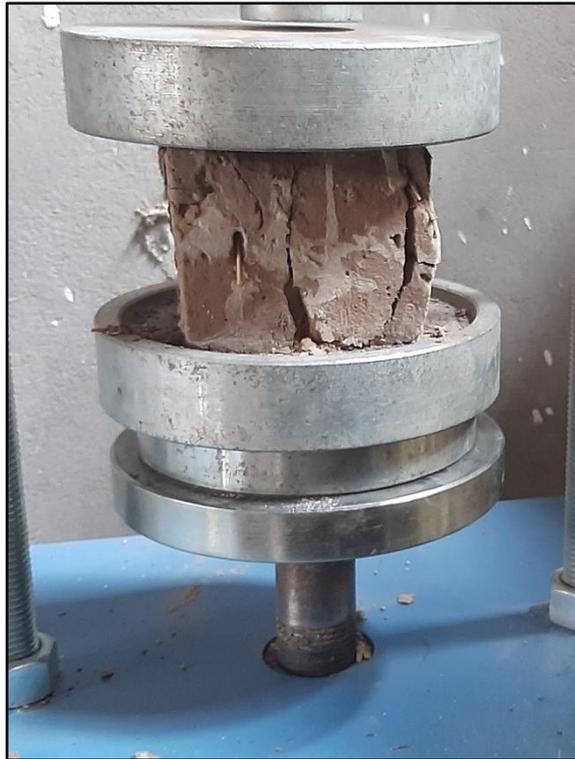
**Fotografía 31:** Muestra de ensayo a compresión roturada
