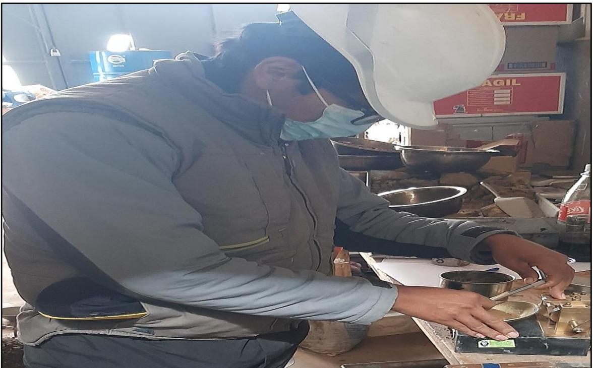
**Fotografía 26:** Ensayo de limite liquido
