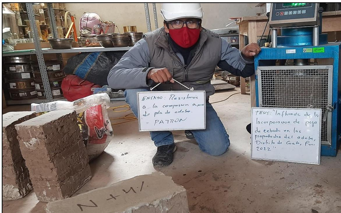
**Fotografía 34:** Ensayo de resistencia a la compresión axial de la pila de adobe
