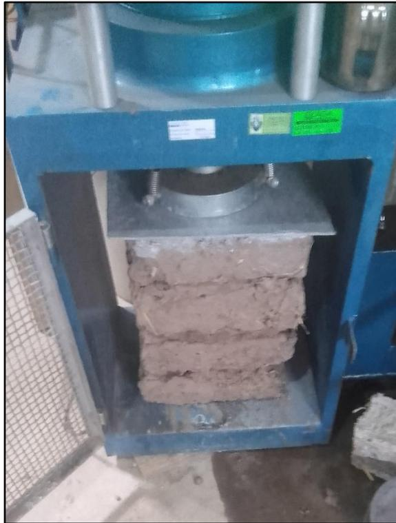
**Fotografía 35:** Muestras de pila de adobe en máquina de compresión
