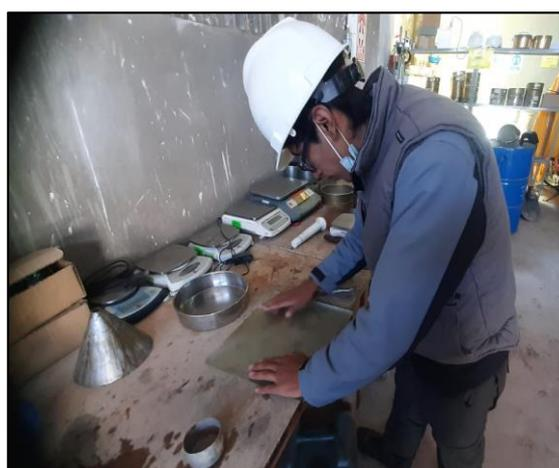
**Figura 10:** Ensayo de limite plastico
