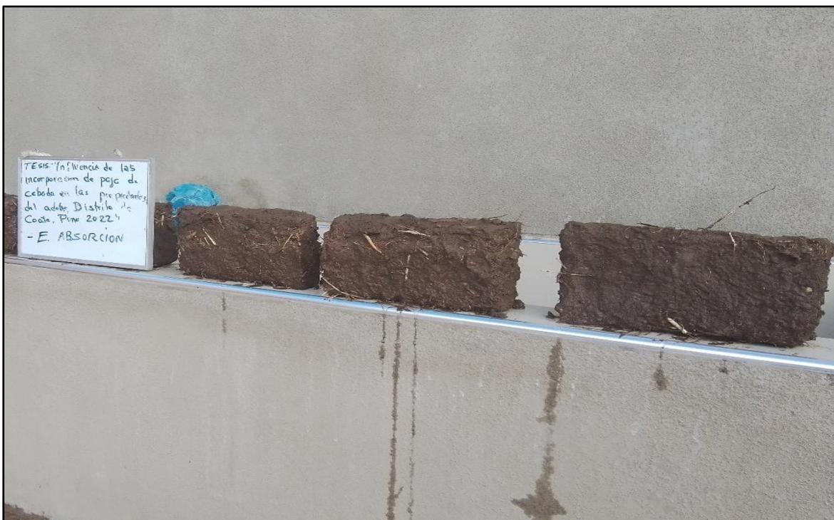
**Fotografía 40:** Muestras sometidas a ensayo de absorción
