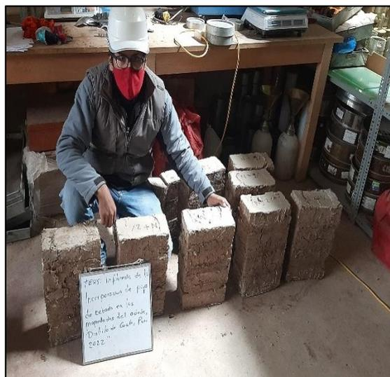
**Figura 15:** Pilas de adobe fracturadas
