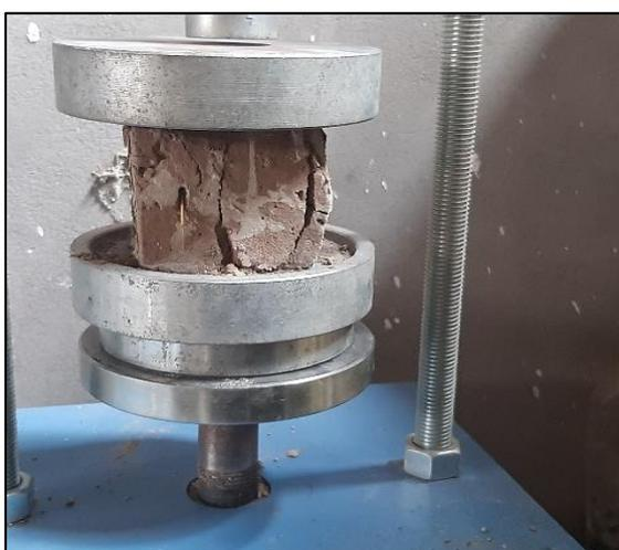
**Figura 11:** Rotura de especimen.
