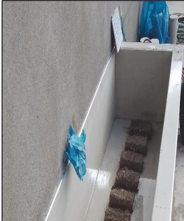
**Fotografía 39:** Ensayo de absorción
