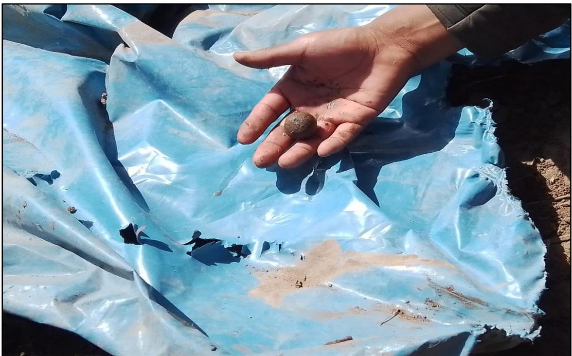
**Fotografía 04:** Verificación de presencia de arcilla, prueba resistencia seca
