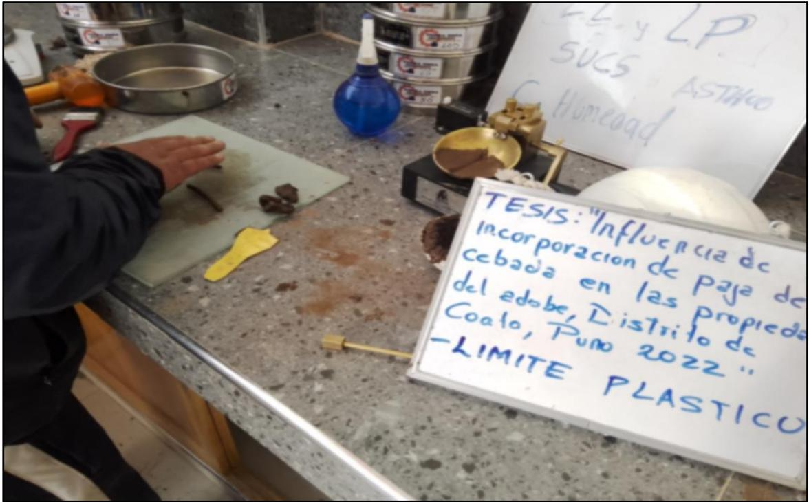
**Fotografía 27:** Ensayo de limite plástico
