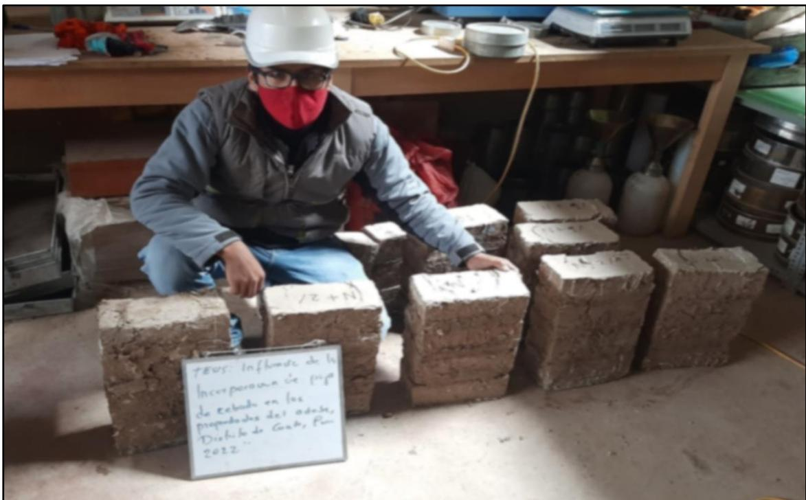
**Fotografía 36:** Muestras de pilas de adobe sometidas a ensayo de compresión axial
