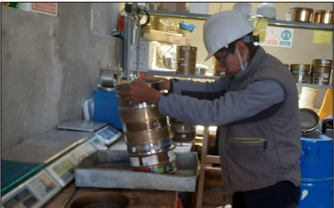
**Fotografía 24:** Realización de ensayo de granulometría
