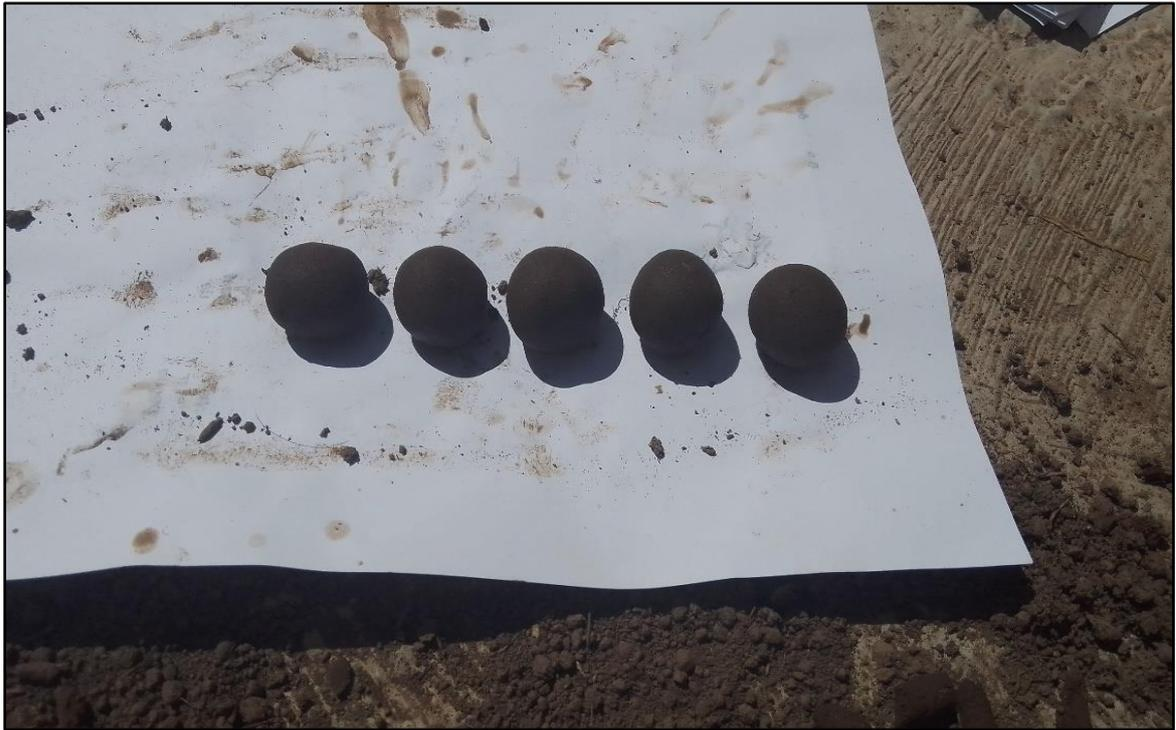
**Fotografía 03:** Verificación de presencia de arcilla, prueba resistencia seca
