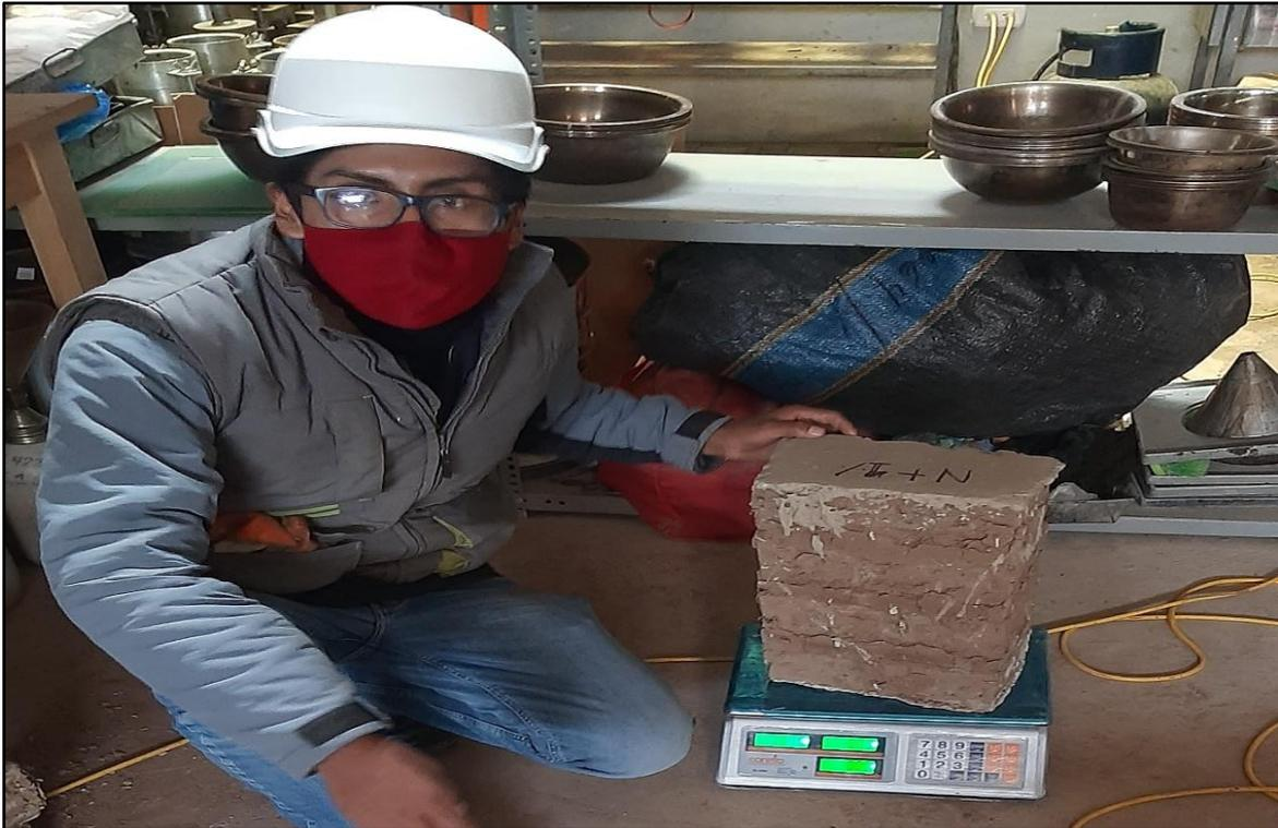
**Fotografía 33:** Pesado y medición de pila de adobe
