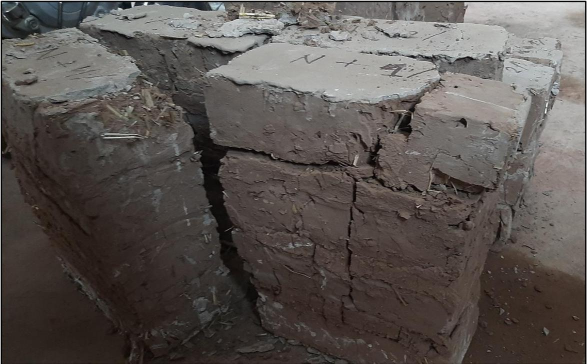
**Fotografía 37:** Pilas de adobe fracturadas
