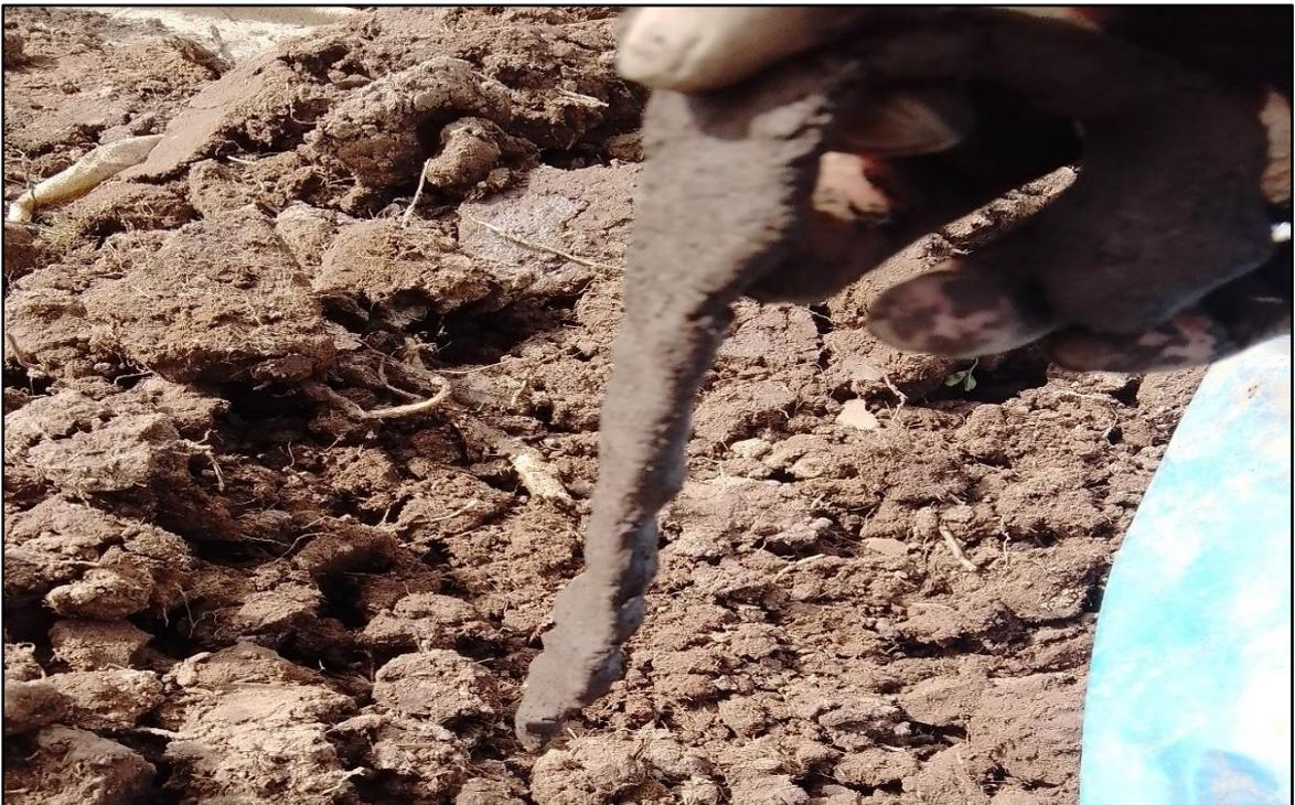
**Fotografía 02:** Verificación de arcilla en la tierra, prueba de cinta de barro
