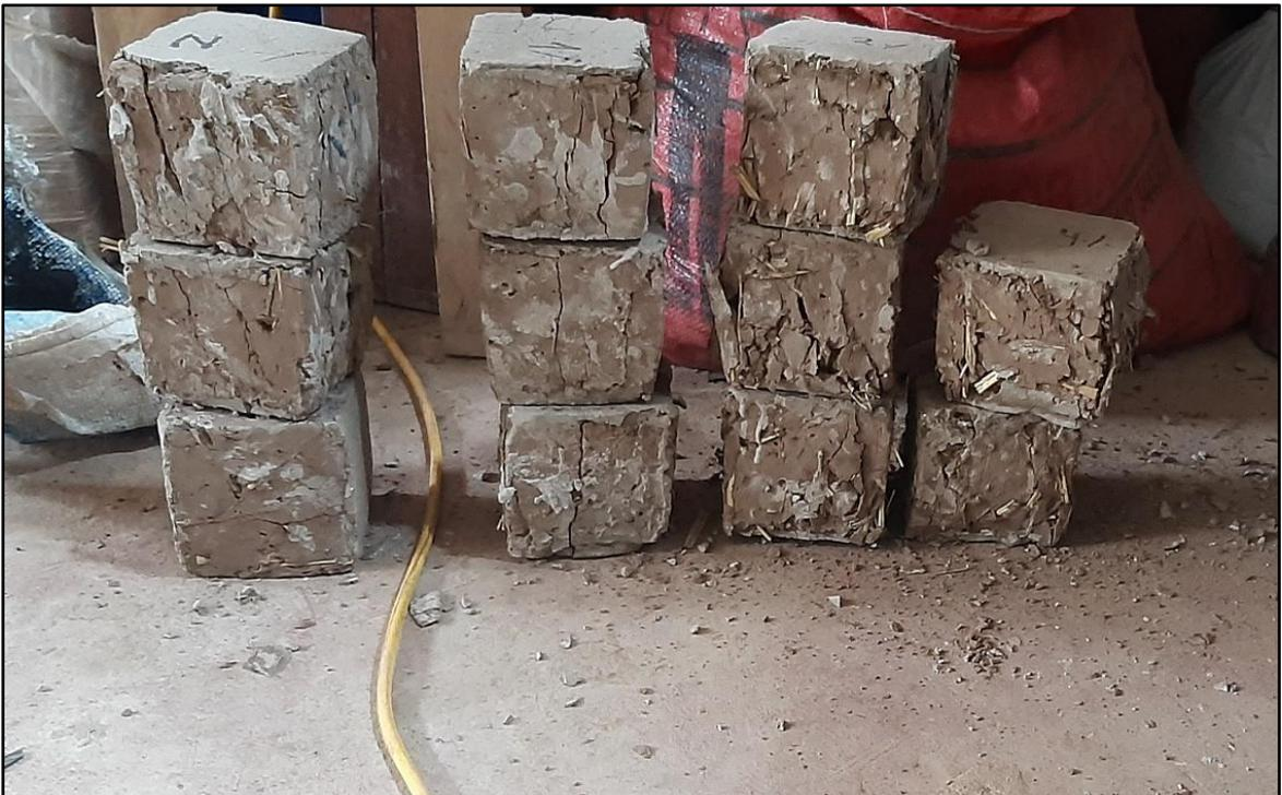
**Fotografía 32:** Muestras sometidas a ensayo de compresión
