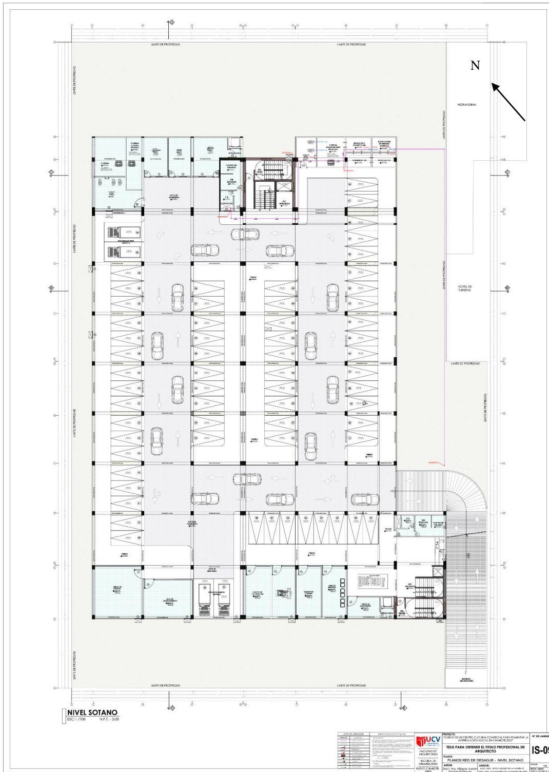
Plano de instalaciones Desagüe nivel sótano
