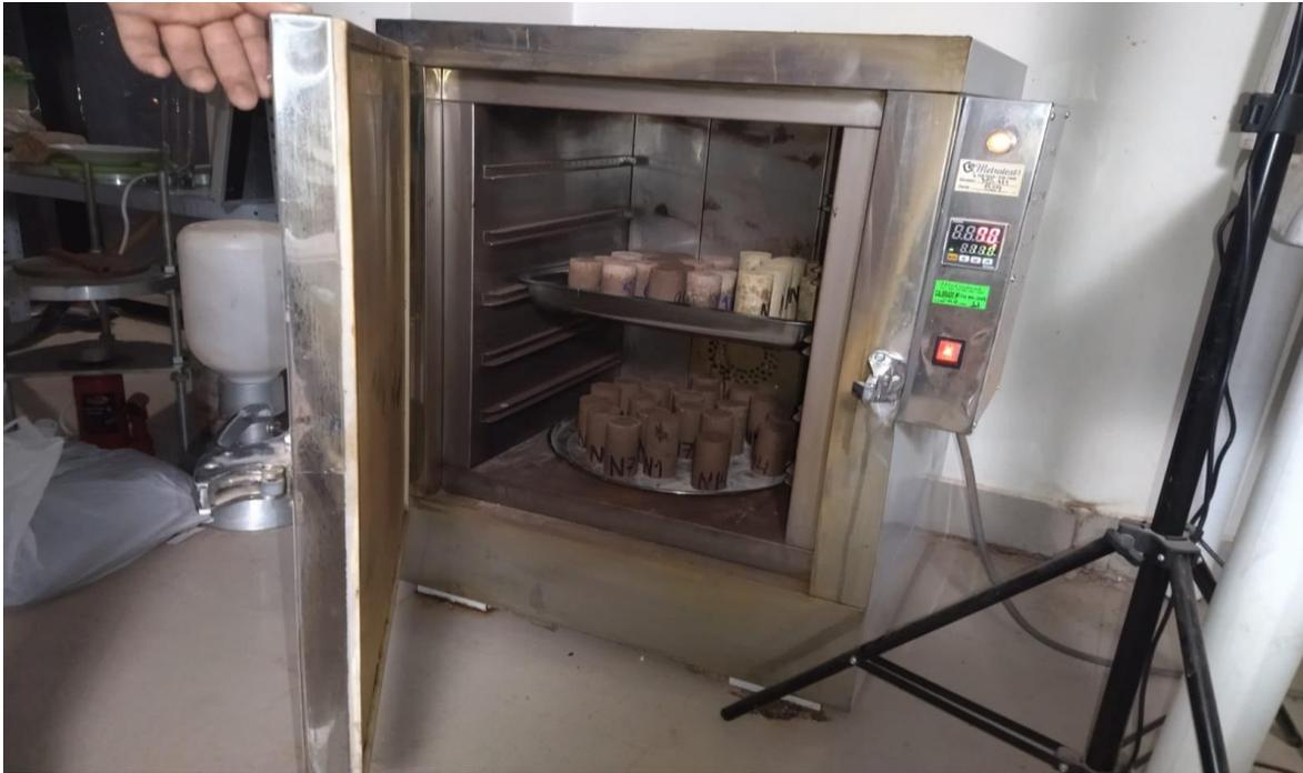
*foto 11: vista de colocación de especímenes de suelo a horno eléctrico.*
