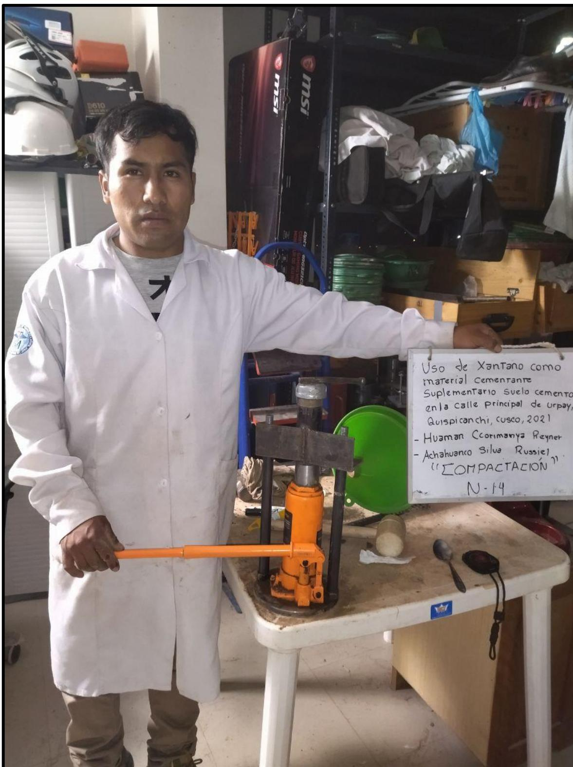
**Foto 07: vista de compactación de suelo mezclado con xantano en gata hidráulica.**
