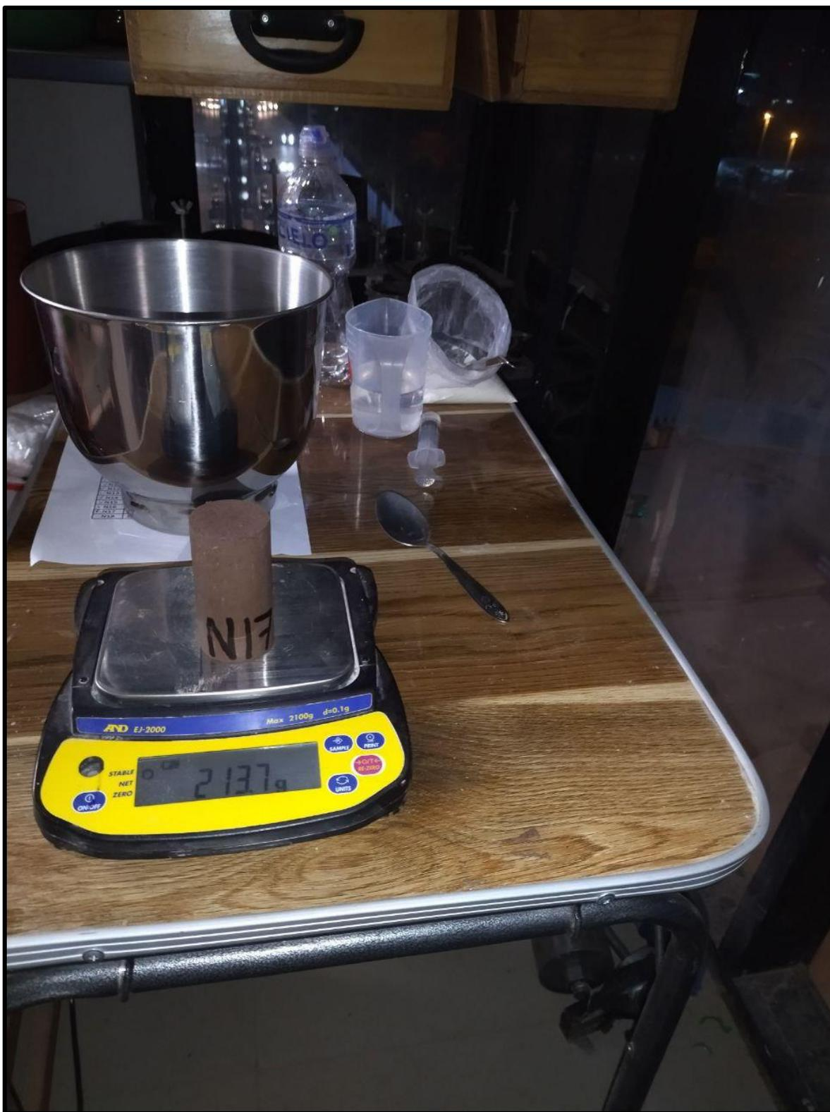
**Foto 09: vista de pesaje de espécimen de suelo con adición de xantano.**
