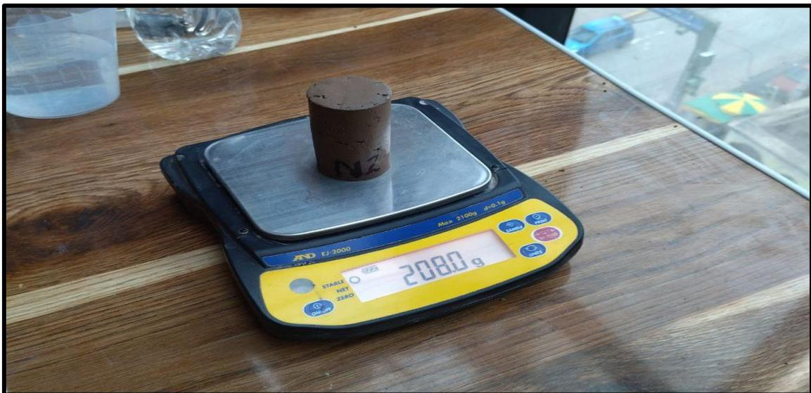
*foto 12: balanza electrónica*
