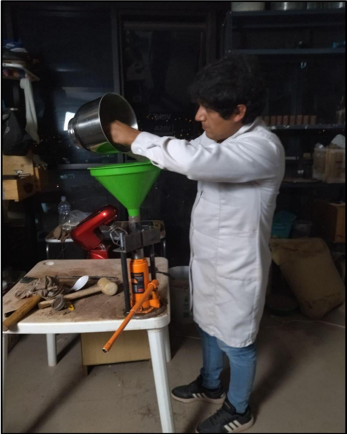
***Foto 06: vista de colocación del suelo mezclado con xantano a la prensa hidráulica.***
