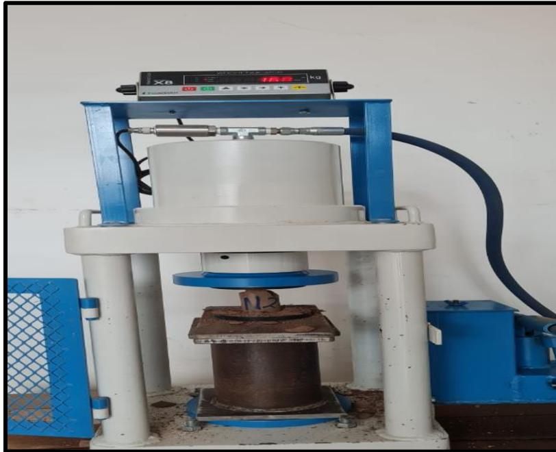
*foto 14: Resistencia a la compresión simple*
