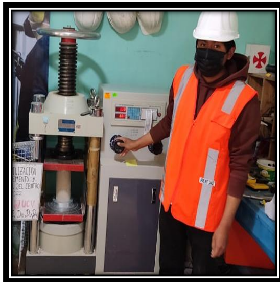
Figura 21 Rotura de probetas del ensayo compresión simple
