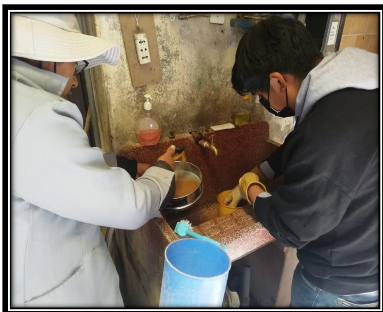
Fotografía 02: Lavado de la muestra en la malla N°200
