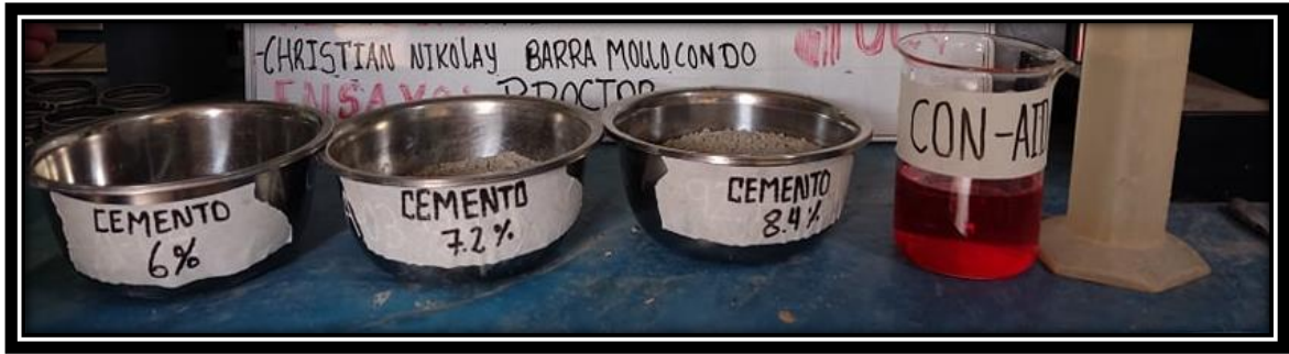
Figura 14 Dosificación del cemento, con-aid y agua.
