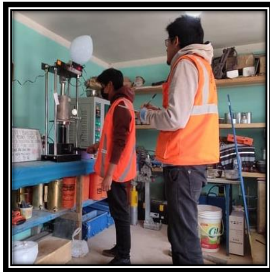
Figura 18 Ensayo C.B.R penetración
