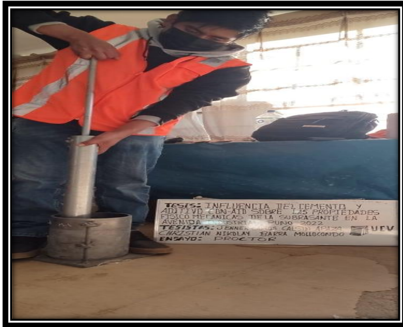
Fotografía 11: Compactación en el ensayo de proctor modificado.
