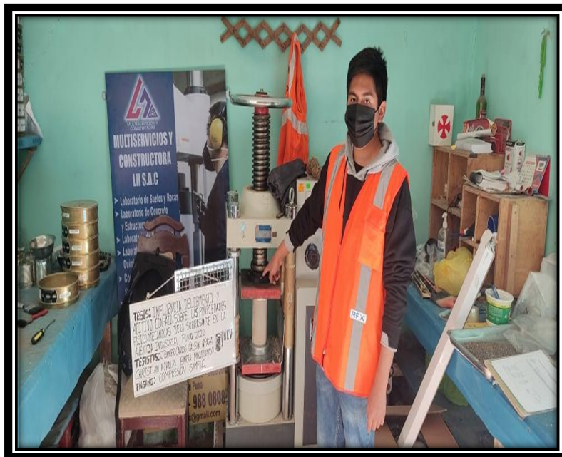
Fotografía 14: Rotura de briquetas del ensayo de compresión simple.
