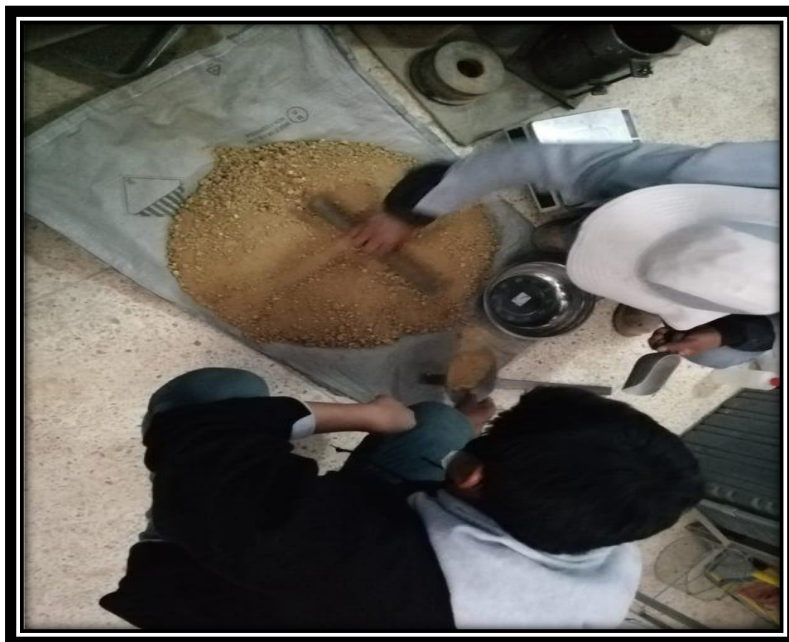
Fotografía 01: Cuarteo del suelo natural.
