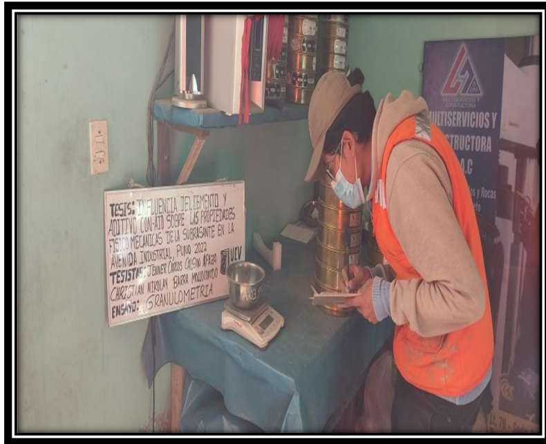
Fotografía 05: Pesado del material retenido por cada tamiz.
