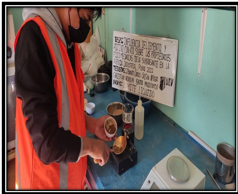
Fotografía 06: Ensayo de límite líquido.
