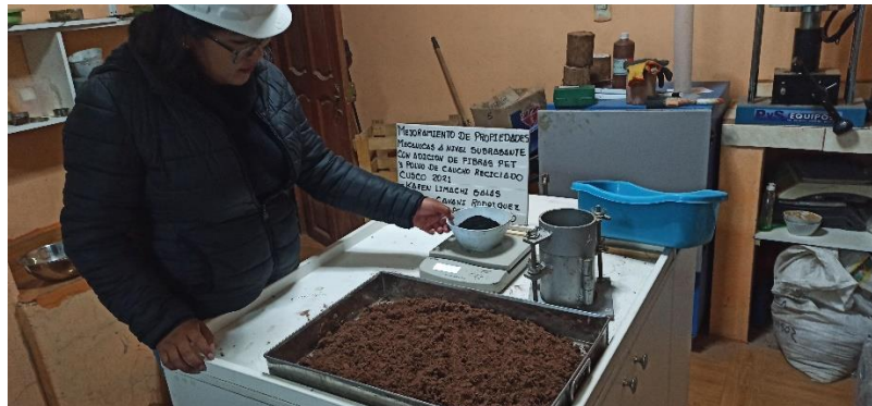
Ensayo: Equipos y materiales ensayo CBR con adición de polvo de caucho reciclado
