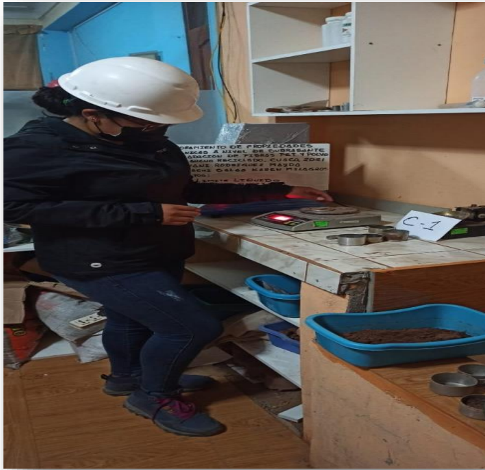
Ensayo: contenido de humedad natural de las muestras
