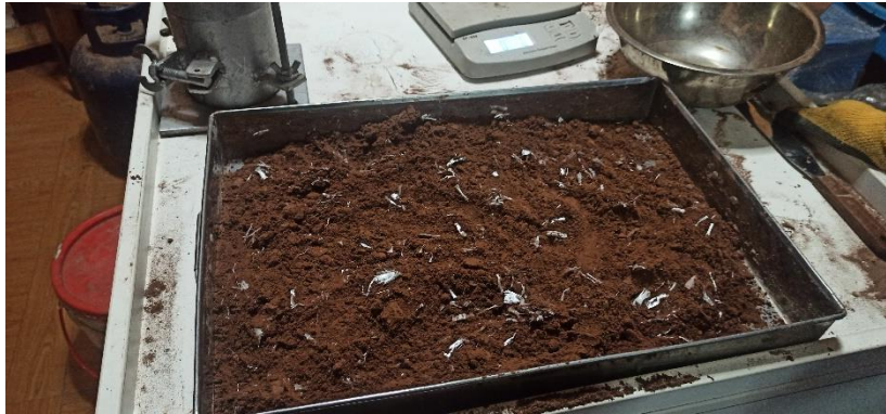
Ensayo: California Bearing Ratio (CBR) con la adición de fibra PET
