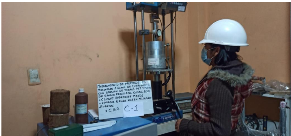
Ensayo: prueba de california bearing ratio (CBR)
