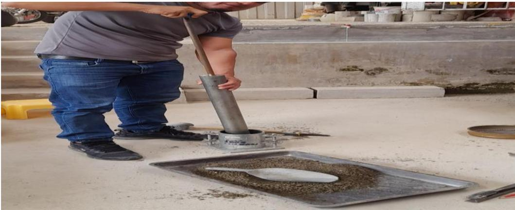
Imagen 8. Ensayo de proctor modificado. Fuente: elaboración propia.
