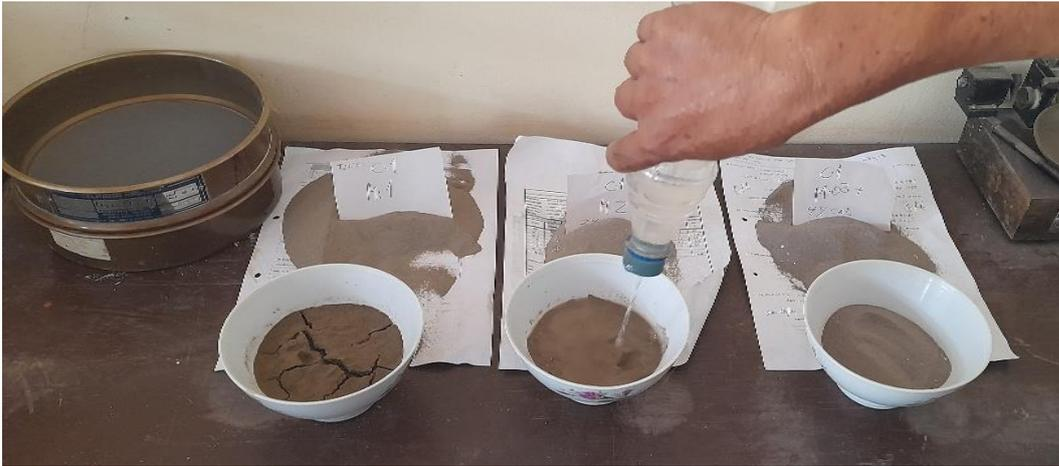
Imagen 12. Ensayo de límites de consistencia. Fuente: elaboración propia.
