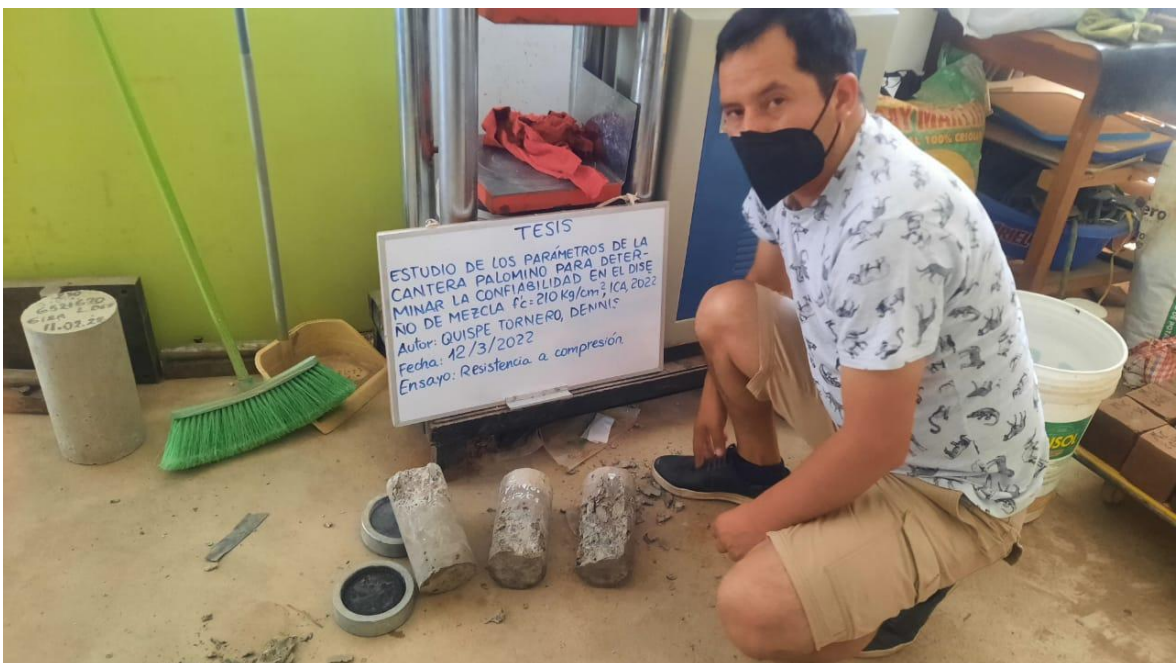
Figura 16. Post ensayo a compresión de probetas a 21 días de fraguado
