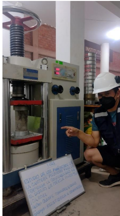
Figura 17. Ensayo a compresión de probeta a 28 días
