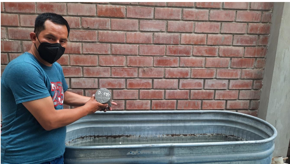
Figura 10. Extracción de probeta de concreto edad 7 días
