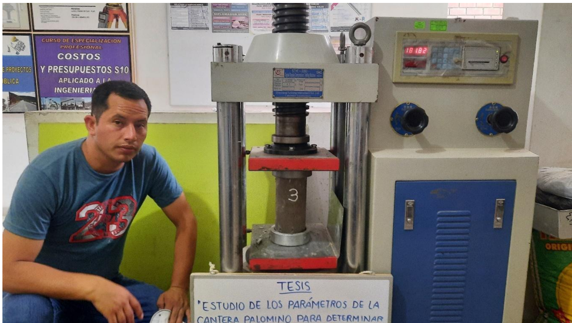
Figura 11. Ensayo de compresión del concreto 7 días
