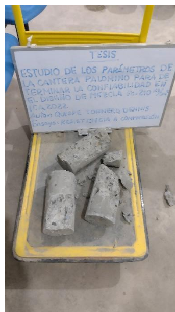
Figura 18. Post ensayo a compresión de probetas a 28 días de fraguado
