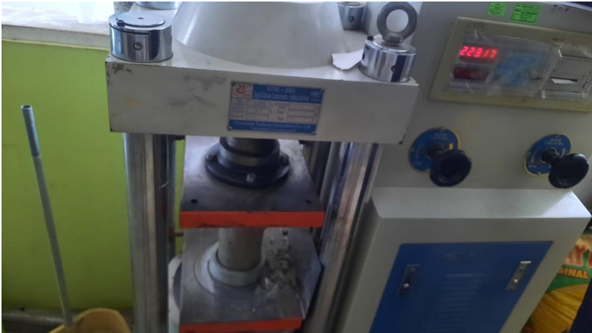
Figura 15. Ensayo a compresión de probeta a 21 días
