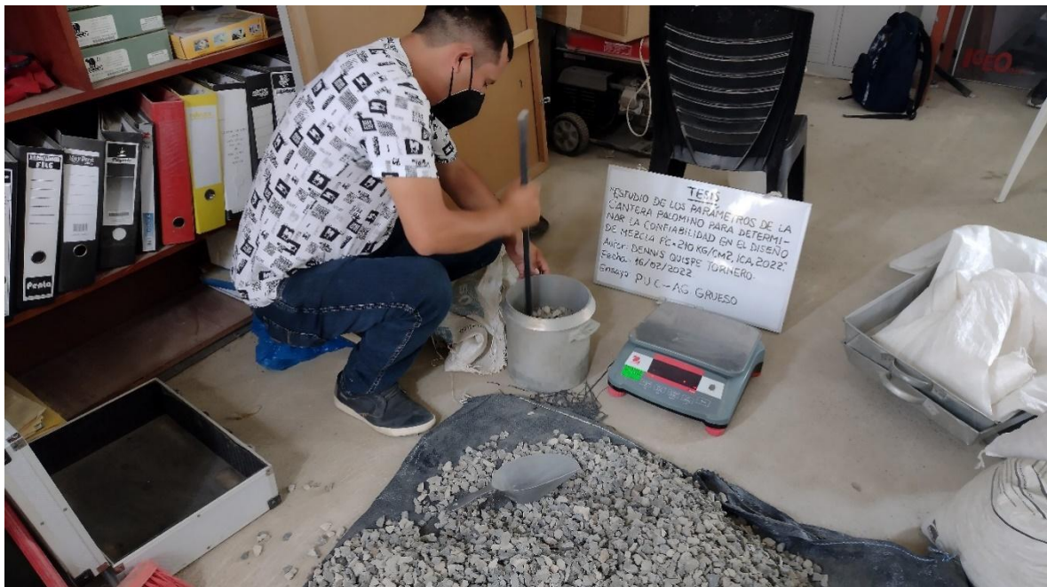
Figura 6. Obtención de peso de las muestras
