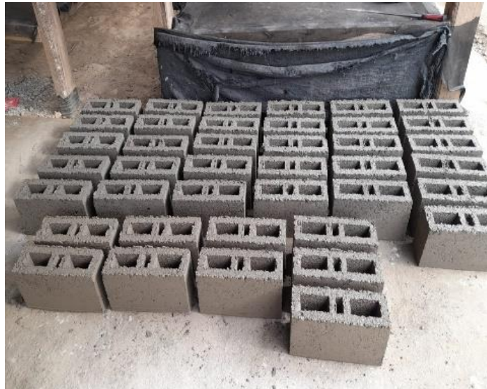
Foto N°03: Secado y curado del bloque de hormigón para mejorar la resistencia a la compresión en las viviendas del distrito de Jaén – Cajamarca, 2021.
