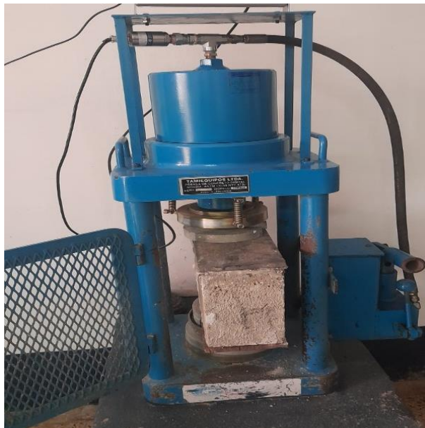
Foto N°04: Ensayo de laboratorio de compresión para mejorar la resistencia en las viviendas del distrito de Jaén – Cajamarca, 2021.
