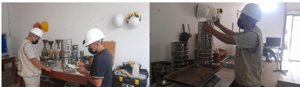
Figura 1: Ensayo granulométrico del vidrio
