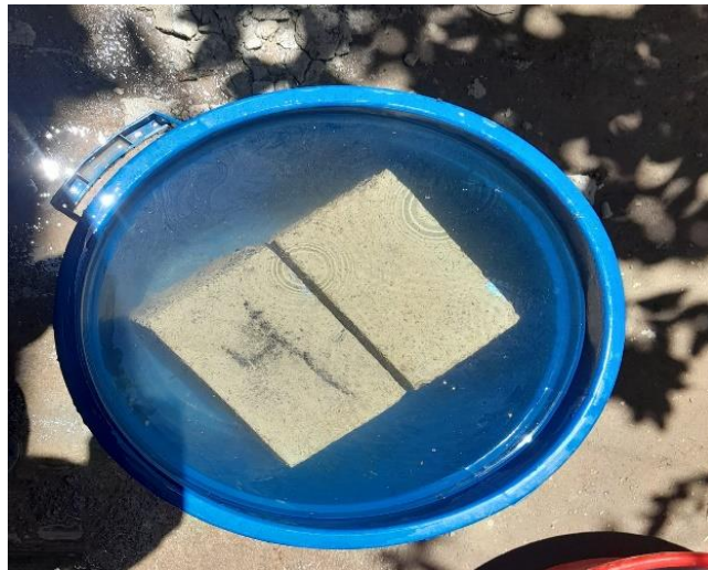
Foto N°04: Saturación del bloque de hormigón para mejorar la resistencia a la compresión en las viviendas del distrito de Jaén – Cajamarca, 2021.
