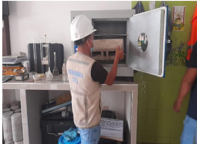
Foto N°05: Secado del bloque de hormigón para determinar la absorción de humedad en las viviendas del distrito de Jaén – Cajamarca, 2021.
