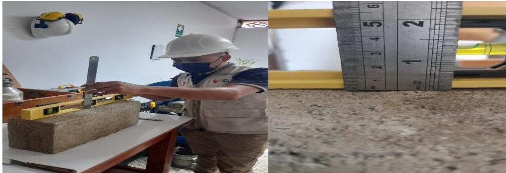
Figura 7: Ensayo de Alabeo
