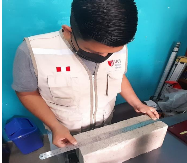
Foto N°04: Ensayo de variabilidad dimensional para mejorar la resistencia en las viviendas del distrito de Jaén – Cajamarca, 2021.
