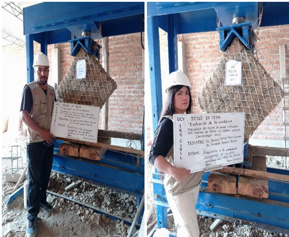
Ensayo de compresión diagonal - muretes con malla de cabuya 5 cm Fuente: Elaboración propia
