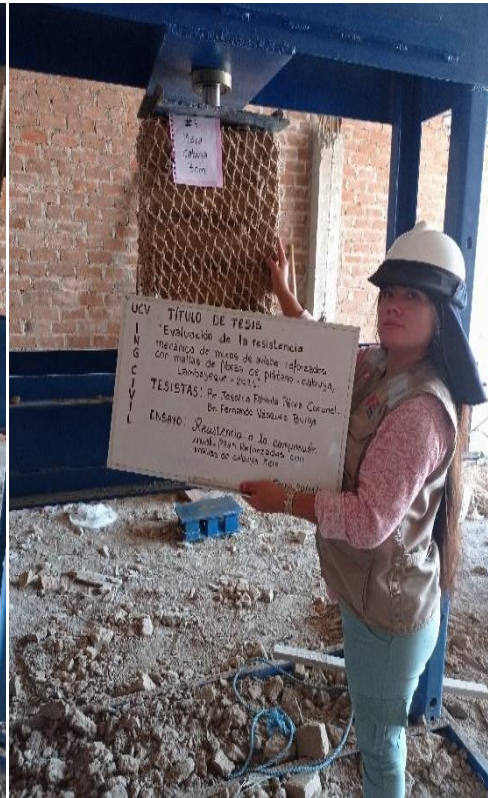
Ensayo de compresión axial - pilas con malla de cabuya 3 cm Fuente: Elaboración propia
