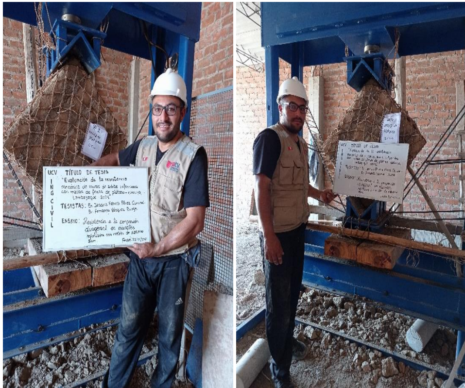
Ensayo de compresión diagonal - muretes con malla de plátano 5 cm Fuente: Elaboración propia
