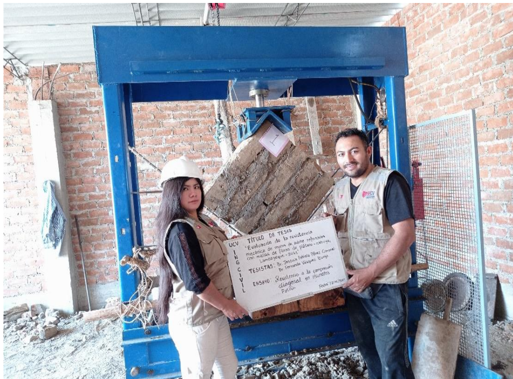
Figura 20. Ensayo de compresión diagonal - muretes patrón
