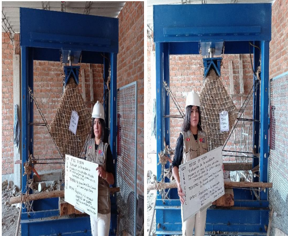
Ensayo de compresión diagonal - muretes con malla de cabuya 4 cm Fuente: Elaboración propia
