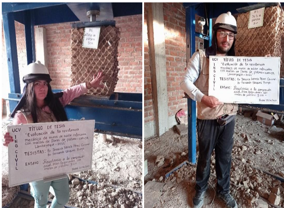
Ensayo de compresión axial - pilas con malla de plátano 3 cm Fuente: Elaboración propia
