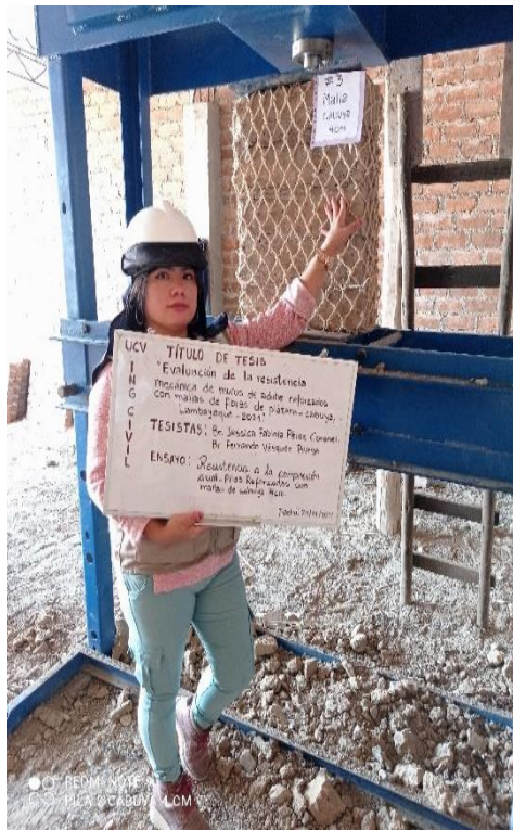
Ensayo de compresión axial - pilas con malla de cabuya 4 cm Fuente: Elaboración propia
