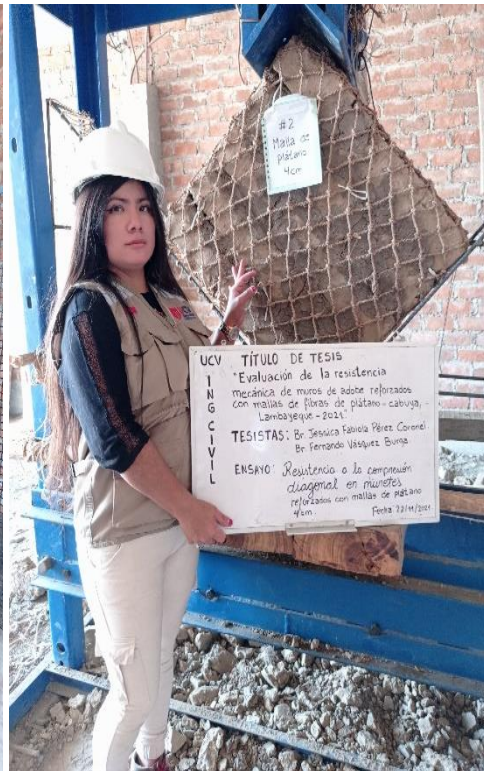
Ensayo de compresión diagonal - muretes con malla de plátano 4 cm Fuente: Elaboración propia
