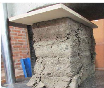
Figura 8. Ensayo de compresión axial
