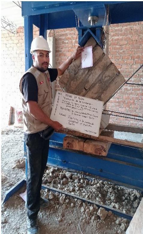
Ensayos de compresión diagonal en muretes patrón Fuente: Elaboración propia
