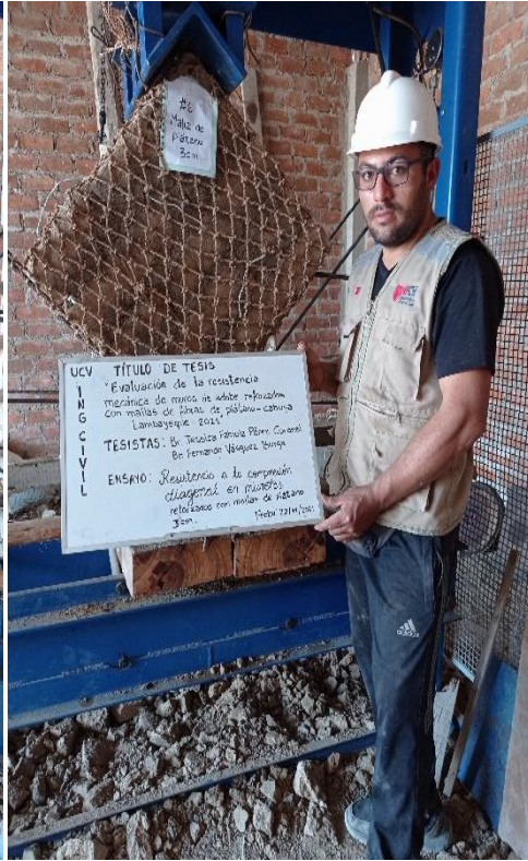
Ensayo de compresión diagonal - muretes con malla de plátano 3 cm Fuente: Elaboración propia
