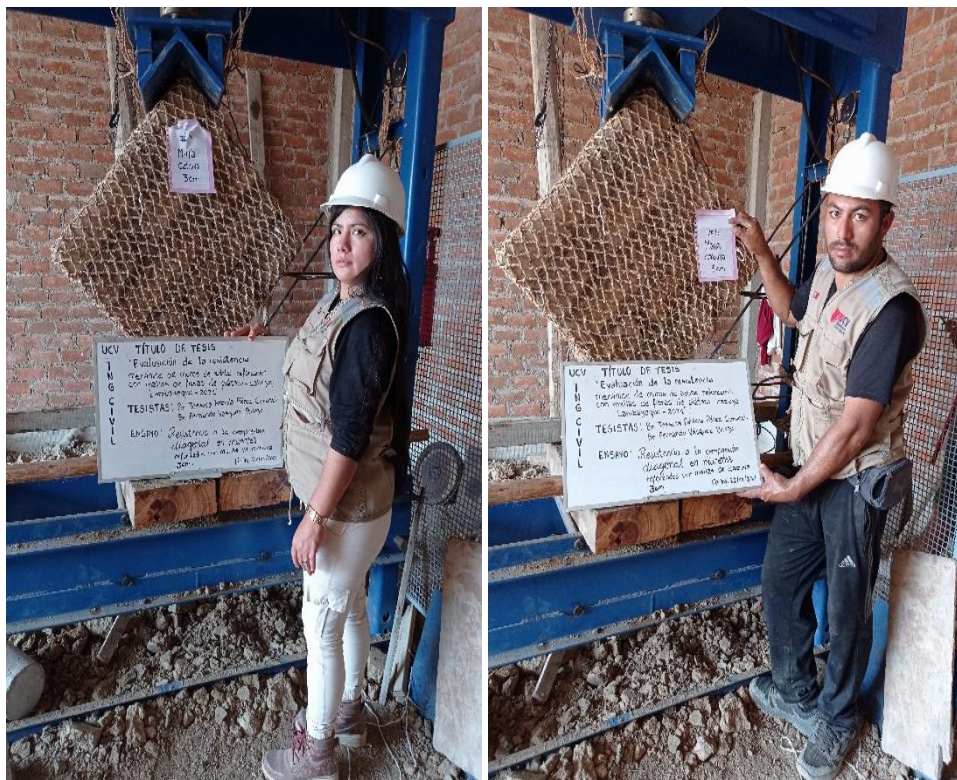
Ensayo de compresión diagonal - muretes con malla de cabuya 3 cm Fuente: Elaboración propia
