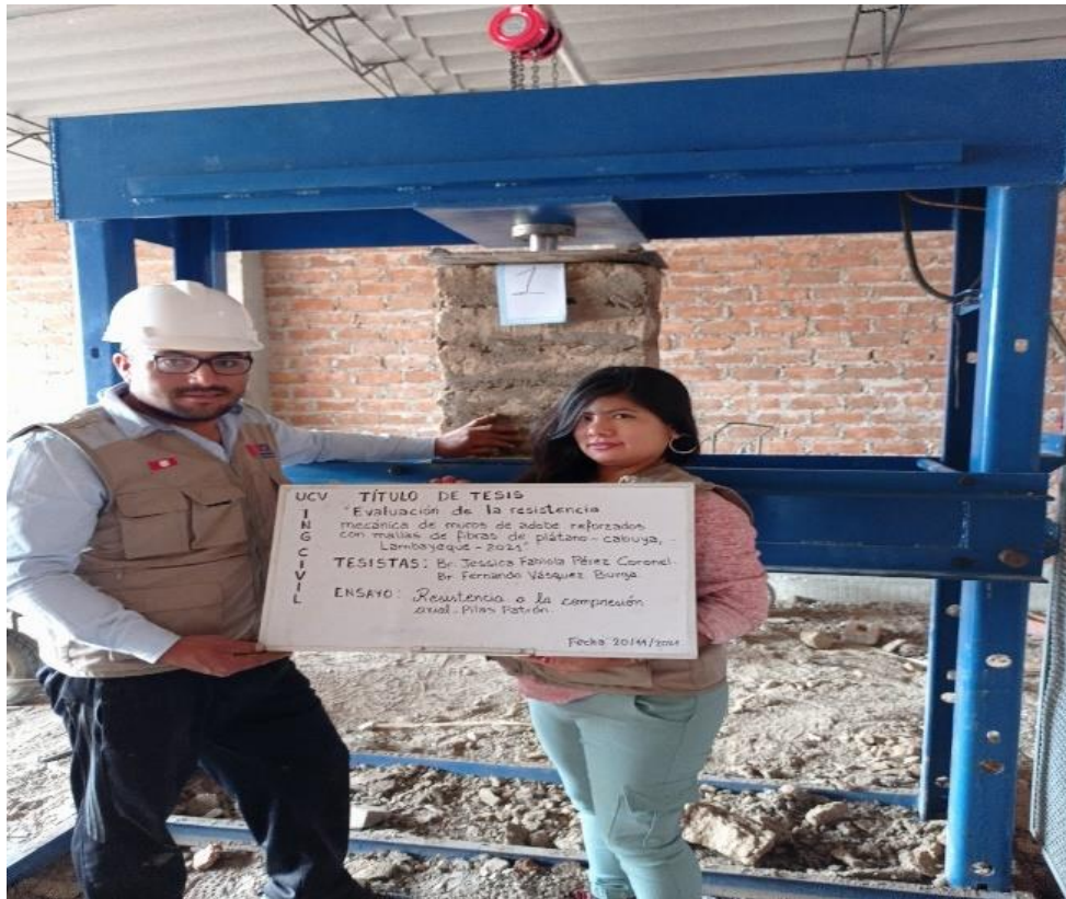
Figura 17. Ensayo de compresión axial - pilas patrón
