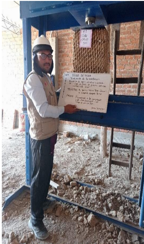
Ensayo de compresión axial - pilas con malla de cabuya 3 cm Fuente: Elaboración propia
