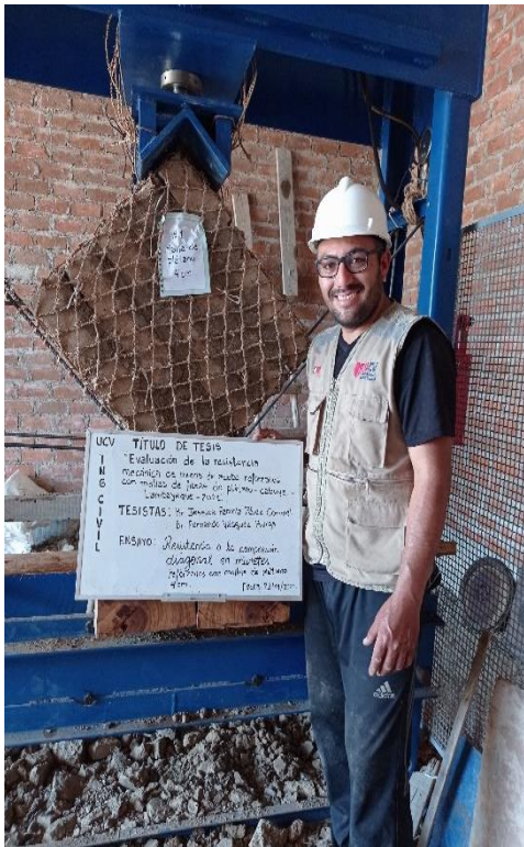
Ensayo de compresión diagonal - muretes con malla de plátano 4 cm Fuente: Elaboración propia
