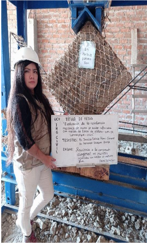
Ensayo de compresión diagonal - muretes con malla de plátano 3 cm Fuente: Elaboración propia
