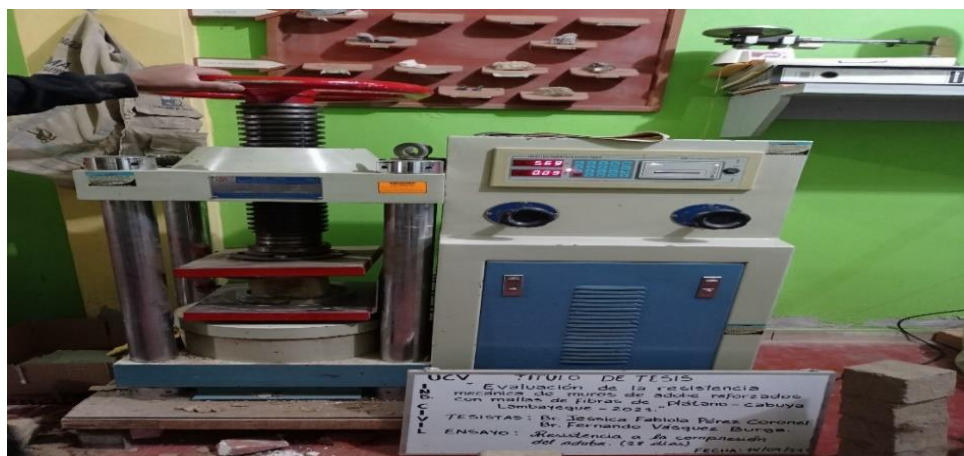
Ensayo de compresión en cubos Fuente: Elaboración propia
