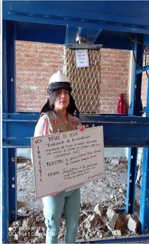
Ensayo de compresión axial - pilas con malla de cabuya 5 cm Fuente: Elaboración propia
