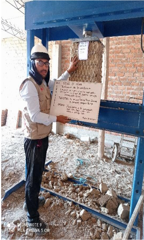
Ensayo de compresión axial - pilas con malla de cabuya 5 cm Fuente: Elaboración propia
