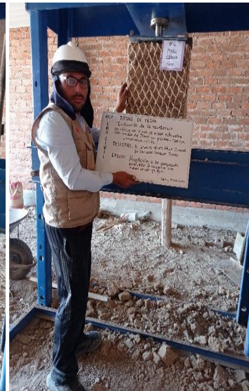
Ensayo de compresión axial - pilas con malla de cabuya 4 cm Fuente: Elaboración propia
