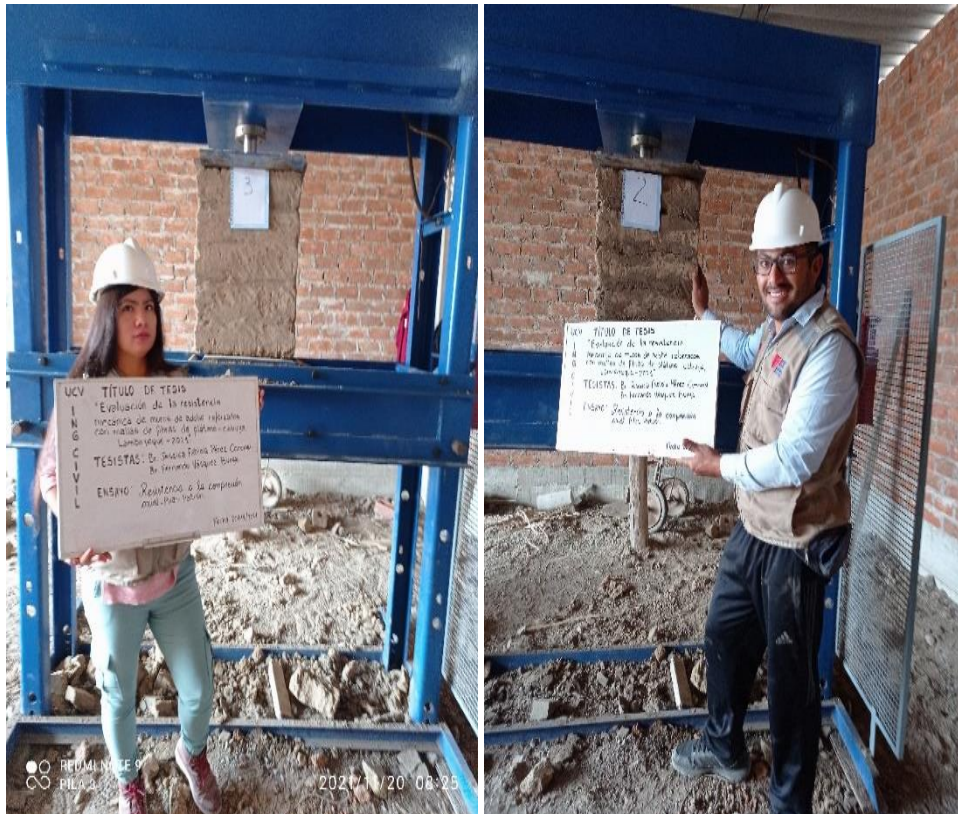
Ensayos de compresión en pilas patrón Fuente: Elaboración propia
