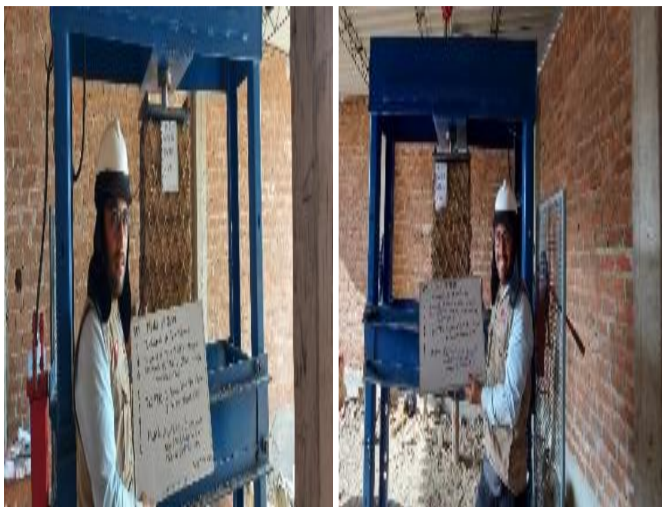
Ensayo de compresión axial - pilas con malla de plátano 5 cm Fuente: Elaboración propia
