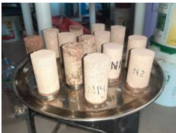
Figura 37. Probetas en contacto con agua en la base de 1 mm
