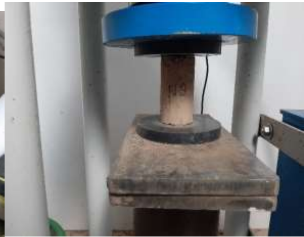
Figura 32. Compresión inconfiada, que tendrá relación con la cohesión.
