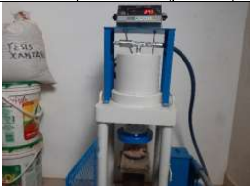
Fotografía 31. Rotura de probeta N13 (pollo 6%)
