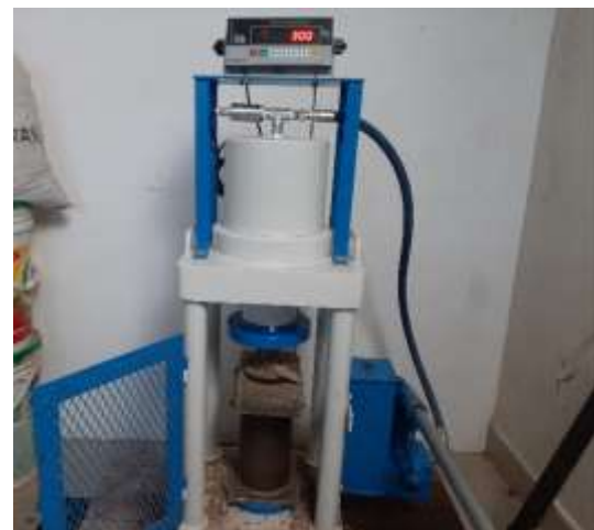
Figura 35. Compresión simple de la muestra con sangre de res al 6%.
