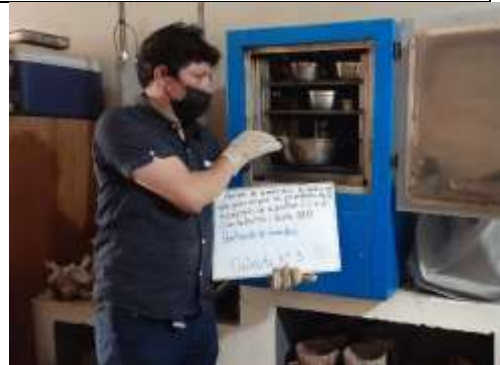
Fotografía 36. Secado al horno para determinar el C.O.H.
