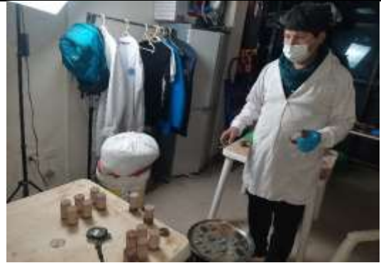
Fotografía 20. Medición de la ascensión capilar con vernier.
