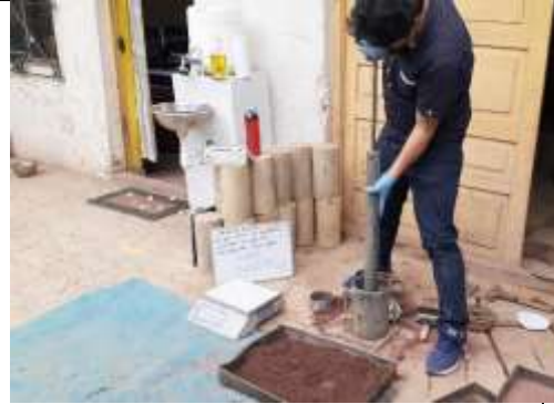
Fotografía 34. Compactación del suelo natural, 5ta capa.
