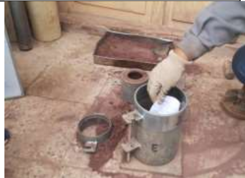
Fotografía 38. Agregado de papel filtro en la base del molde
