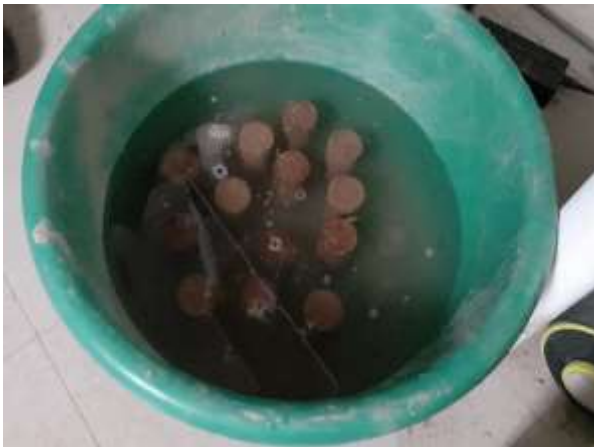
Figura 31. Probetas sumergidas en agua durante 24 horas para luego ser secadas en el horno
