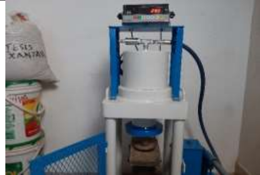
Fotografía 26. Rotura de probeta N7 (res 6%)
