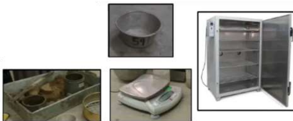
Figura 3. Materiales para el ensayo de contenido de humedad Fuente: MTC E 108-2016
