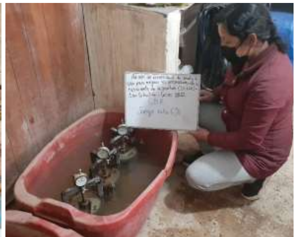
Figura 41. Moldes 6" sumergidas en agua con el dial por 96 horas.
