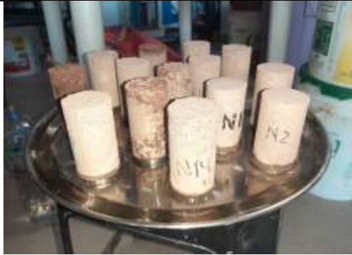
Fotografía 19. Probetas sobre 1 mm de agua para obs. capilaridad.
