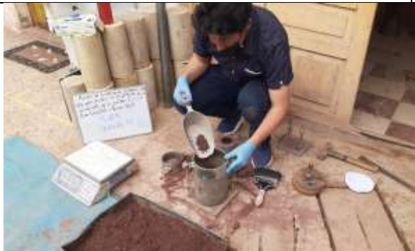
Fotografía 39. Agregado de agua de acuerdo al C.O.H. para el CBR.
