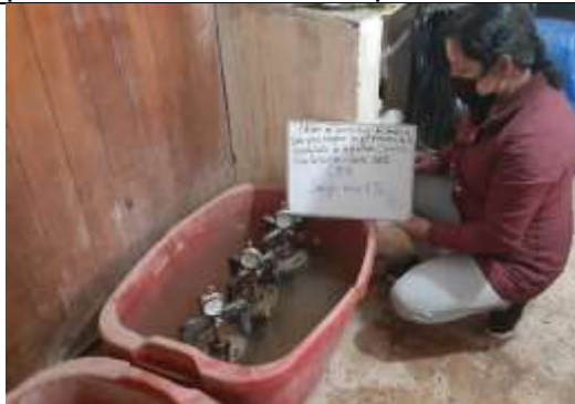
Fotografía 47. Moldes de CBR con sangre de pollo al 6% sumergidas
