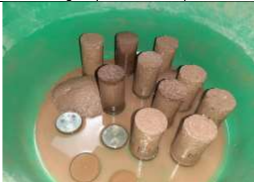
Fotografía 21. Probetas sumergidas en agua 24 horas.
