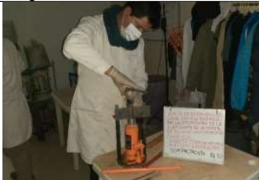
Fotografía 15. Compactación de muestra.
