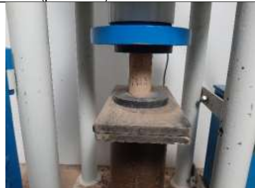
Fotografía 32. Rotura de probeta N13 (pollo 6%)
