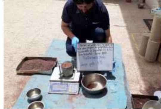
Fotografía 42. Pesado del molde con sangre de pollo al 6%-proct. mod.
