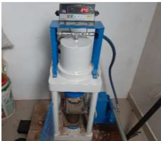
Figura 34. Compresión simple de la muestra con sangre de pollo al 6%.
