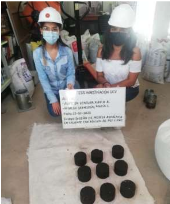
Desmolde de las briquetas con PET
