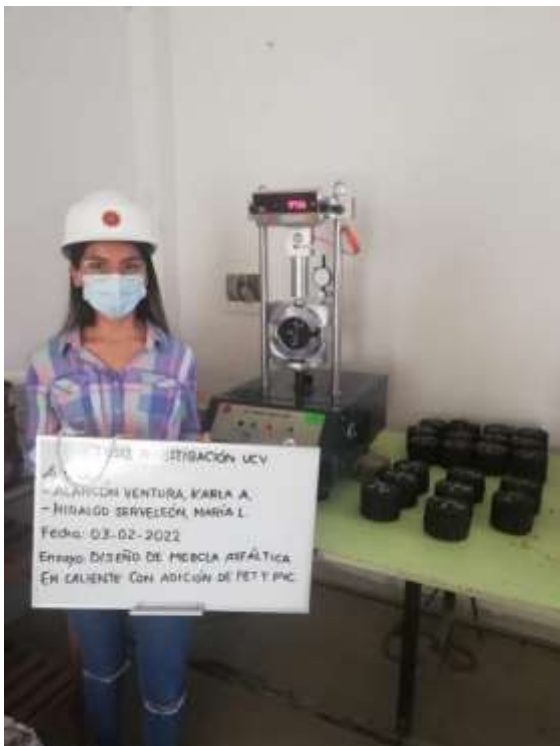
Ensayo Marshall con 3% de PVC
