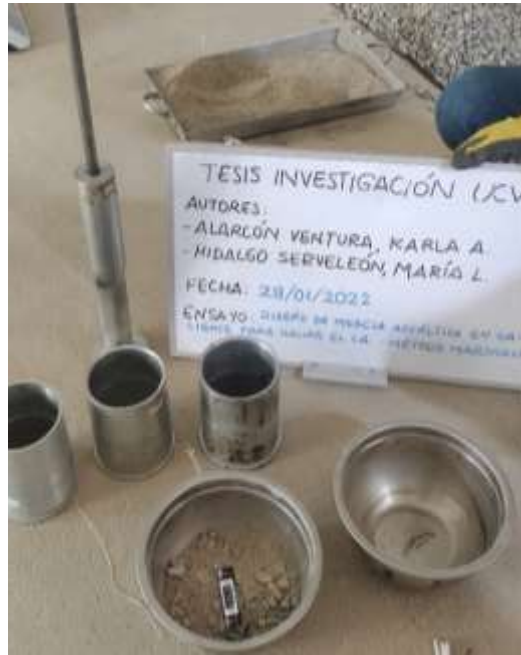
Verificación de la T° del agregado
