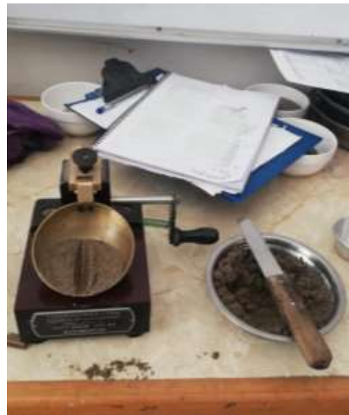
Figura 24: Cierre de la ranura después del giro del equipo.
