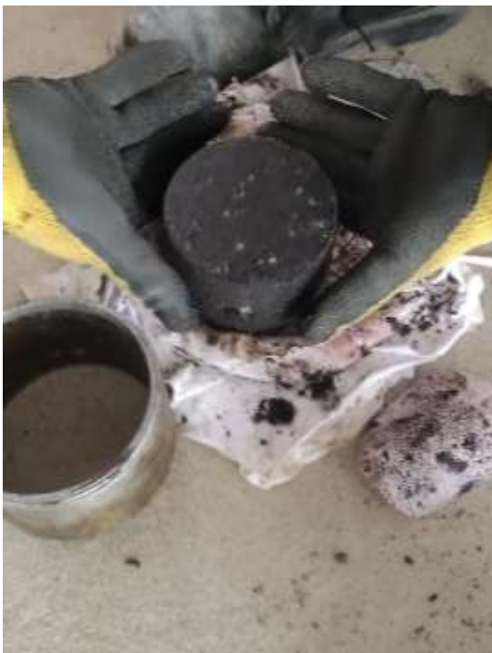
Figura 51: Desmolde de la briqueta Fuente: Elaboración propia
