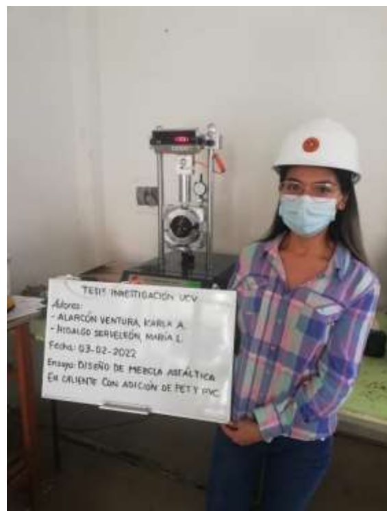
Ensayo Marshall con 5% de PVC
