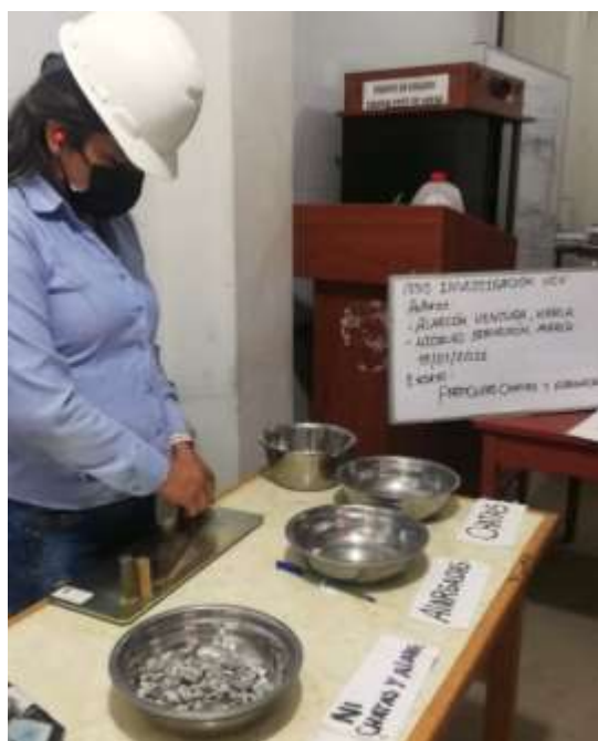
Figura 15: Ensayo de partículas chatas Fuente: Elaboración propia
