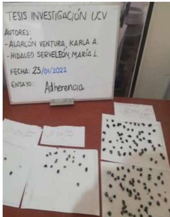
Evaluación del % de asfalto pegado
