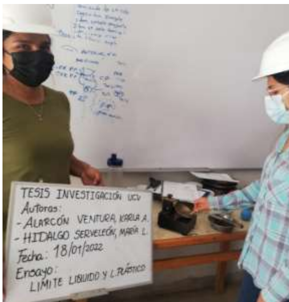
Figura 23: Realización de la ranura con el acanalador en el equipo Casagrande.
