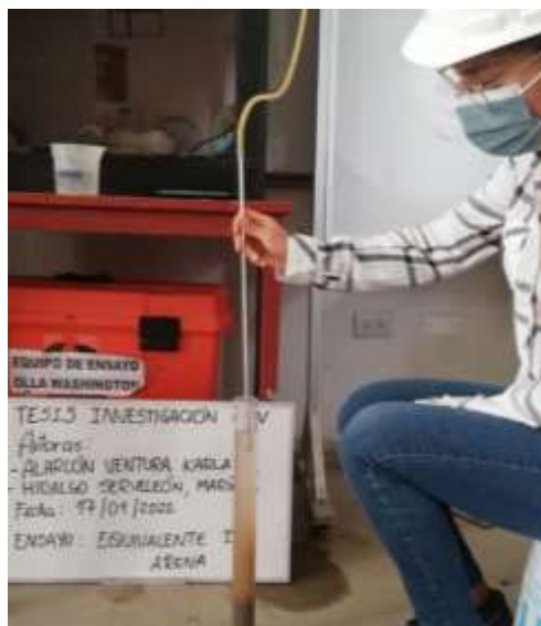
Figura 21: Llenado del tubo con el solvente limpiador preparado.
