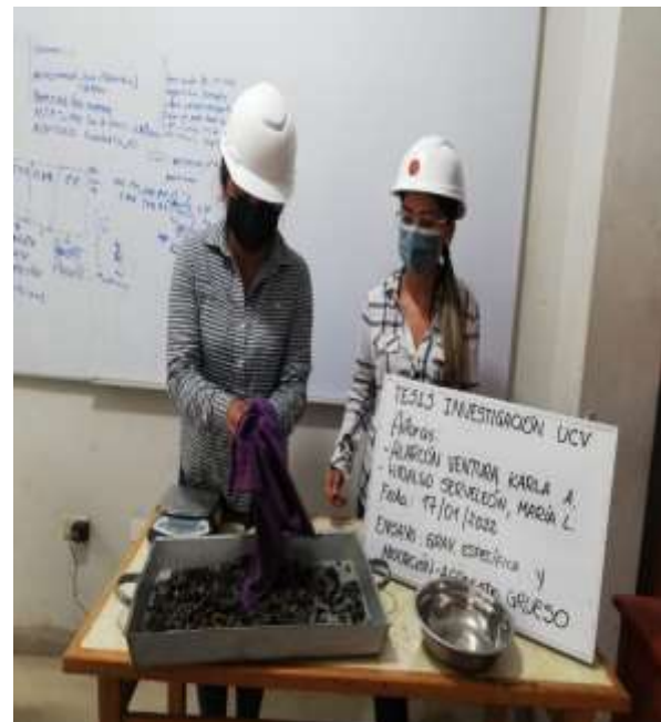
Secado del agregado grueso
