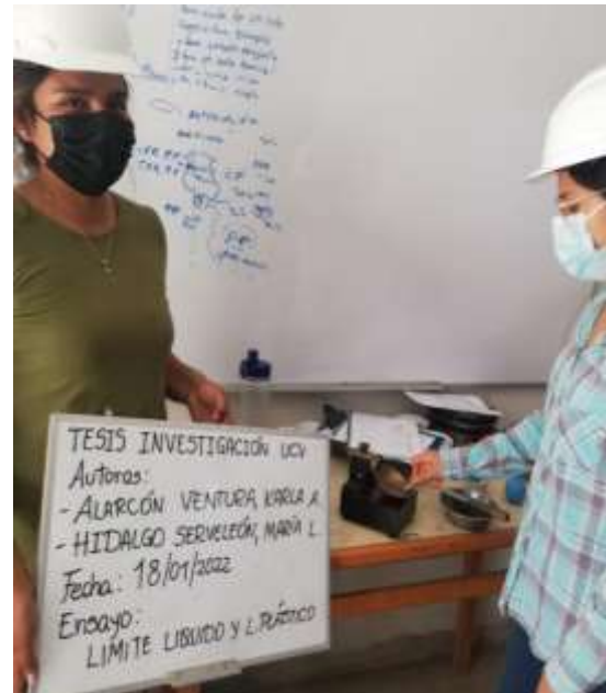
Colocación del agregado en Casagrande
