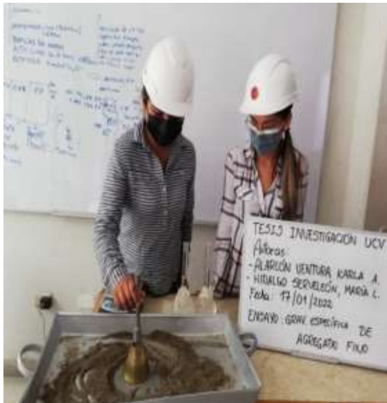
Apisonado del material en el cono
