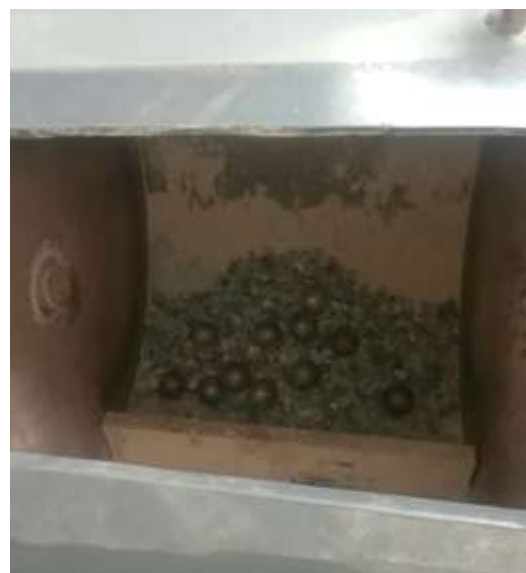
Figura 12: Colocación de la muestra en la Máquina Los Angeles
