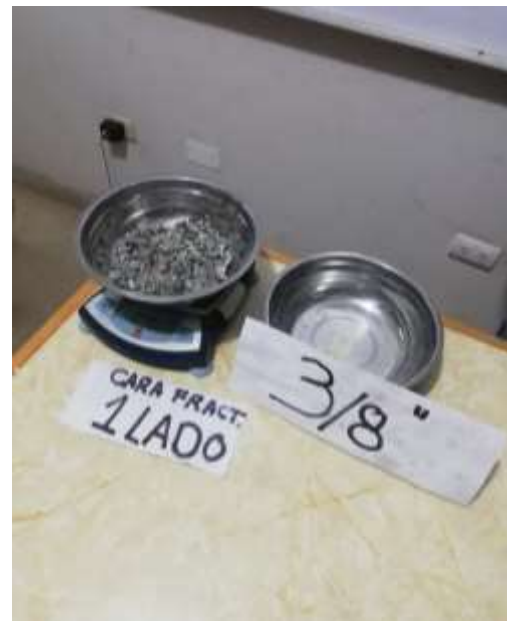
Figura 18: Clasificación de las partículas en caras fracturadas de 1 lado.
