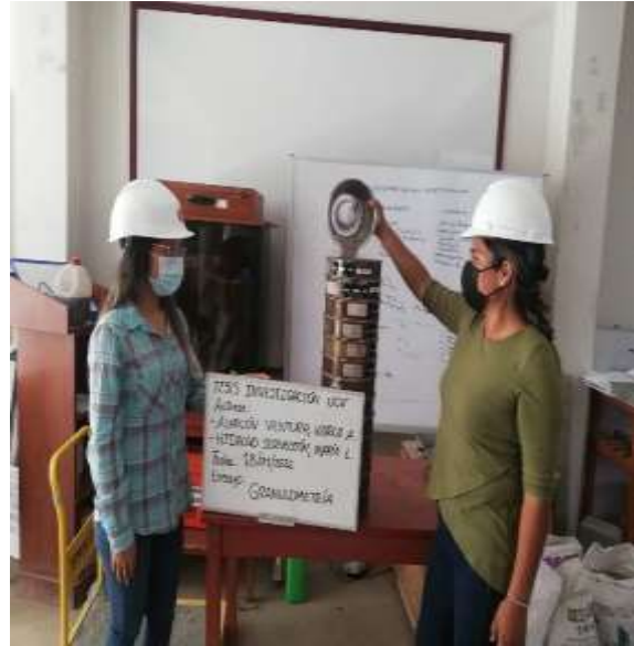
Vertido del agregado en las mallas
