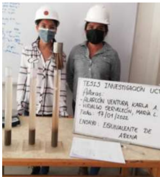
Figura 22: Lectura de arcilla de los cilindros irrigados.
