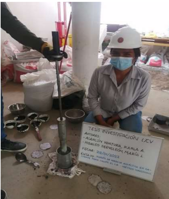
Compactación de 75 golpes por cara
