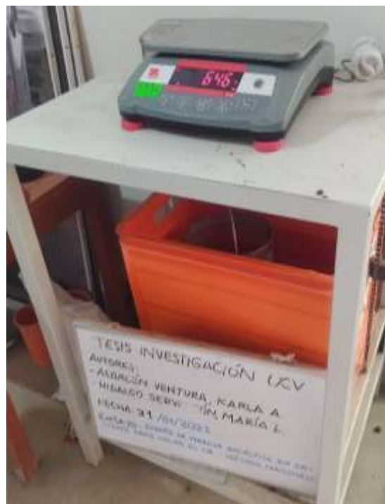
Peso de la briqueta sumergida
