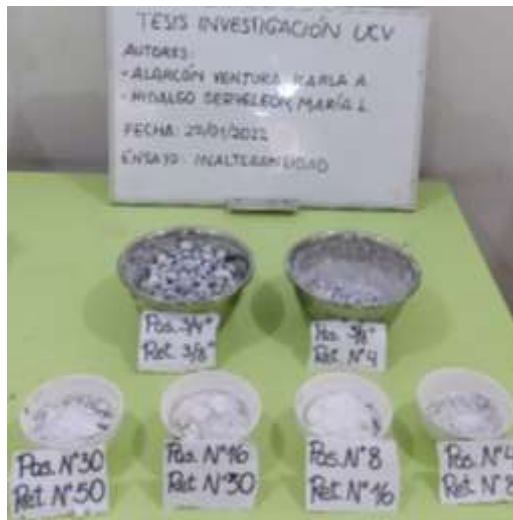
Figura 26: Secado de los agregados luego de la inmersión.
