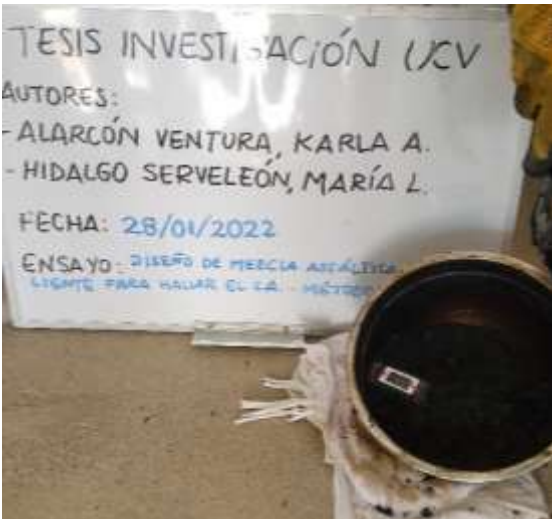
Figura 7: Medición de la T° del agregado Fuente: Elaboración propia
