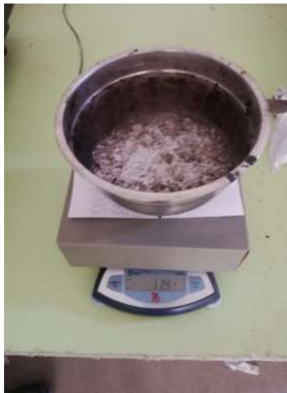
Mezcla de los agregados con el PET
