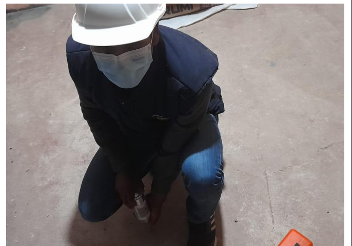
Ensayo de esclerómetro en losa de la vivienda 01.
