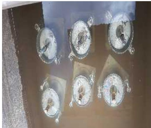
**Figura N°52:** Muestras Sumergidas por 4d.
