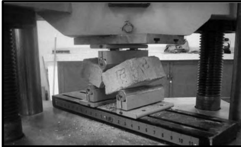
Figura 4. Ensayo de flexión
