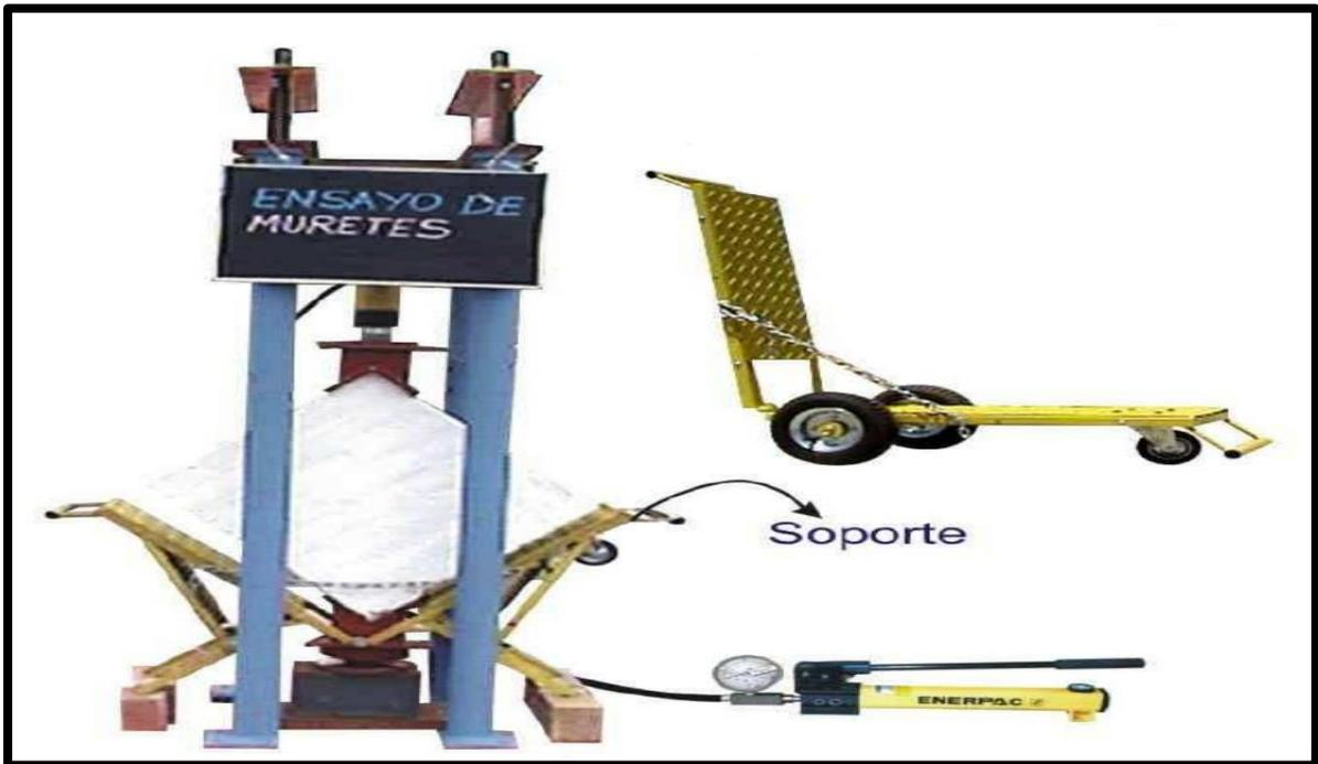
Figura 3. Ensayo de Muretes
