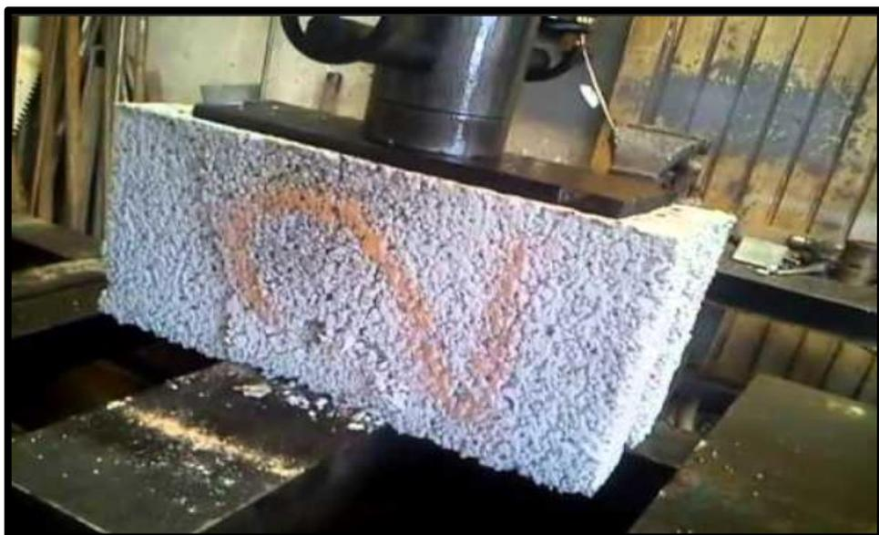
*Figura 1. Ensayo a la compresión*
