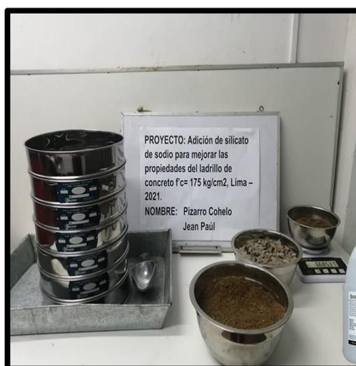
*Figura 10.* Materiales utilizados para el Análisis granulométrico
