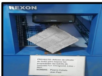
Figura 18. Ensayo a resistencia diagonal en muretes
