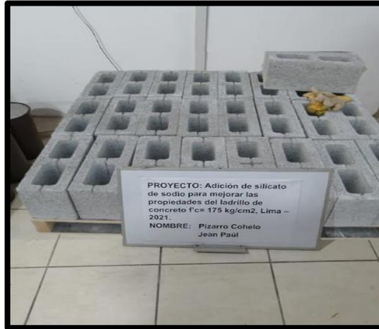
Figura 14. Unidades de ladrillos en muestra patrón y con 1%, 1.5% y 2% de Silicato de Sodio
