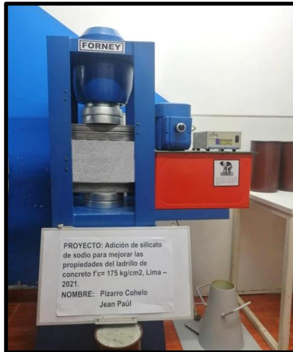
Figura 16. Ensayo a compresión de la unidad del ladrillo
