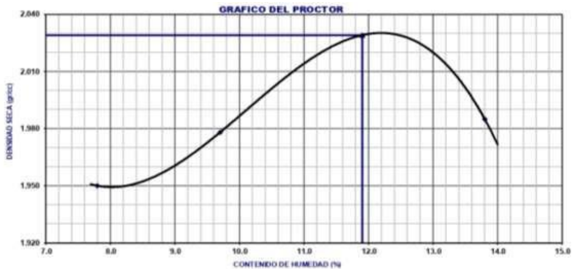
Grafico 2. Proctor de la Muestra N°02 suelo Patron Tuma
