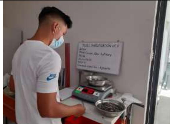
Foto 2: Calculando la gravedad específica del agregado grueso.
