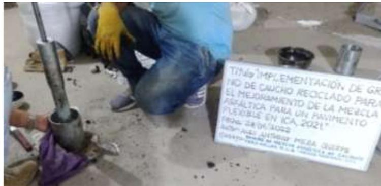
Figura 26. 75 impactos para cada cara del molde según norma
