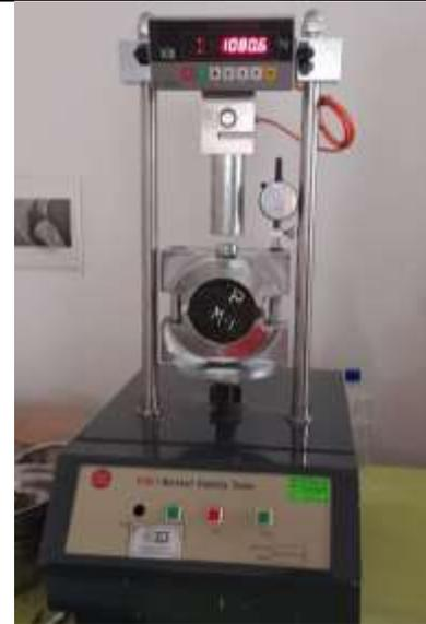
Foto 22: Se somete a una carga constante hasta producir la falla. Obteniendo los resultados de Estabilidad (carga máxima) y flujo (deformación de la carga máxima)
