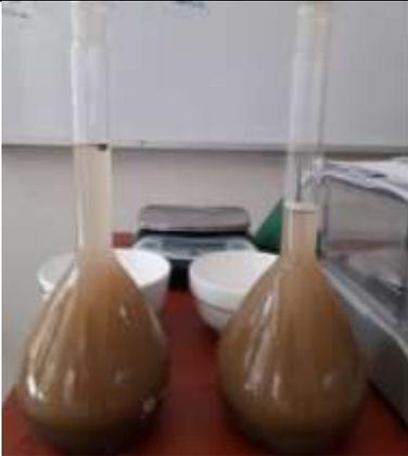
Foto 1: Calculando la gravedad específica del agregado fino con las fiolas.
