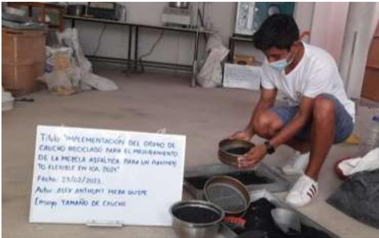
*Figura 10.* Separando el porcentaje granulométrico del caucho.
