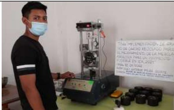
Foto15: Ensayo Marshall con las 12 briquetas para hallar el óptimo contenido de CA.
