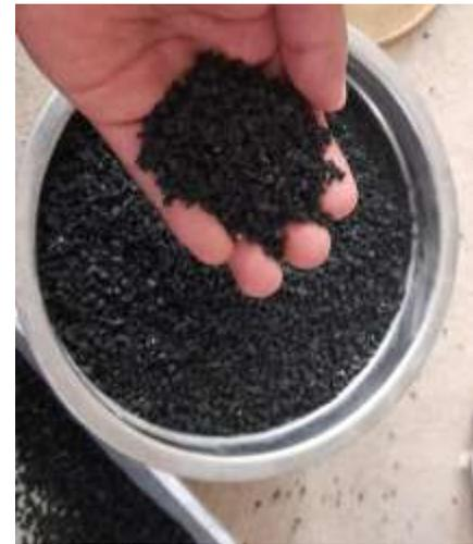
*Figura 11.* Incorporación del grano de caucho al agregado
