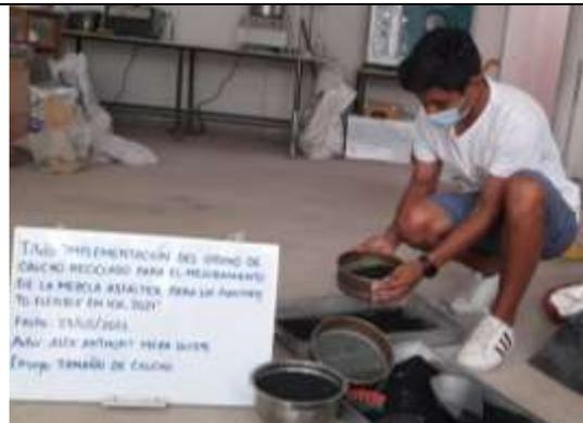
Foto 16: Separación de los granos de caucho utilizando la tamiz malla N°10-2mm.
