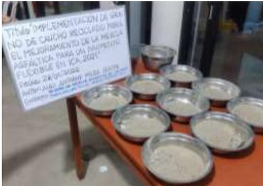
Foto 7: Mezcla de los agregados para la elaboración de las briquetas.
