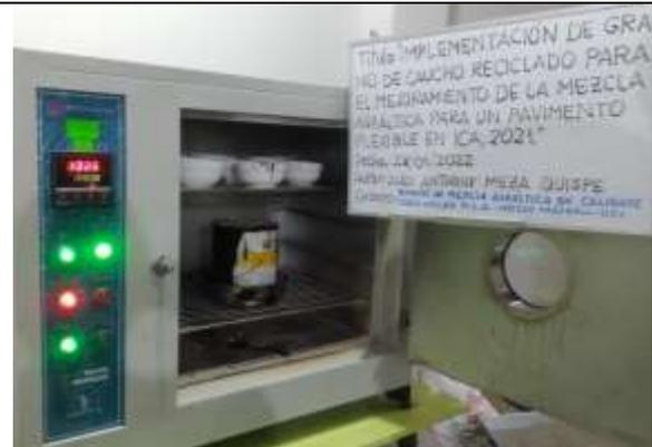
Foto 8: Se calienta el Cemento asfáltico en el horno a una temperatura de 140°C.
