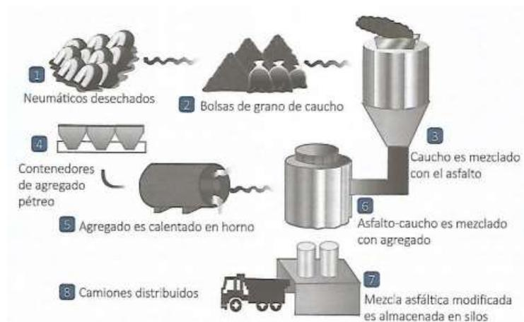
**Figura 2.** Proceso de fabricación del asfalto-caucho (vía húmeda)
