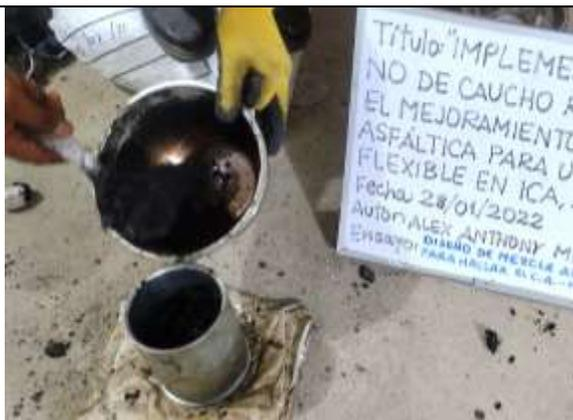
Foto 11: La mezcla asfáltica es colocada en el molde de la biqueta.
