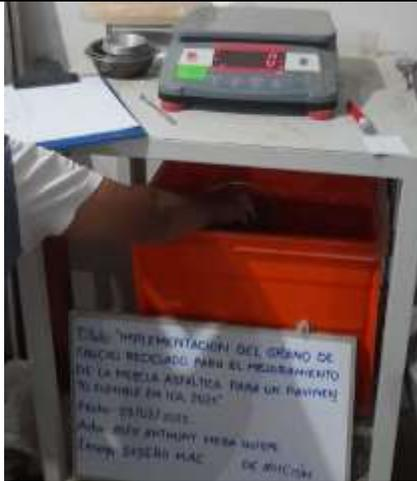
Foto 19: Se determina su densidad de la briqueta por medio de su masa, pesada al aire en condición seca, saturada superficialmente seca y sumergida en agua.
