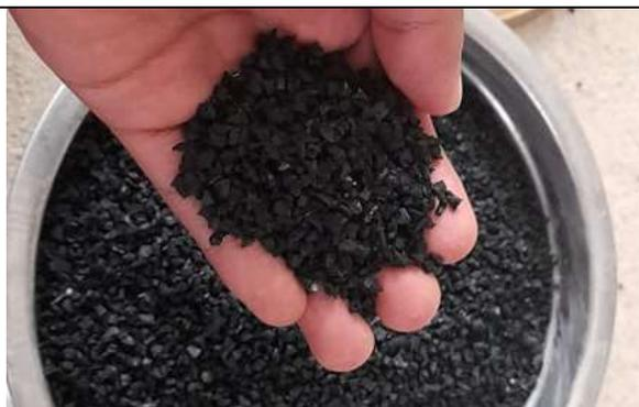
Foto 17: Incorporación de grano de caucho a la mezcla asfáltica.
