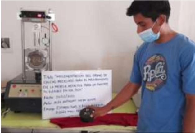
*Figura 19.* Briqueta en el aparato Marshall
