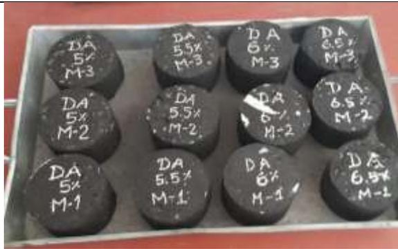
Foto 13: Elaboración de las primeras 12 briquetas para obtener la cantidad optima de CA.
