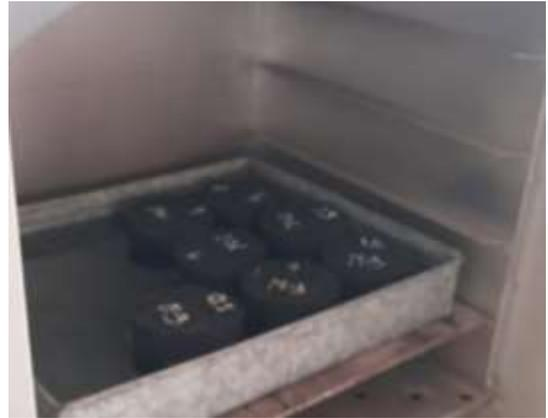
Foto 20: Las briquetas se sumergen en un baño de agua, manteniendo una temperatura de  $60 \pm 1^\circ\text{C}$ .
