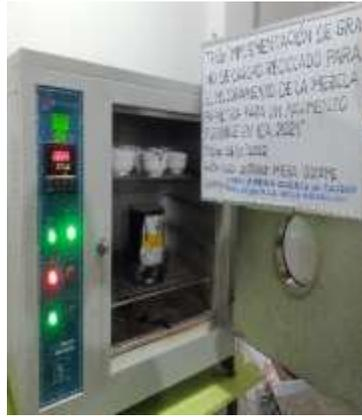
Figura 7. Cemento Asfáltico a 170 °C
