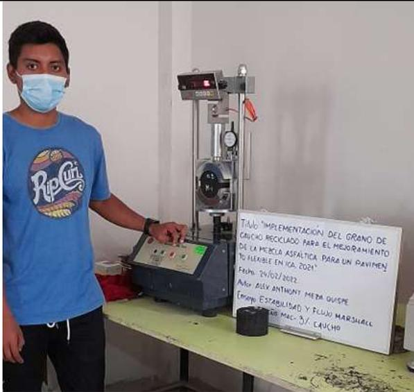
Foto 21: Las briquetas son extraídas del baño de agua y secadas superficialmente para realizar el ensayo Marshall.
