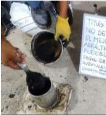
Figura 25. Mezcla del C.A. con los agregados en caliente.
