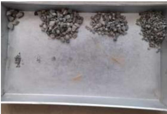
Foto 5: Separación de los agregados gruesos por granulometría.
