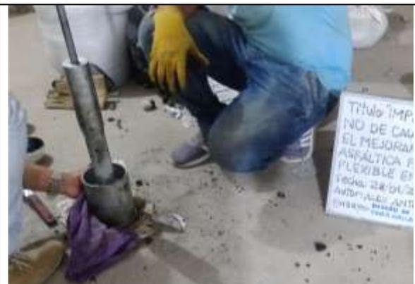
Foto 12: Se somete a los 75 golpes por cada cara según la norma ASTM D4123-82.
