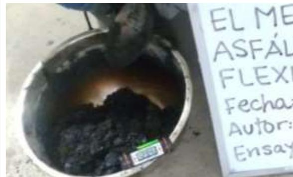
Foto 10: La mezcla asfáltica se encuentra a una temperatura de 123.4°C.
