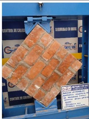
Figura 05. Falla en ensayo de compresión diagonal.
