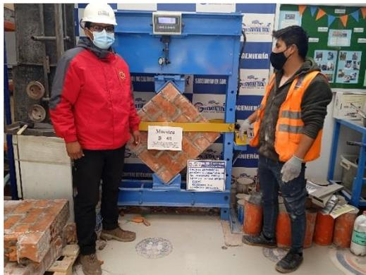
Figura 03. Unidades de albañilería seleccionados para ensayos
