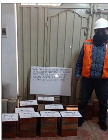
**Figura 34.** Elaboración de pilas
