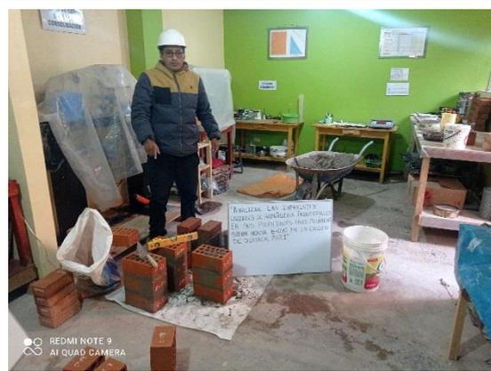
Figura 07. Elaboración de pilas para ensayos de f'm.
