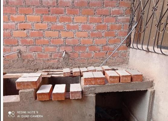
Figura 02. Refrendados de ladrillos para compresión axial.
