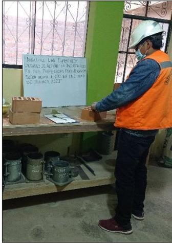
Figura 22. Ensayo de densidad
