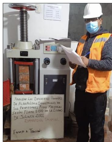
**Figura 35.** Rotura de pilas muestra M-B
