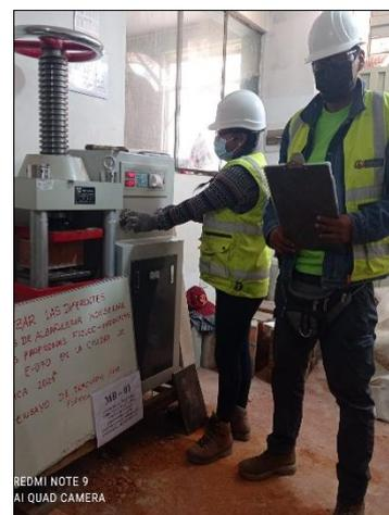
Figura 40. Ensayo de tracción por flexión M-B
