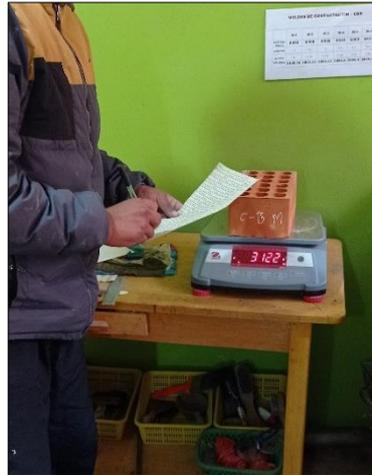
Figura 23. Ensayo de absorción
