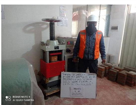
Figura 13. Ensayo de compresión axial en unidades de albañilería.
