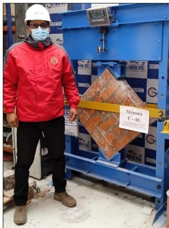
*Figura 43.* Rotura de murete muestra M-C
