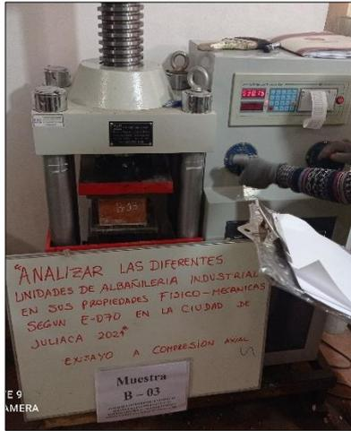
Figura 30. Ensayo a compresión axial M-D
