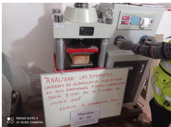
Figura 18. Ensayo de compresión axial en pilas.
