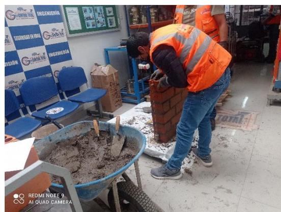
Figura 09. Elaboración de muretes para ensayo de compresión diagonal.
