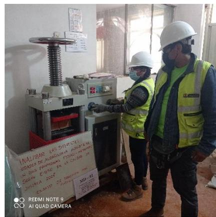
Figura 16. Rotura de testigo en ensayo de tracción por flexión.
