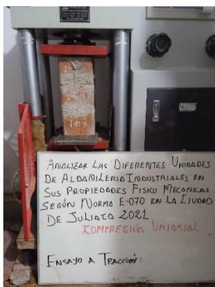
Figura 17. Ensayo de compresión uniaxial.
