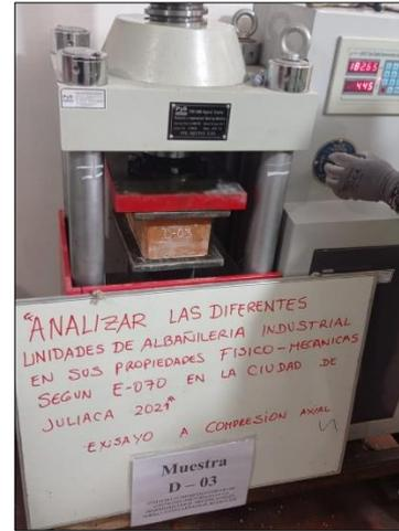
Figura 32. Ensayo a compresión axial M-B
