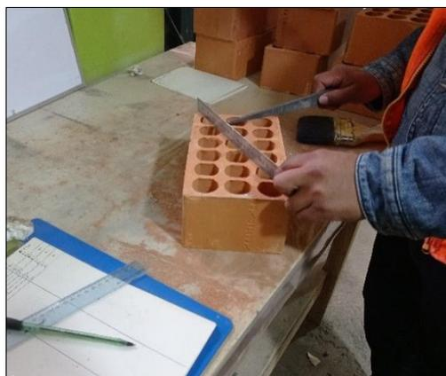
*Figura 21.* Ensayo de alabeo
