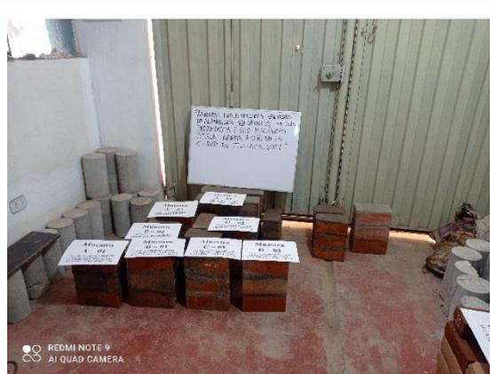
Figura 14. Muestras para ensayo de compresión uniaxial.
