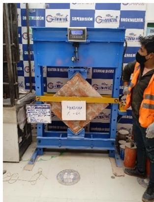
Figura 11. Ensayos de compresión diagonal en muretes
