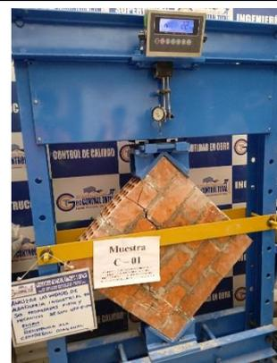
Figura 06. Falla en ensayo de compresión diagonal
