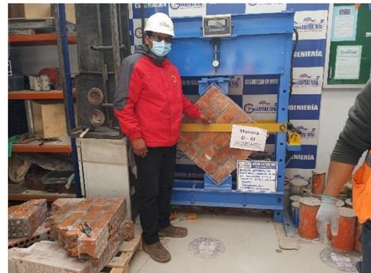
Figura 04. Unidades de albañilería seleccionados para ensayos
