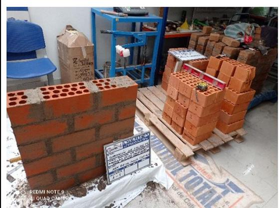
Figura 10. Muretes ya elaborados para ensayos de compresión diagonal.
