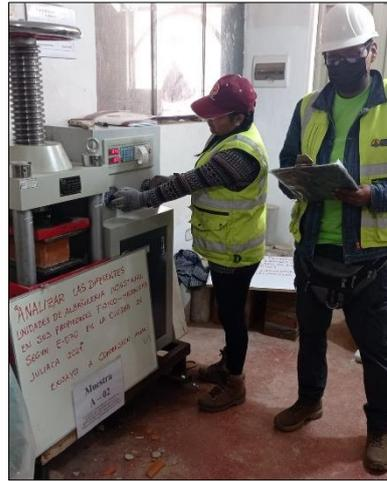
Figura 31. Ensayo a compresión axial M-B
