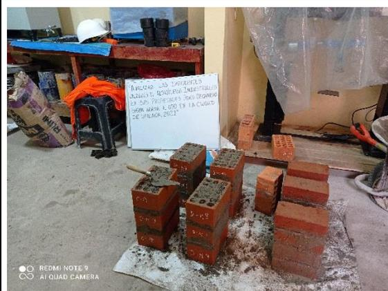
Figura 08. Elaboración de pilas para ensayos f'm.
