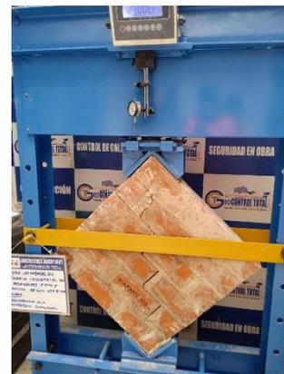
Figura 12. Falla en ensayo de compresión diagonal.
