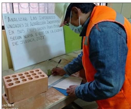
*Figura 20.* Ensayo de variación dimensional
