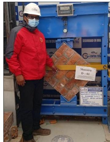
*Figura 44.* Rotura de murete muestra M-D
