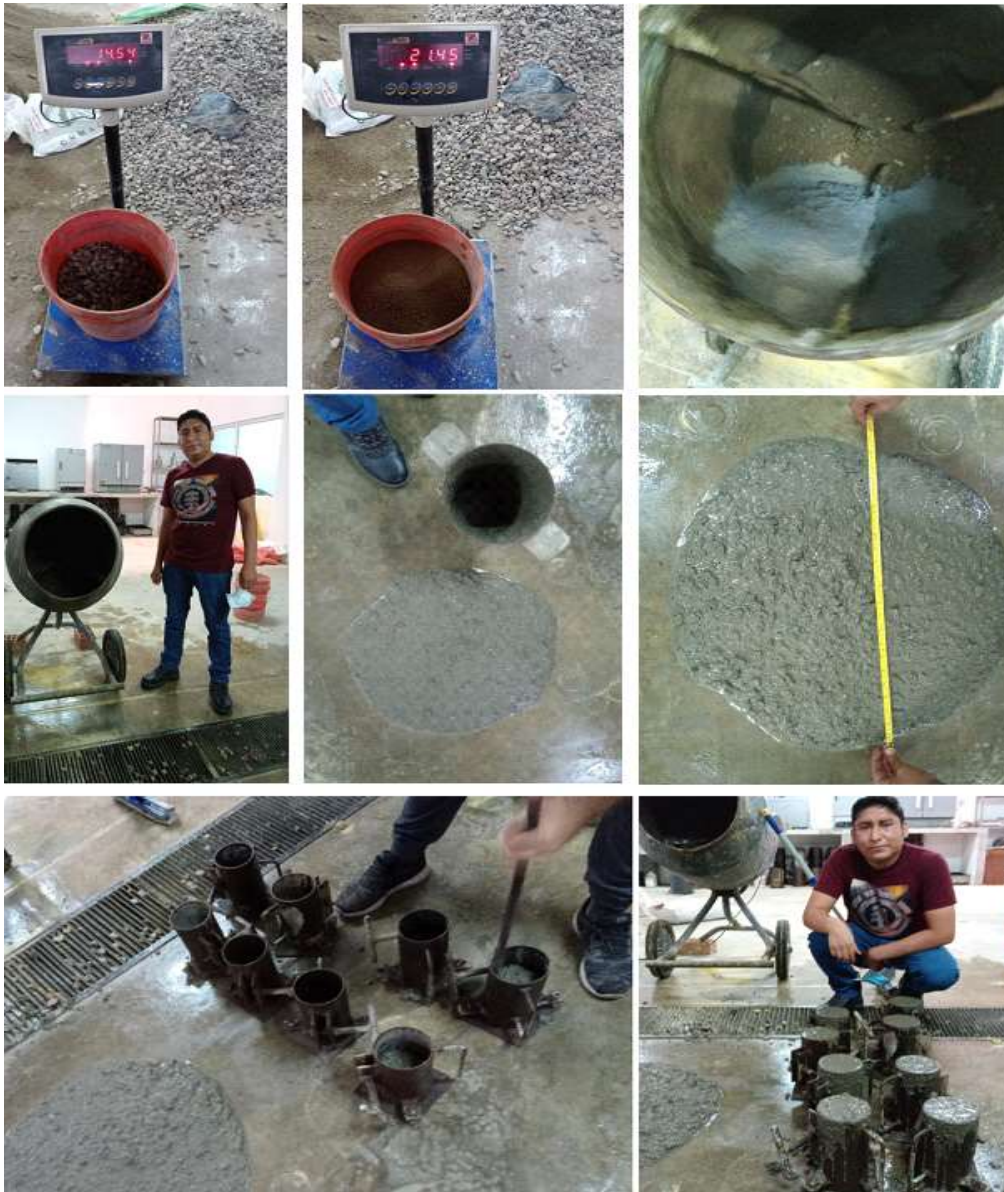
Figura 17. Diseño de la mezcla concreto de 280 kg/cm 2 .
