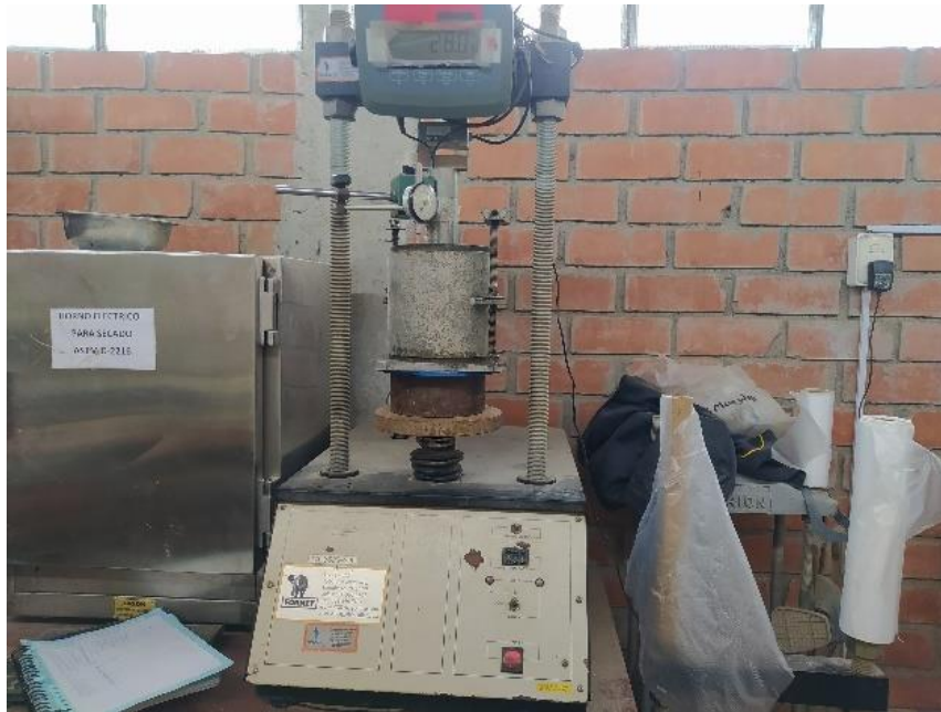
Figura 17: Ensayo de penetración
