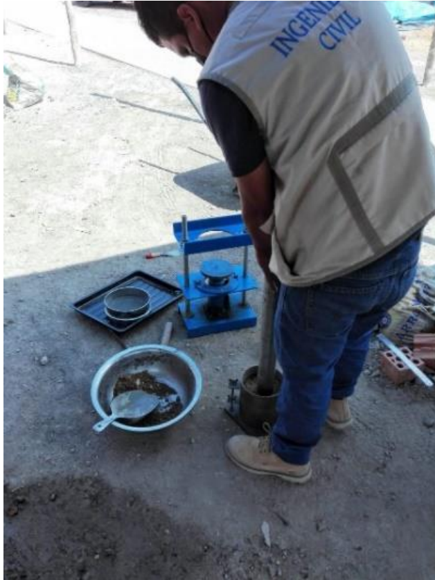
Figura 13: Ensayo Proctor modificado Fuente: Elaboración propia.
