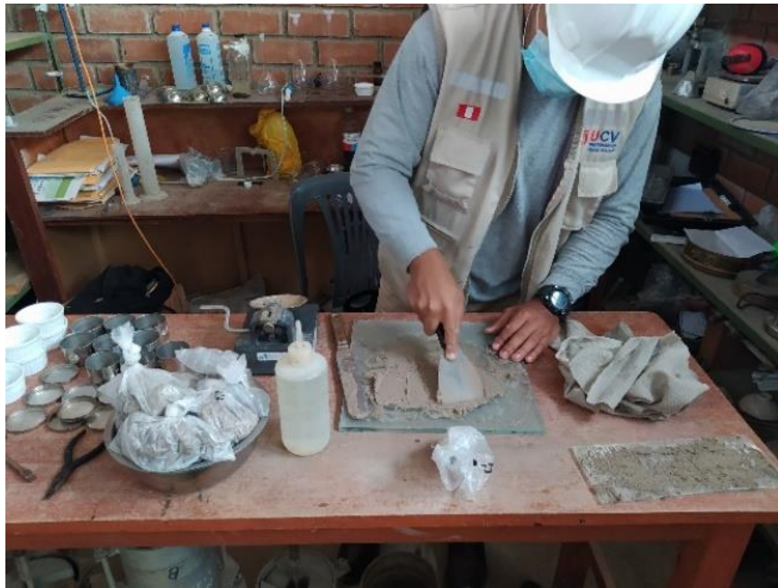
Figura 11: Ensayo limite liquido Fuente: Elaboración propia.
