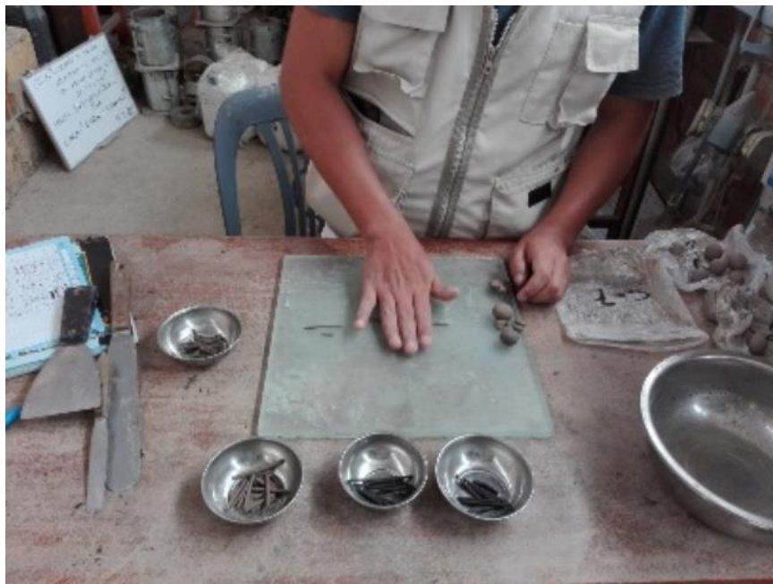
Figura 12: Ensayo limite plástico Fuente: Elaboración propia.
