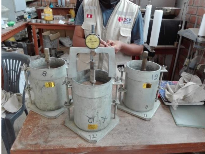
Figura 15: Calibración de medidor de expansión Fuente: Elaboración propia.
