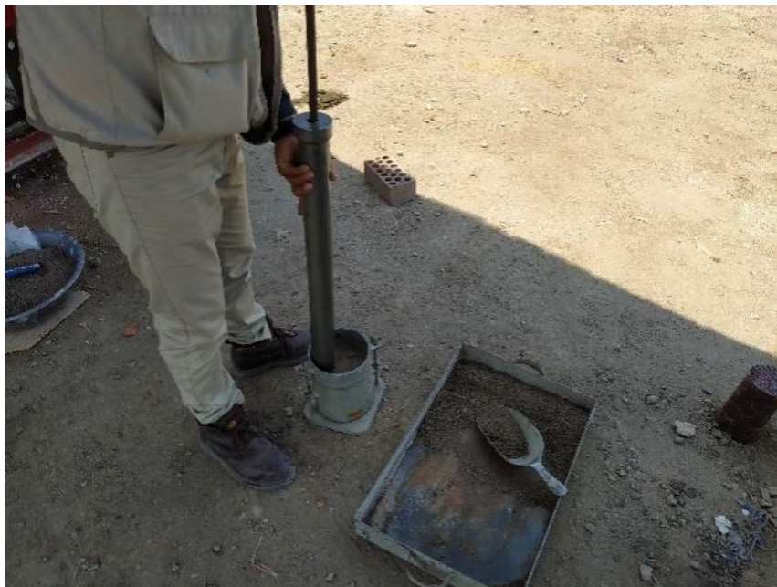
Figura 14: Ensayo CBR Fuente: Elaboración propia.
