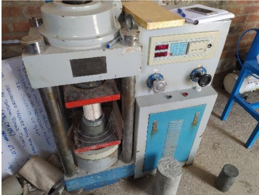
Figura 19: Ensayo rotura de probetas 175 kg/cm 2 y 210 kg/cm 2 Fuente: Elaboración propia.
