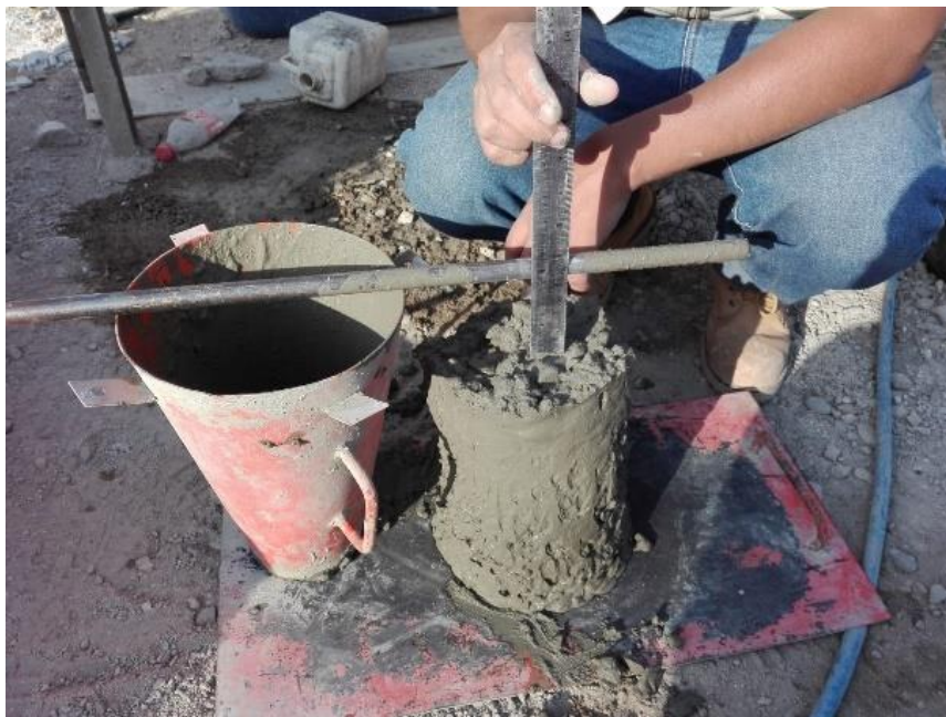
Figura 18: Ensayo de revenimiento
