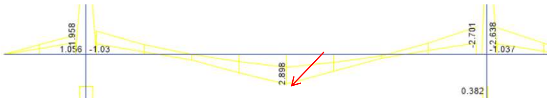
Figura 39: Acero E, Envolvente de momento flector en la viga W12x26
