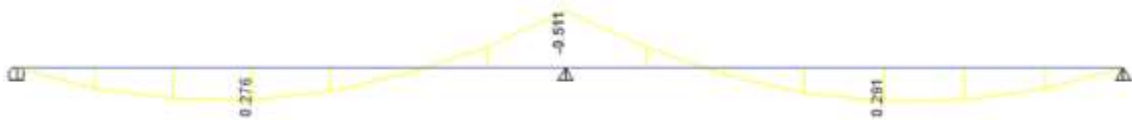
Figura 1: Propuesta de Concreto Armado, momento flector en viga para COMB= 1.4D + 1.7L, M_u(+) = 0.29 Tn.m, M_u(-) = -0.43 Tn.m
