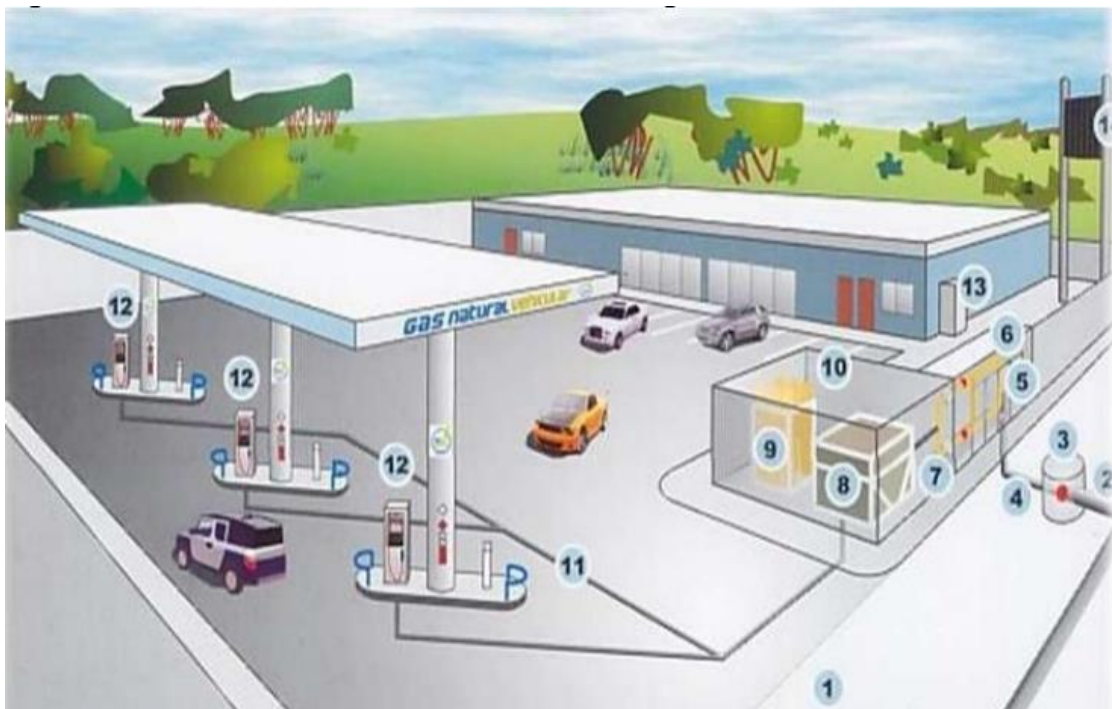
Figura 5. Componentes principales de una estación de servicios
