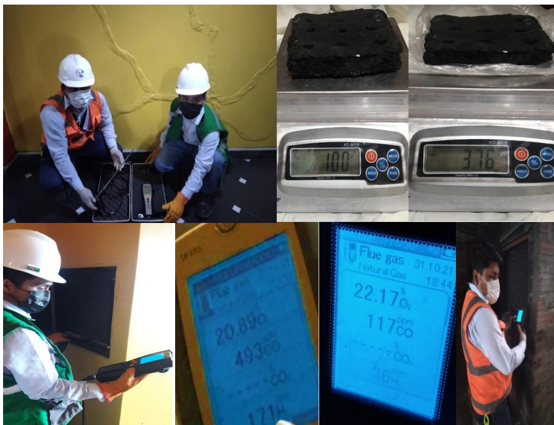
Figura 20: Testo 340 y medición de CO en campo.
