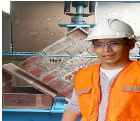
Figura 28: Resistencia de compresión diagonal
