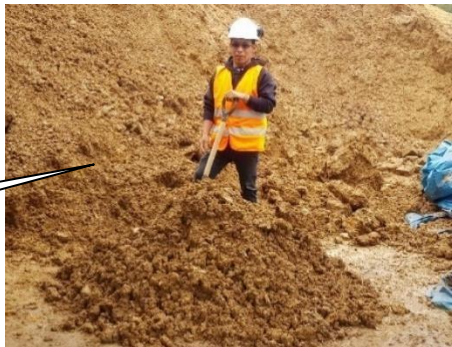
Picado de la arcilla para la elaboración de ladrillo
