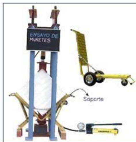
Figura 12: Ensayo de compresión diagonal
