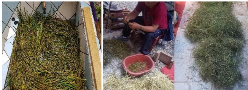
Figura 19:Tratamiento para extraer la fibra de retama
