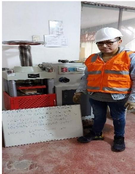
**Figura 7.** Compresión en pilas
