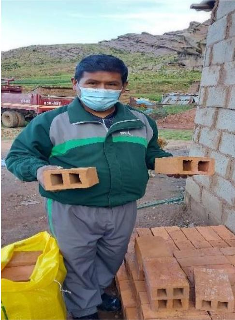
**Figura 20.** *Obtención de ladrillo pandereta para laboratorio*
