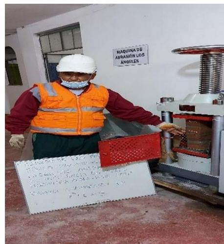
**Figura 29.** Ensayo en pilas king kong industrial
