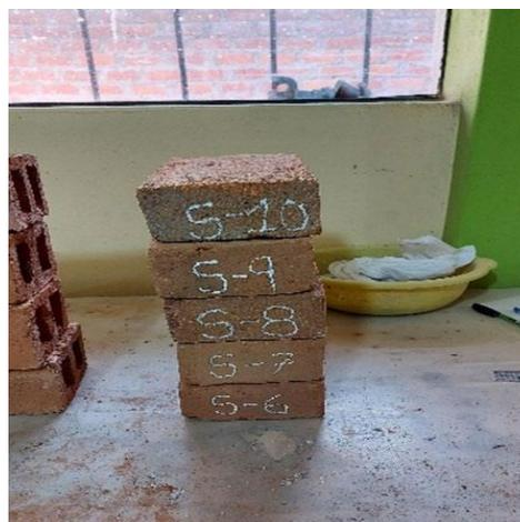
**Figura 21.** Dimensionamiento de ladrillos de arcilla cocida
