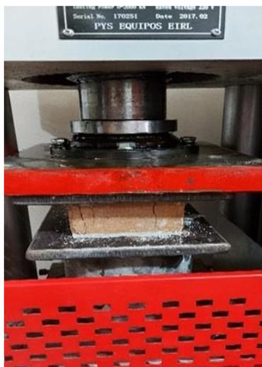
**Figura 27.** Compresión de unidades de albañilería
