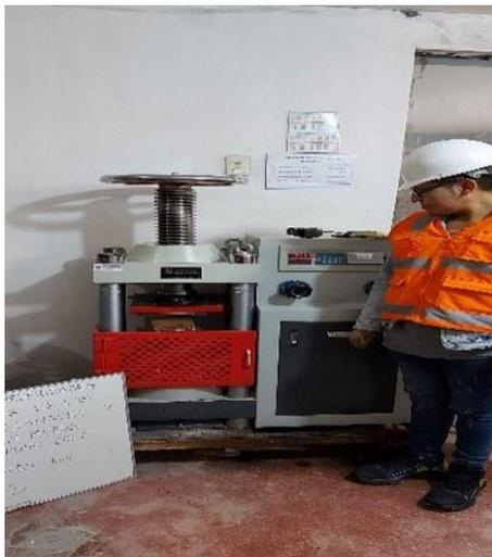
**Figura 28.** Ensayo a compresión en pilas king kong artesanal
