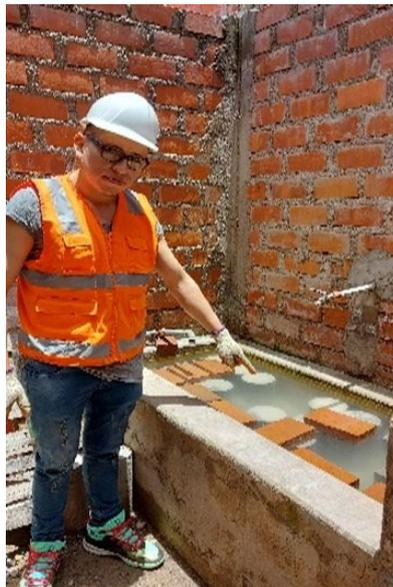
**Figura 24. Prueba de absorción del ladrillo**
