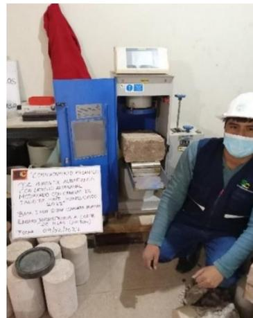
*Fig. 6 Ensayo de flexion*
