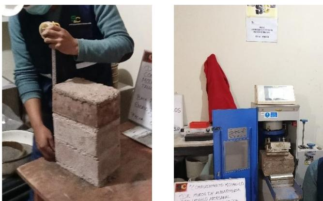
Figura 11. Pila de ladrillos para el ensayo de flexión por adherencia
