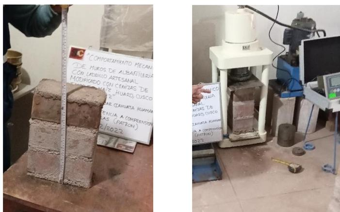
Figura 9. Pila de ladrillos para el ensayo de compresión uniaxial
