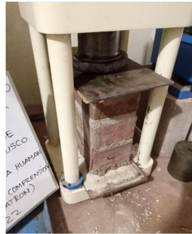
*Fig. 4 ensayo de compresion*
