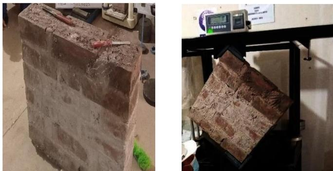
Figura 10. Prisma de ladrillos para el ensayo de compresión diagonal
