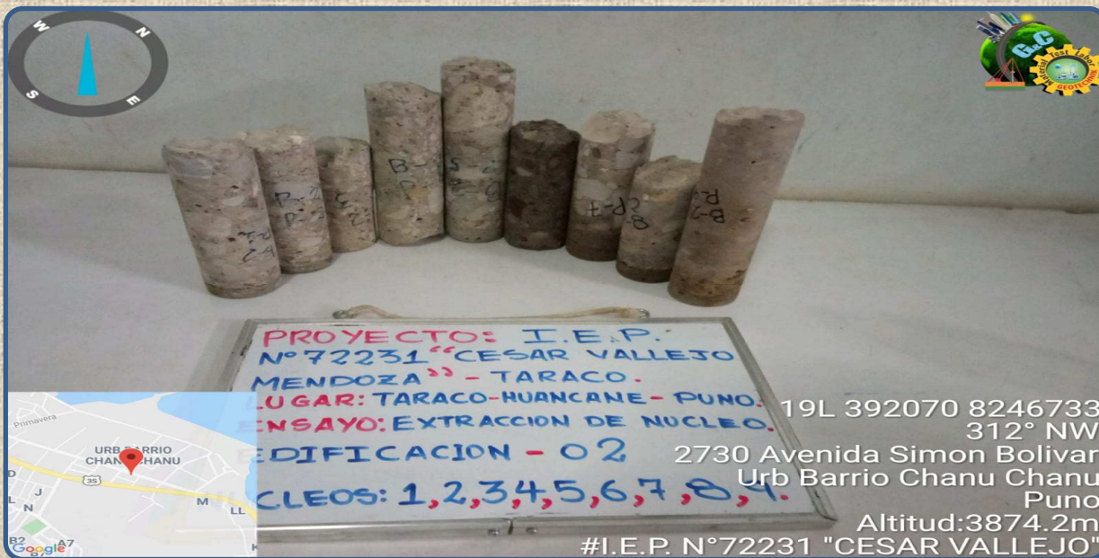
VISTA DE LA TOMA DE DIMENSIONES DE LOS NUCLEOS DE CONCRETO EXTRAIDOS DEL BLOQUE II
