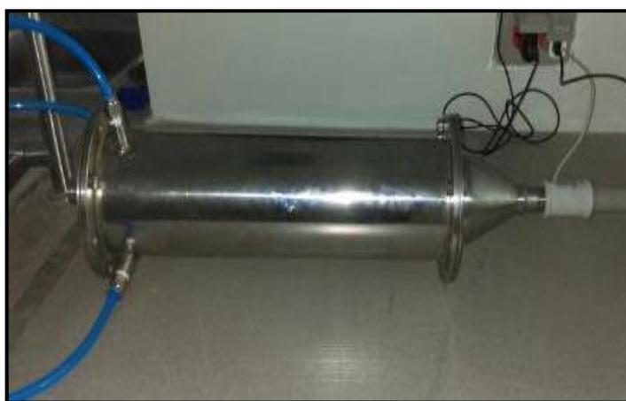
**Figura 2:** Dispositivo para generar micro-nanoburbujas
