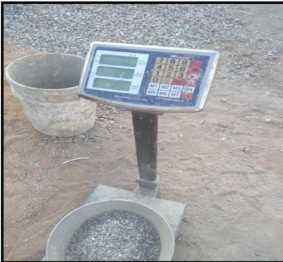
Figura 26. Utilización de balanzas calibradas para el tarado de los materiales
