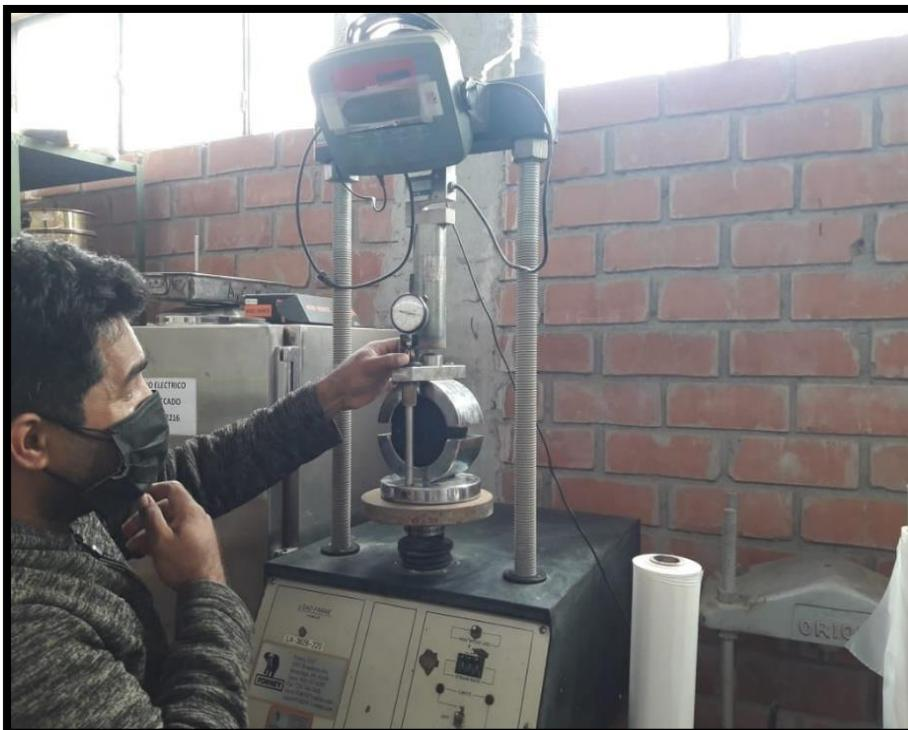
Figura 56. Presentación de la prensa de Marshall para determinar la estabilidad y flujo de las briquetas ensayadas.
