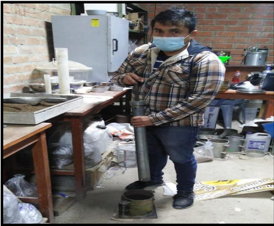
Figura 19. Compactación del material utilizando un pisón normado para el ensayo de CBR
