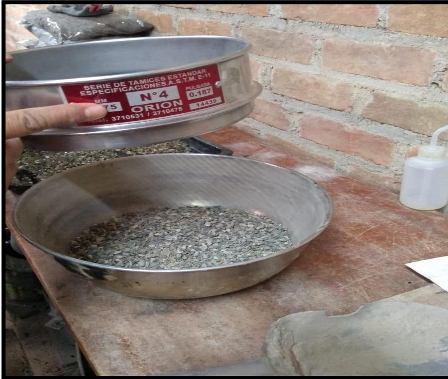
Figura 35. se toma el material que pasa por el tamiz numero 4 para este ensayo
