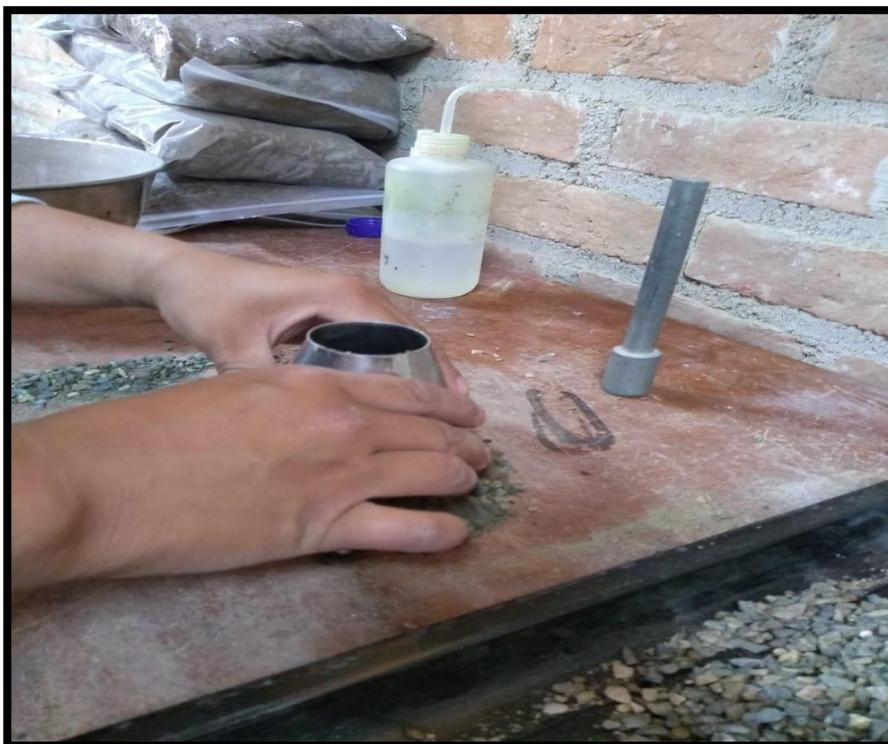
Figura 38. Se realiza a rellenar el cono con el material y se compacta con 15 golpes. Se procede a pesar 500 gramos de este material humedecido.
