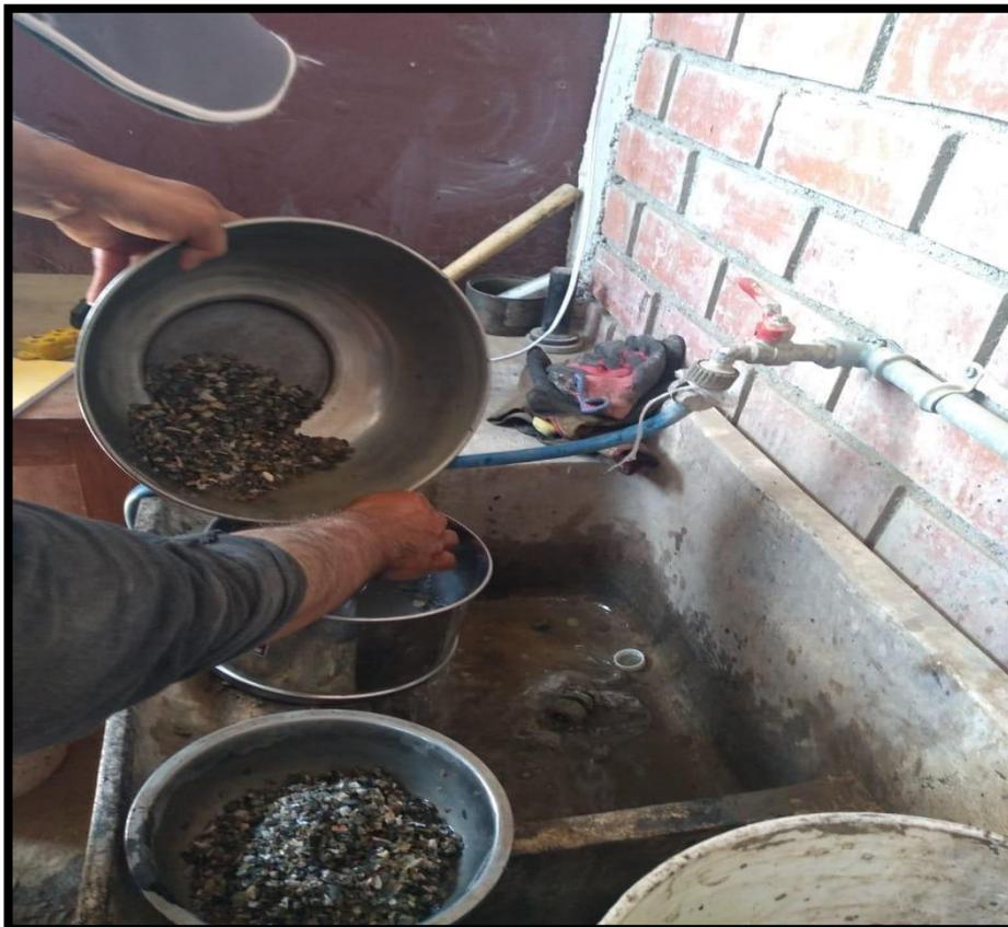
Figura 24. Lavado del material para eliminar impurezas que podrían alterar los resultados
