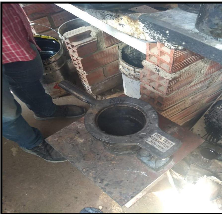
Figura 48. Preparación de la briqueta antes de colocar el material para el desarrollo del Marshall.
