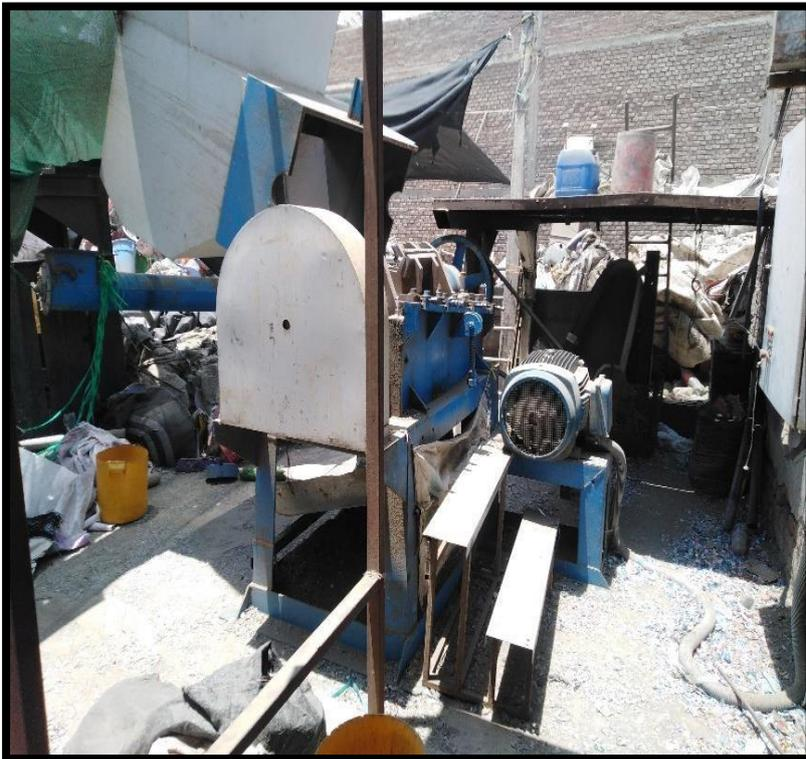
Figura 03. Se puede observar que es la maquina trituradora, la cual es una maquina convencional que se puede encontrar en el mercado como desgranadora de maíz, la cual es utilizado para cortar las botellas en su forma natural en tamaño más pequeñas en forma de escama
