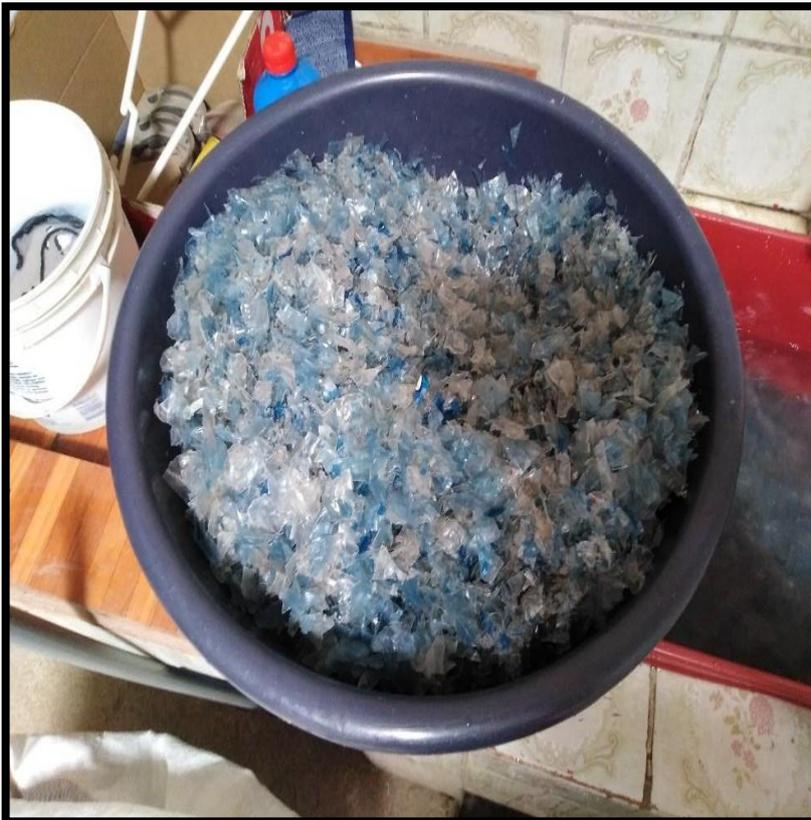
Figura 06. Se observa el material PET, lavado y se procederá al seco con temperatura ambiente
