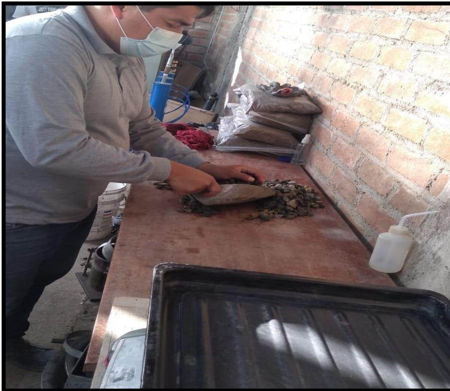
Figura 27. material a utilizarse para determinar el peso sumergido en agua para el ensayo de peso específico.
