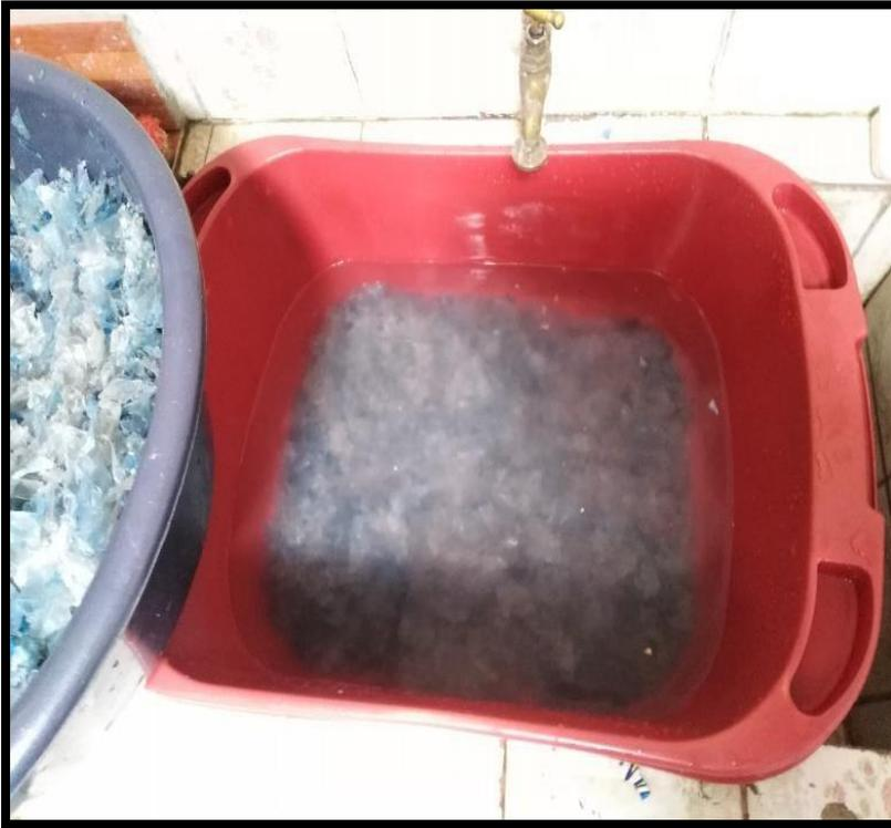
Figura 05. Al momento de abastecernos con 20 kilos de material PET, procedemos a realizar un lavado para eliminar impurezas que provienen de Tapas de las botellas y de las etiquetas.
