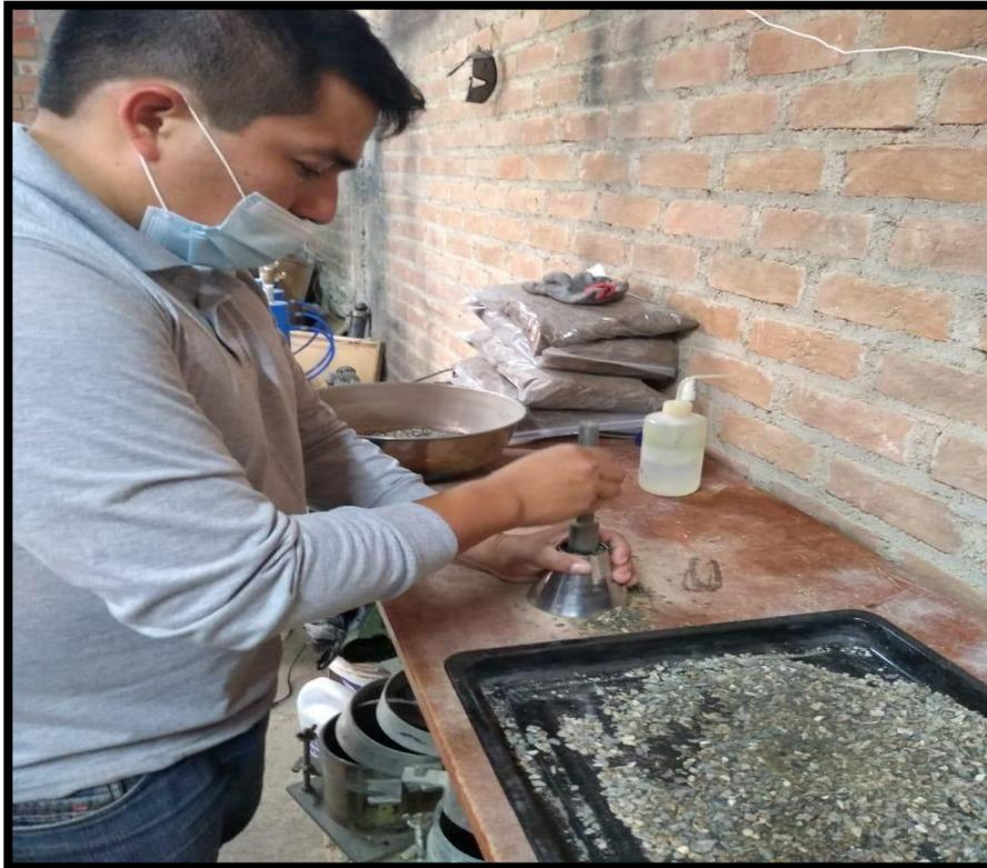
Figura 37. El confitillo una vez humedecido se procede a realizarse el ensayo con el cono para determinar el grado de humedad que tiene el agregado
