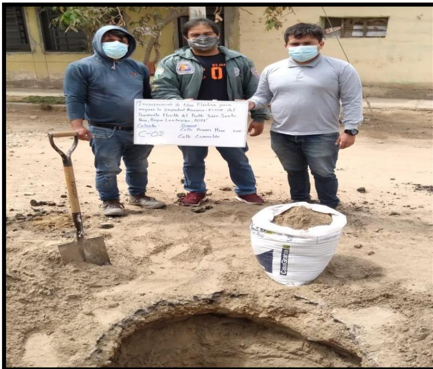
Figura 15. Se realizó a conocer el terreno del pueblo Joven Santa Rosa, para ello se realizó calicatas para visualizar los estratos del terreno y extraer muestras para su estudio en laboratorio.
