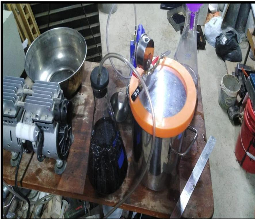
Figura 54. Presentación de los equipos para la realización del RICE. Para este ensayo se utiliza una bomba de vacíos, matraz, olla, balanza, manómetro de vacíos.
