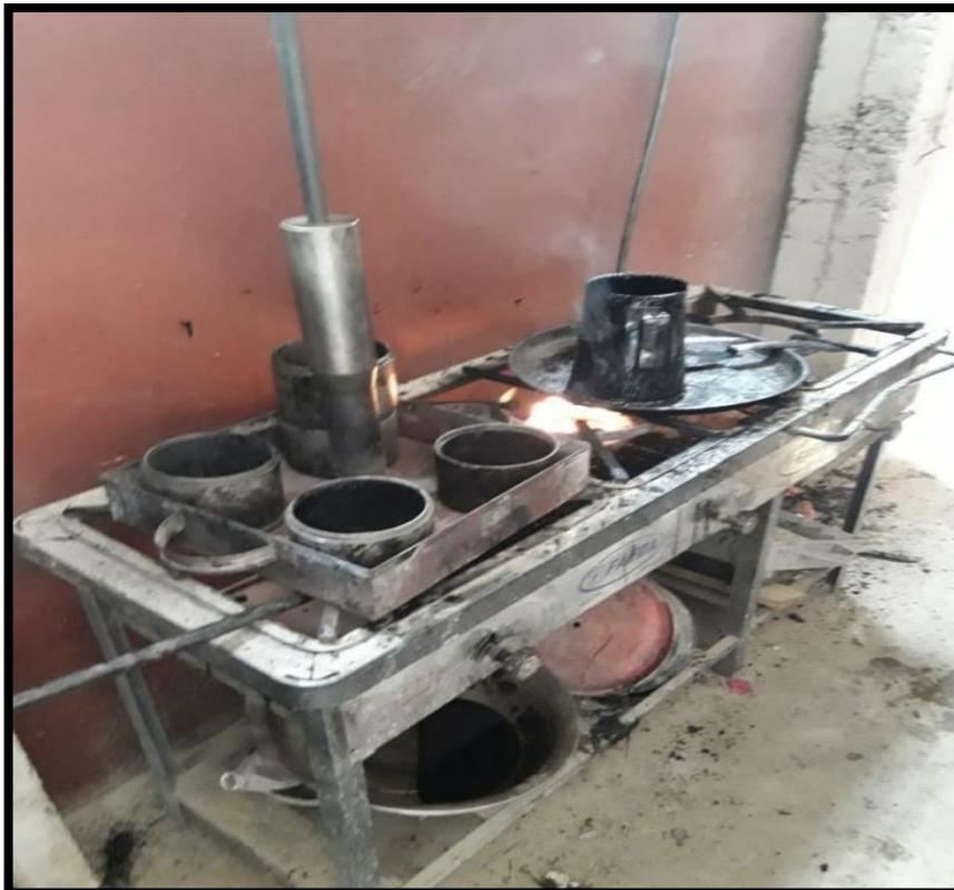
Figura 44. Equipo e instrumentos a utilizar para el ensayo Marshall. Tarado de los materiales
