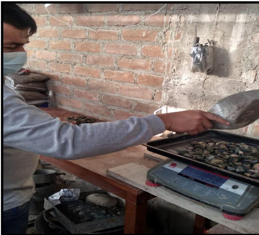
Figura 32. material ya seco superficialmente siendo pesado en la balanza calibrada del laboratorio
