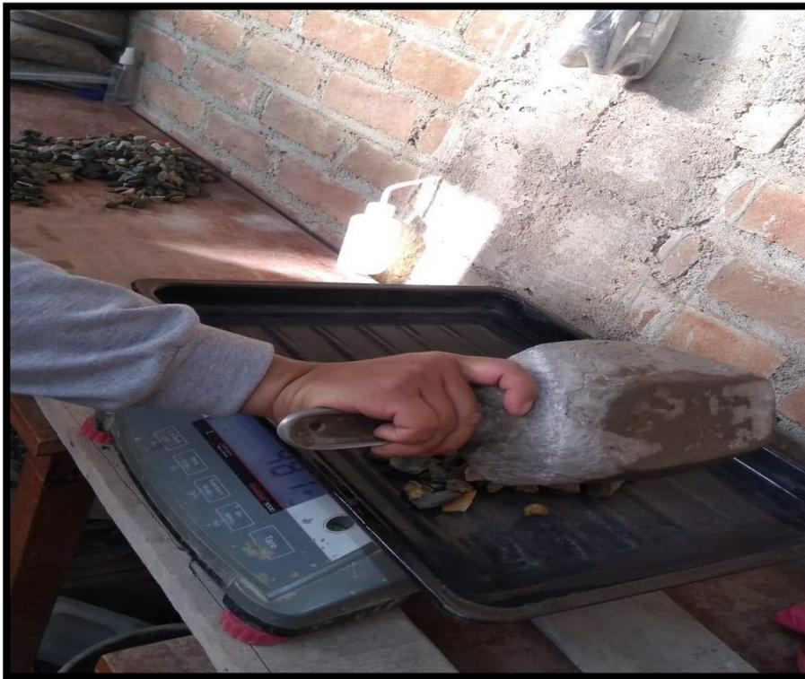
Figura 31. Continuando con el material se procede a su secado superficial y al pesado
