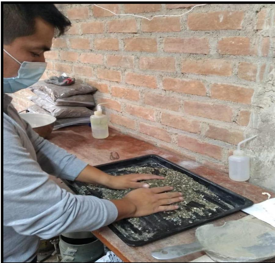
Figura 36. Se pesa 500 gramos y se procede a humedecer el confitillo parcialmente.
