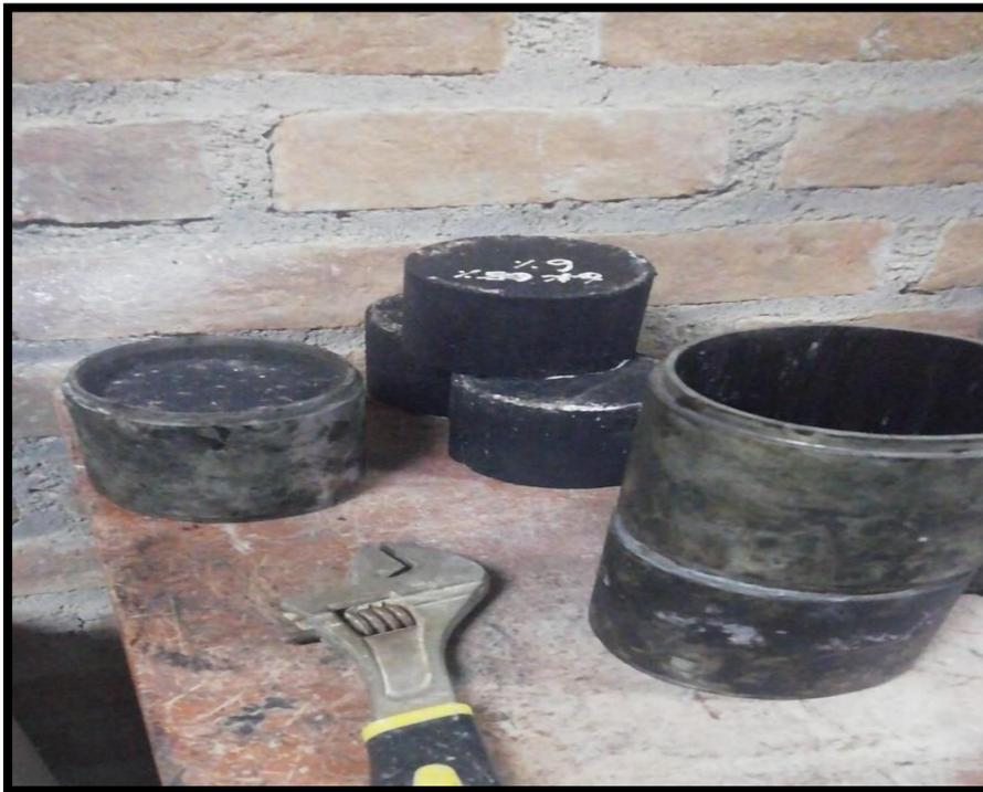
Figura 51. Desmolde de las briquetas una vez enfriadas y toma de medidas para obtener datos para el ensayo del RICE
