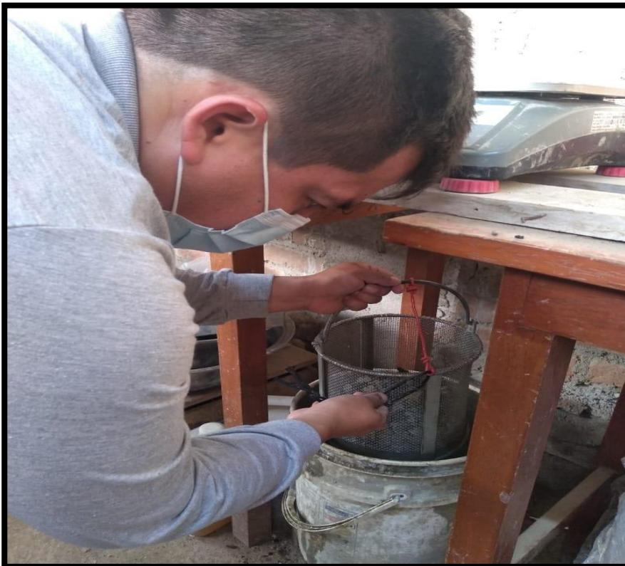
Figura 30. Material siendo retirado del agua conjuntamente con la canastilla para seguir con el secado
