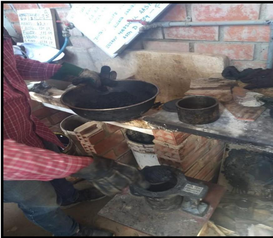
Figura 49. Colocación del material ya mezclado dentro de la briqueta para ser compactado.
