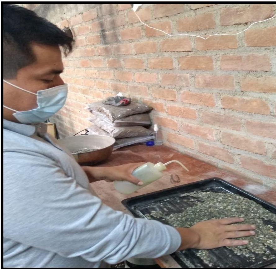
Figura 34. Inicio del ensayo de peso específico del confitillo, se procede a humedecer parcialmente
