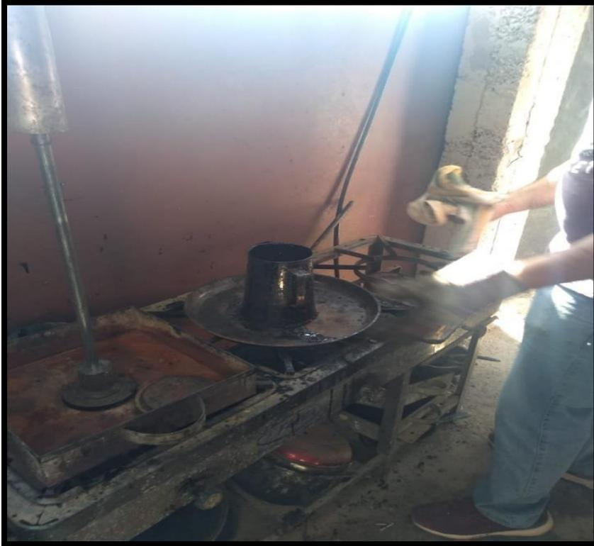
Figura 45. Para el desarrollo del ensayo Marshall se requiere que el cemento asfáltico este a 140°C
