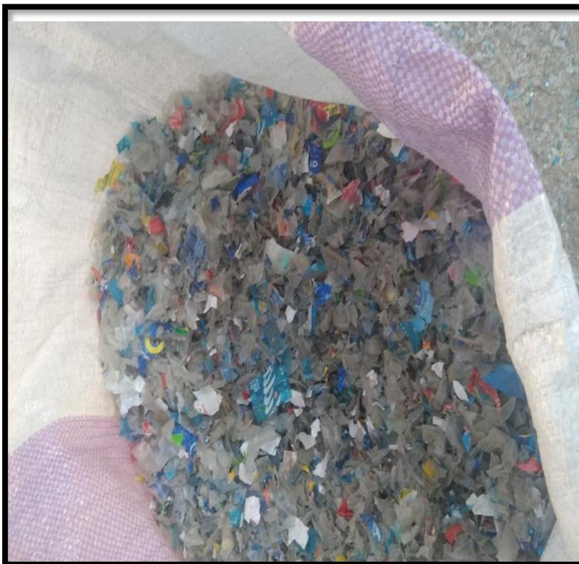
Figura 04. Para obtener este material se debe triturar las botellas que fueron recicladas. Este es un PET netamente de productos que lo podemos encontrar en la vida cotidiana en botellas de bebidas como agua, gaseosas y/o bebidas energizantes
