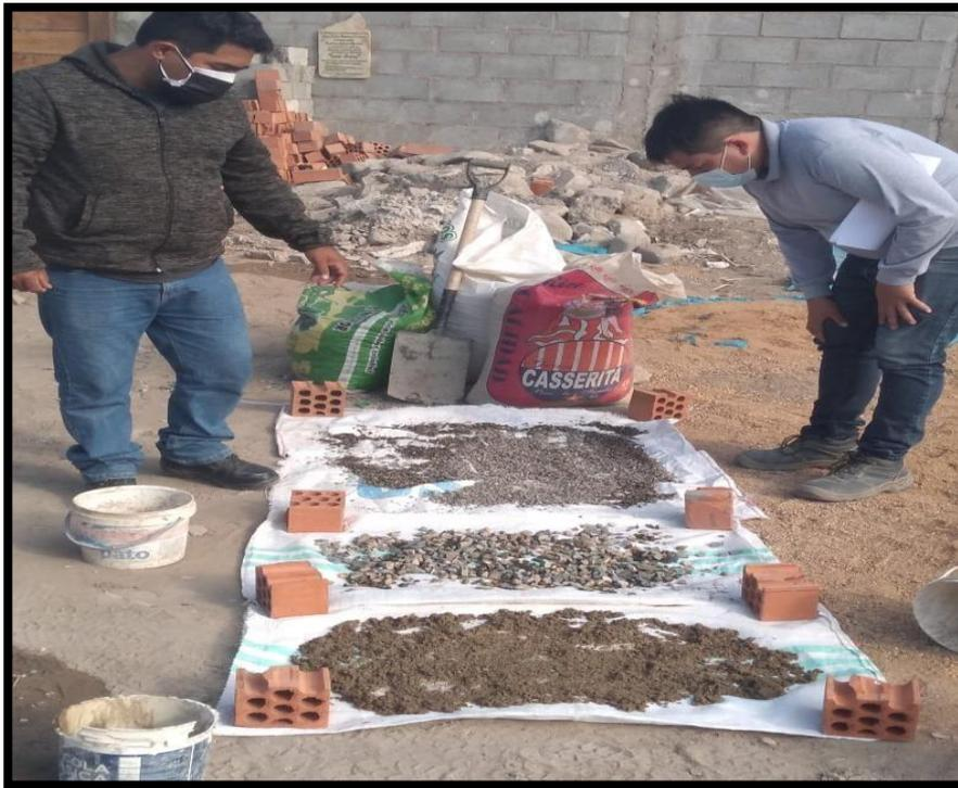
Figura 25. Asesoramiento del laboratorista y Secado de los materiales al ambiente
