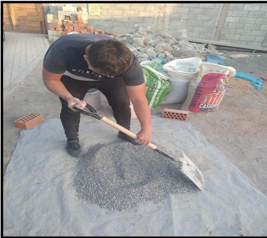
Figura 21. Preparación del material para el desarrollo del ensayo de peso unitario y peso específico con ayuda de equipos manuales
