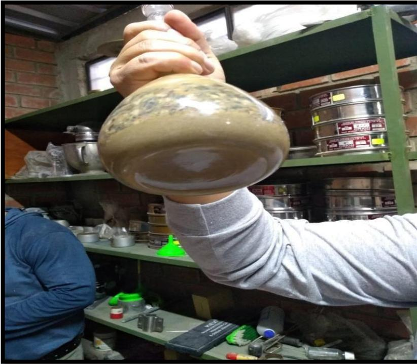
Figura 41. Se termina de sacar los vacíos y se pesa y se obtiene el peso específico del confitillo.
