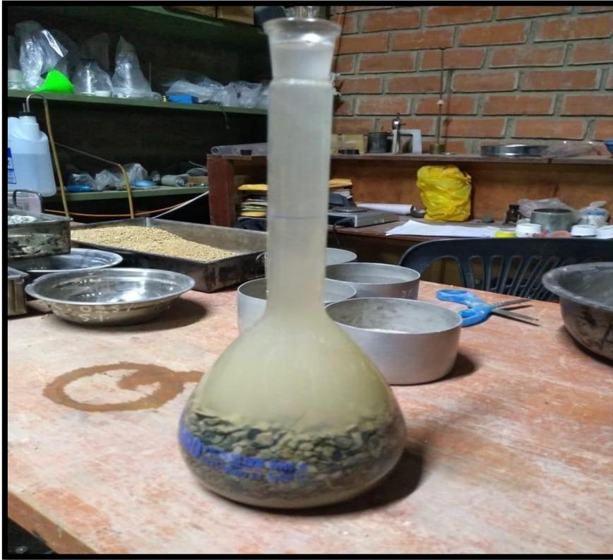
Figura 39. continuando con el ensayo se procede a colocar los 500 gramos en la fiola y se procede a quitar los vacíos.
