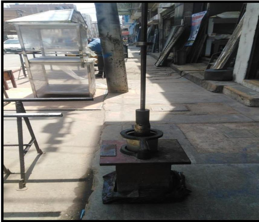
Figura 43. Presentación del equipo del compactador Marshall. (Pedestal de compactación, martillo de compactación y briqueta normada)
