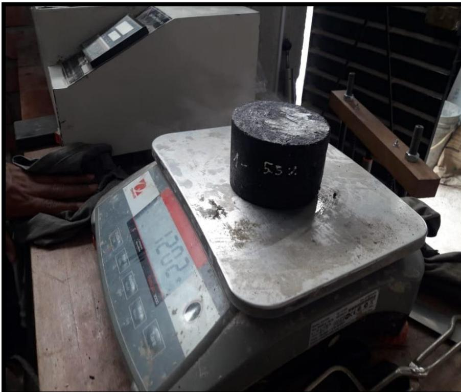
Figura 52. Pesado de las briquetas y codificación de la misma por cada porcentaje.
