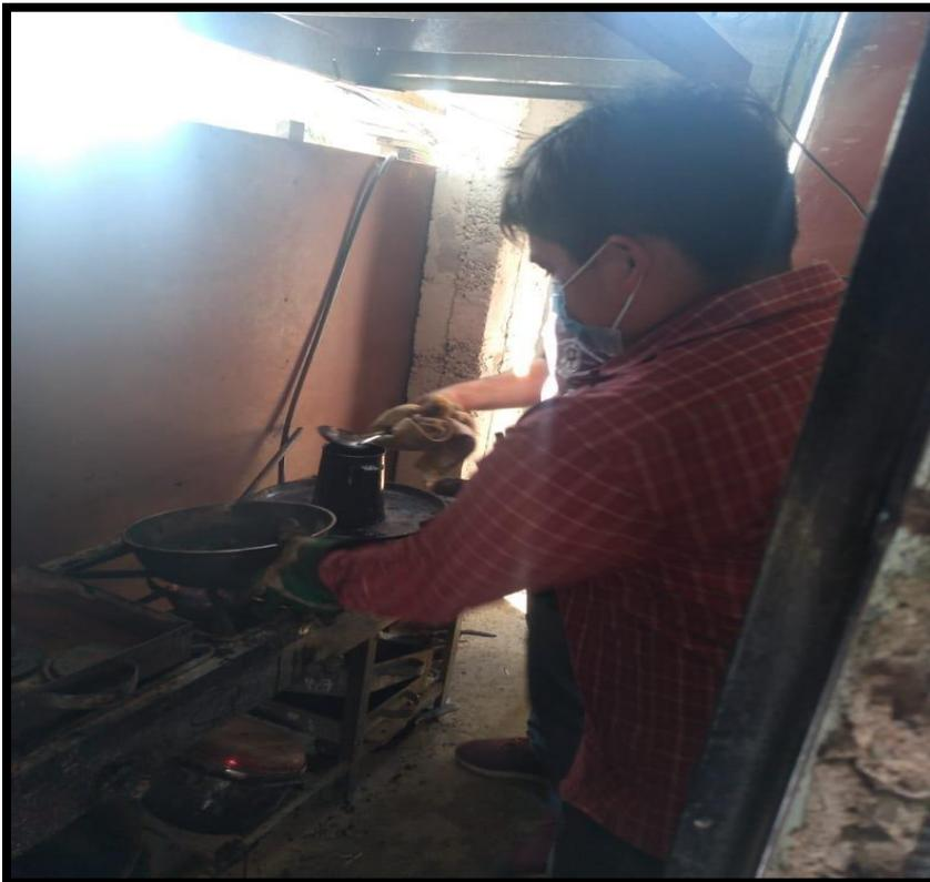
Figura 46. Incorporación del cemento asfáltico al material tarado de los materiales trabajado en caliente.
