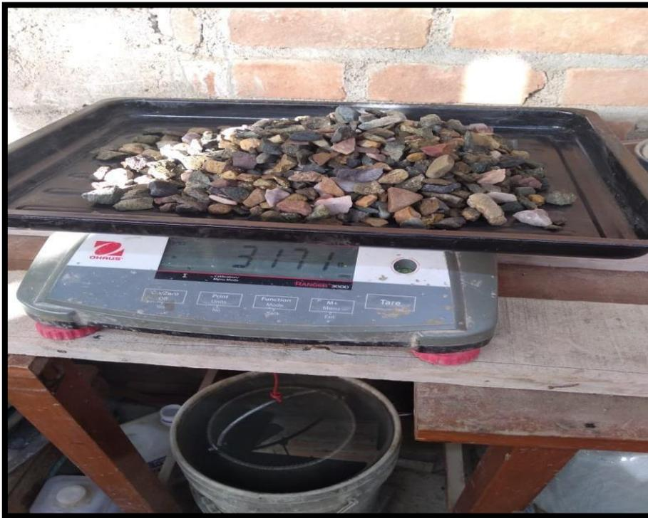
Figura 33. Se toma el dato del peso y se culmina el ensayo de peso específico de la piedra
