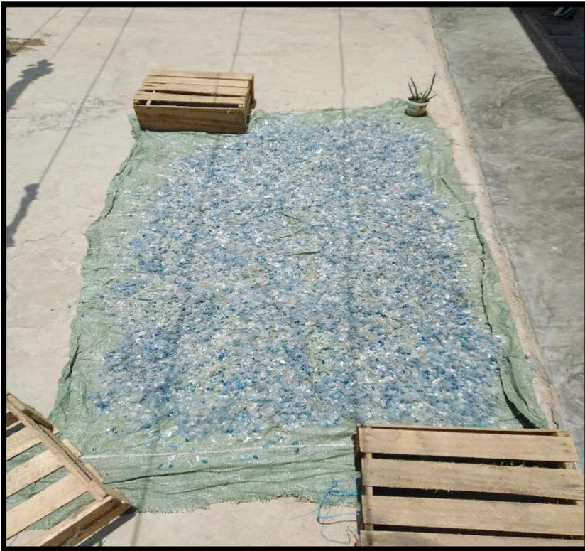
Figura 07. Se observa el PET en secado a temperatura ambiente
