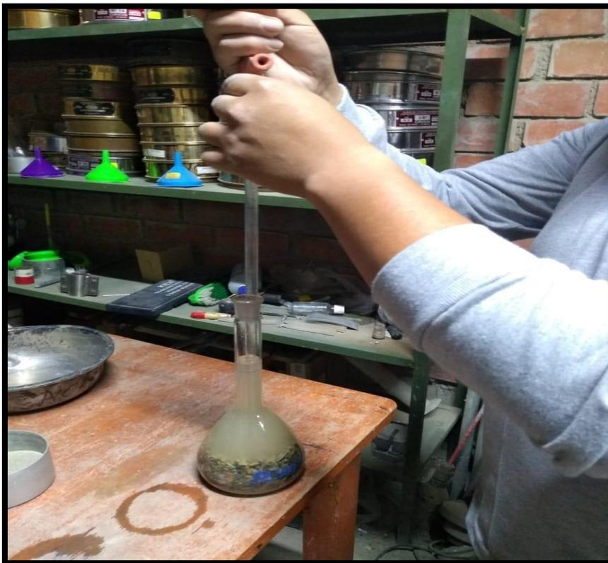
Figura 40. Se procede a retirar el agua agitando por 30 minutos la fiola.
