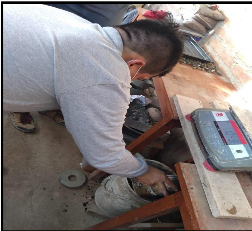
Figura 28. Introducción del material granular en la canastilla para determinar su peso sumergido
