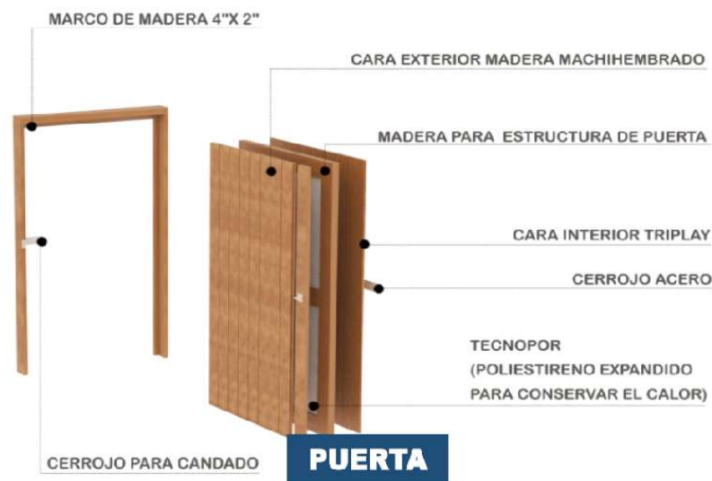
Figura 25. Puertas de madera
