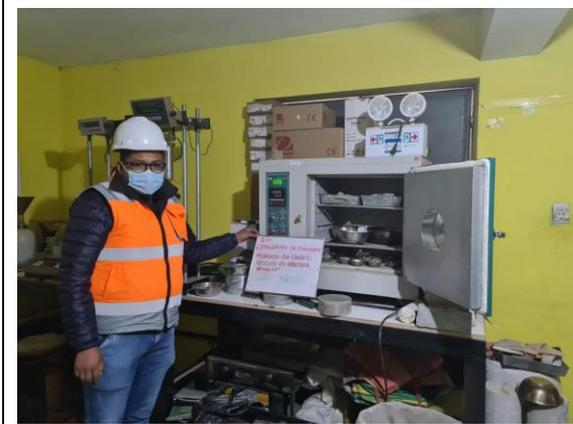
**Figura 29.** Secado de las muestras en el horno
