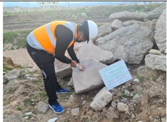
*Figura 16. Toma de la resistencia a la compresión de los residuos de concreto*
