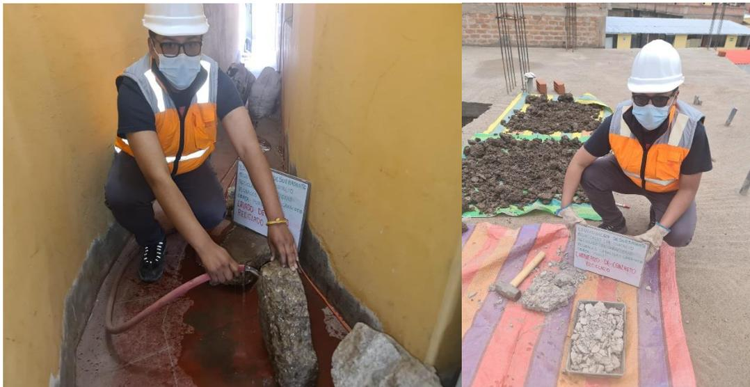
*Figura 7.* Limpieza y trituración de los residuos de concreto
