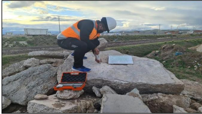
*Figura 6.* Medición de la resistencia a la compresión a través del esclerómetro
