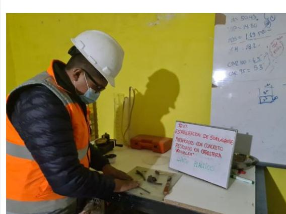
**Figura 30.** Ensayo de límite plástico
