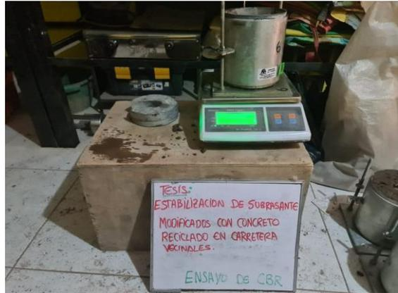
Figura 34. Pesado del molde de Proctor
