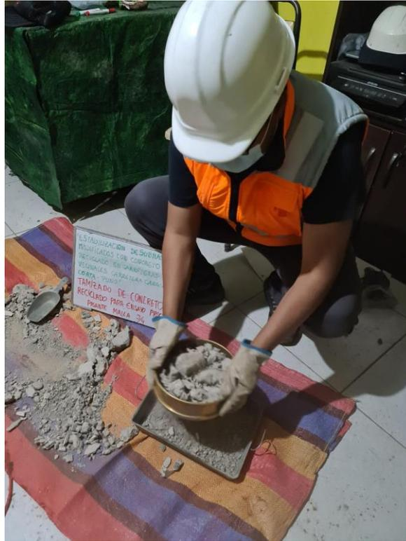
Figura 8. Tamizado del concreto reciclado
