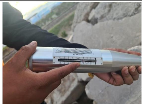
*Figura 18. Esclerómetro usado para medir la resistencia a la compresión de los residuos de concreto*
