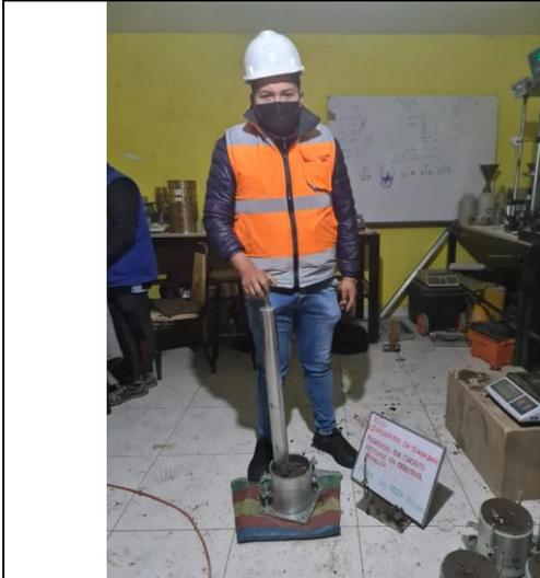
Figura 33. Compactación, ensayo de Proctor modificado
