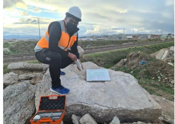
*Figura 20. Toma de la resistencia a la compresión de los residuos de concreto*
