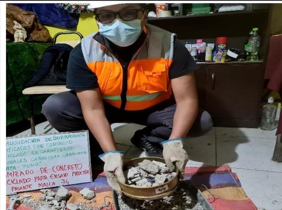
**Figura 28.** Tamizado del concreto reciclado
