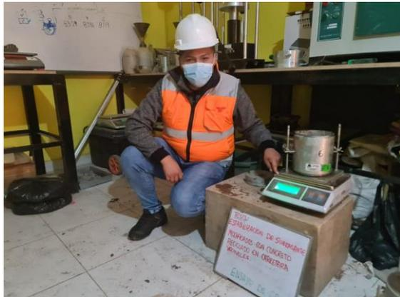
Figura 35. Pesado de la muestra de suelo compactada
