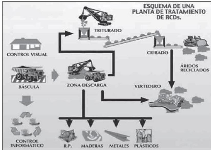
Figura 4. Tratamiento del concreto reciclado, tomado de «Análisis de residuos de construcción y demolición (RCD) para su reutilización en obras de ingeniería civil» por Sanchez (33)
