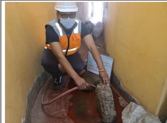
**Figura 27.** Lavado del concreto reciclado con presión de agua
