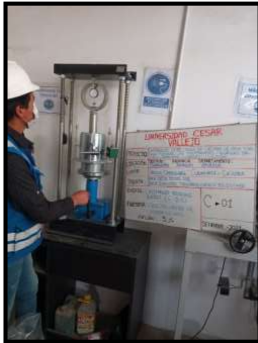
Figura 17. Ejecucion del ensayo de C.B.R California Bearing Ratio.
