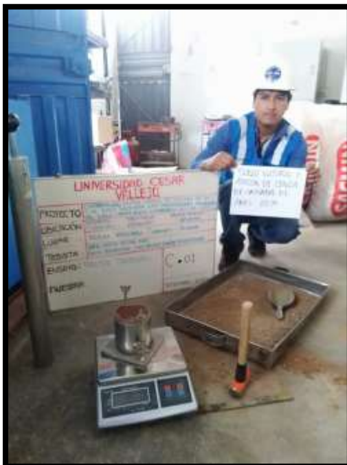
Figura 18. Ensayo Limite liquido muestra patrón con adición de 10% Ceniza de anís
