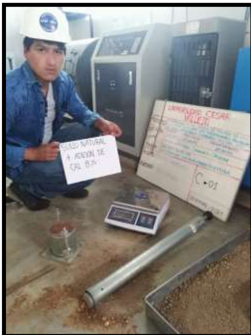
Figura 36. Ensayo Limite liquido muestra patrón con adición de 8% Cal.
