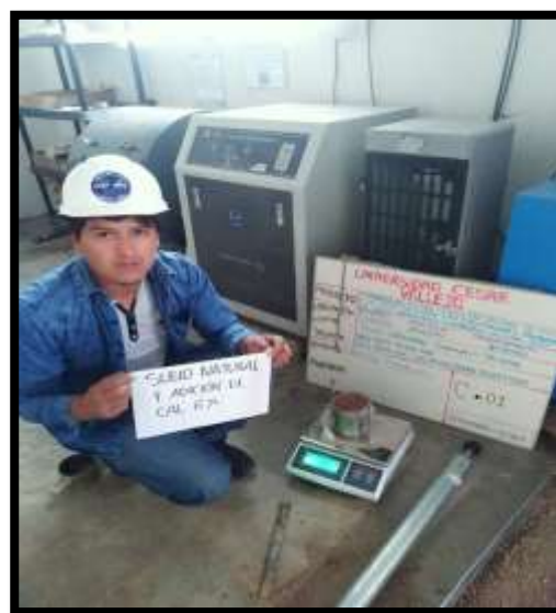
Figura 14. Ensayo Proctor Modificado muestra patrón con adición de 6% Cal
