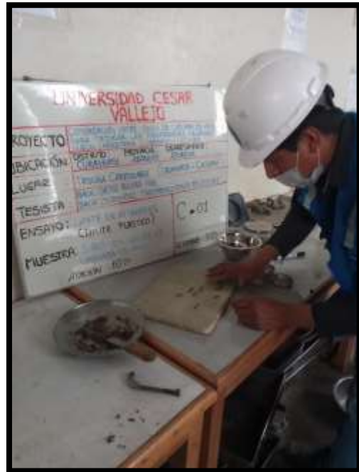
Figura 19. Ensayo Limite Plástico muestra patrón con adición de 10% Ceniza de anís
