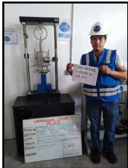
Figura 35. Ensayo de C.B.R muestra patrón con adición de 6% Cal
