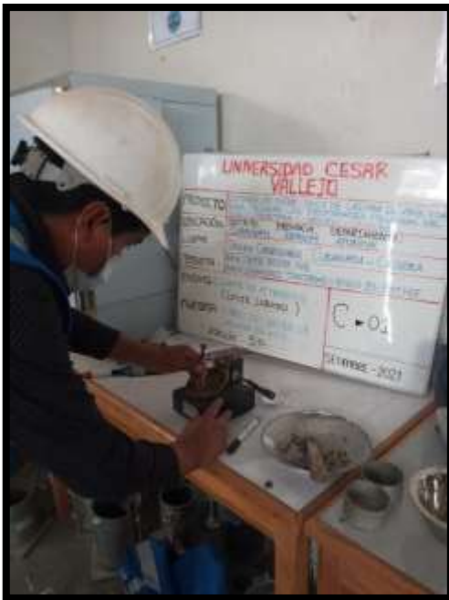
Figura 12. Ensayo Limite liquido muestra patrón con adición de 5%
