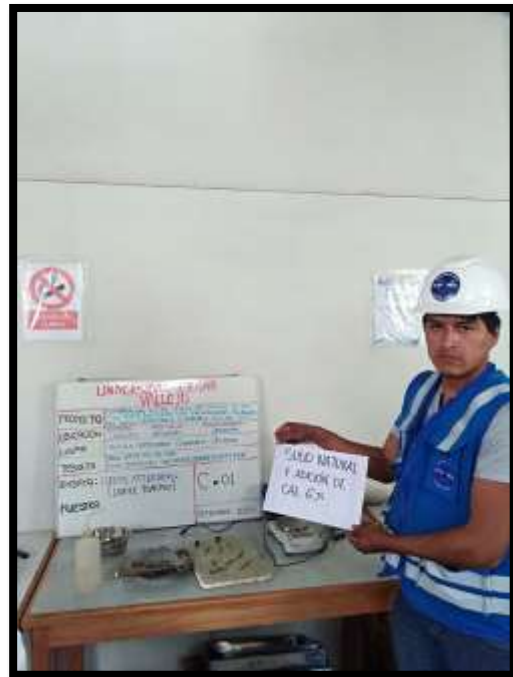
Figura 33. Ensayo Limite Plástico muestra patrón con adición de 6% Cal.
