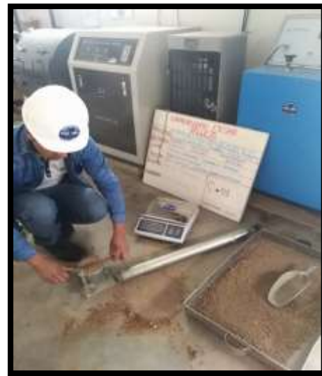
Figura 08. Ensayo-Proctor Modificado C-01
