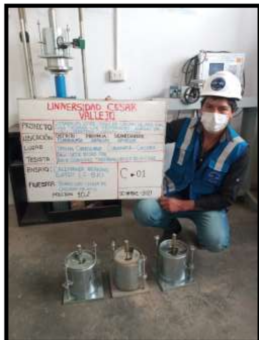
Figura 19. Ensayo Limite Plástico muestra patrón con adición de 10% Ceniza de anís
