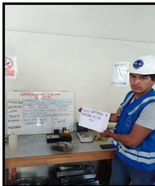
Figura 20. Ensayo Limite liquido muestra patrón con adición de 4% Cal.
