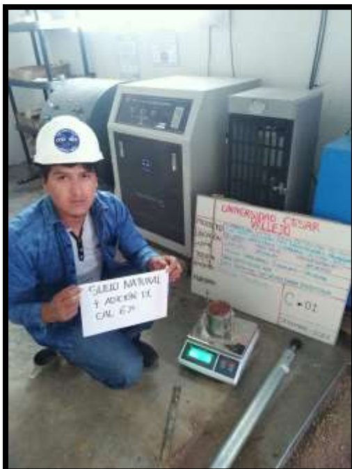
Figura 34. Ensayo Proctor Modificado muestra patrón con adición de 6% Cal.
