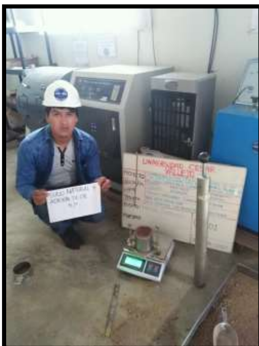
Figura 30. Ensayo Proctor Modificado muestra patrón con adición de 4% Cal
