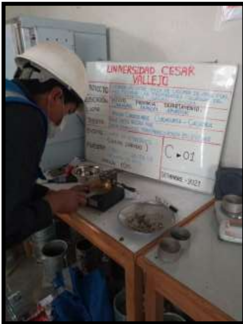
Figura 18. Ensayo Limite liquido muestra patrón con adición de 10% Ceniza de anís
