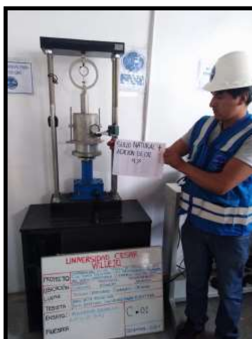
Figura 31. Ensayo de C.B.R muestra patrón con adición de 4% Cal
