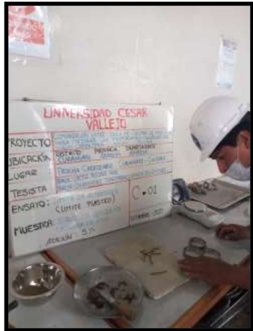
Figura 13. Ensayo Limite Plástico muestra patrón con adición de 5%
