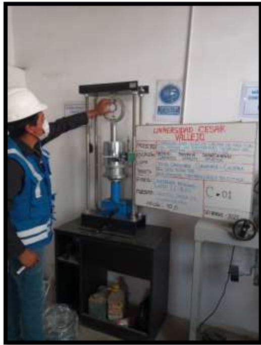
Figura 23. Ejecucion del ensayo C.B.R California Bearing Ratio.
