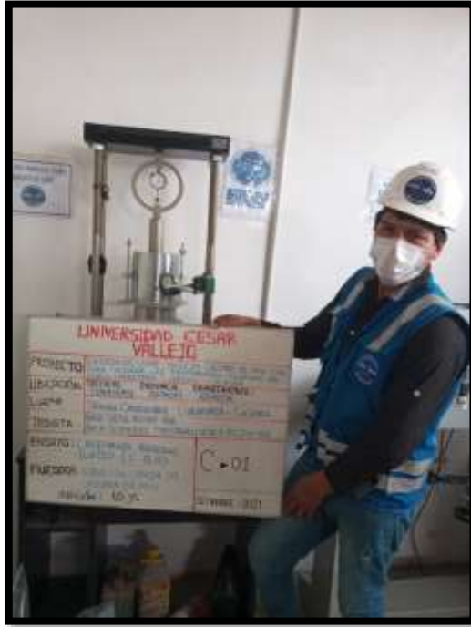
Figura 22. Ensayo C.B.R muestra patron con adición de 10% de Cenisa de anis.
