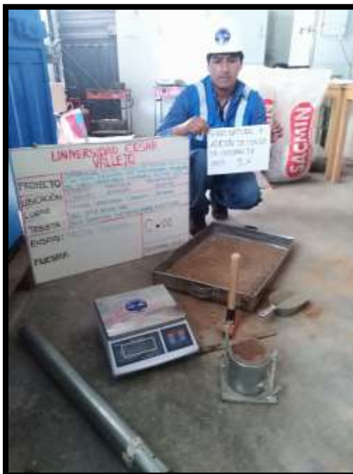
Figura 14. Ensayo Proctor Modificado muestra patrón con adición de 5% Cenisa de anís
