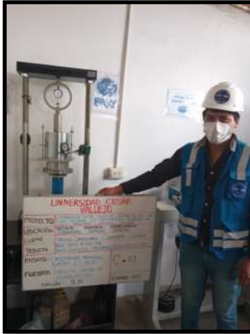
Figura 16. Ensayo C.B.R muestra patron con adicion de 5% de Cenisa de anis
