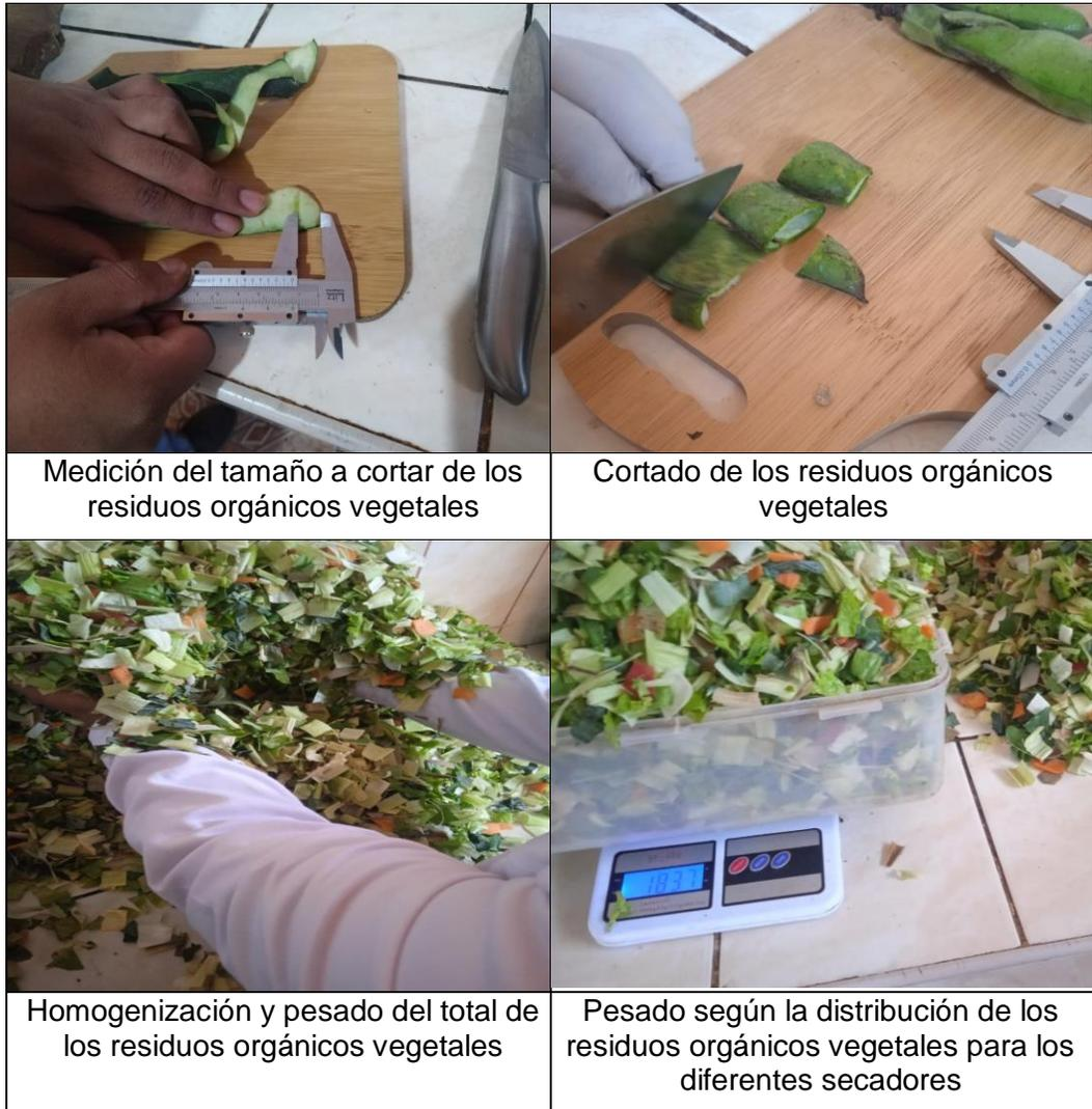
Figura 12: Cortado y homogenizado de los residuos
