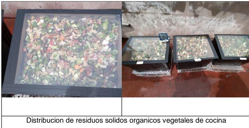
Figura 14: Distribución de residuos sólidos orgánicos vegetales dentro de los secadores solares.
