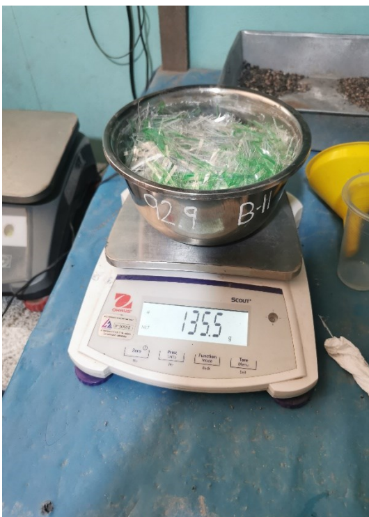
Fotografía N° 4: Fibra PET cortadas con dimensiones de 3 mm x 2 mm. Fuente: Elaboración propia.
