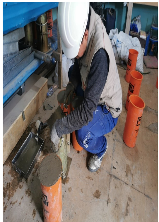
Fotografía N° 9: Moldeo de briquetas para compresión y tracción. Fuente: Elaboración propia.
