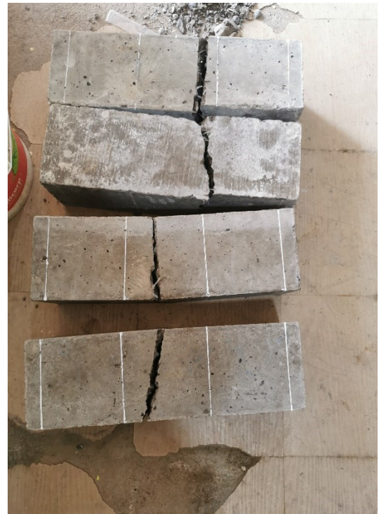
Fotografía N° 19: Roturas de vigas a los 28 días, corte en el tercio medio de la viga.
