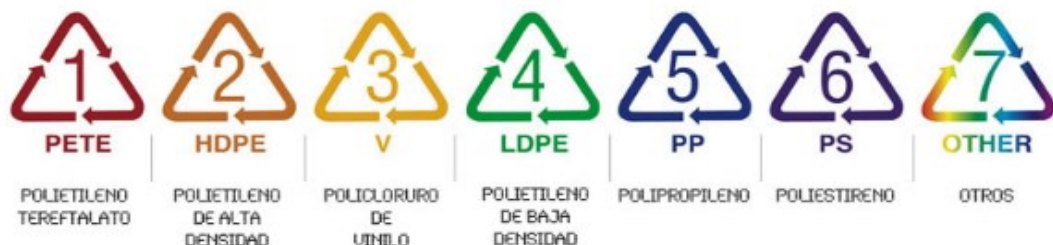
Figura 1. Código de identificación de resina de plástico. Fuente: (Mariano, 2011)
