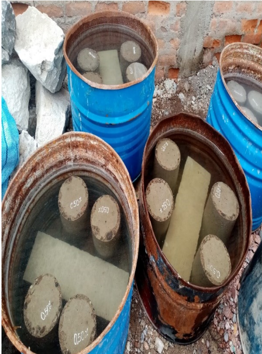
Fotografía N° 10: Curado de briquetas y vigas de concreto. Fuente: Elaboración propia.
