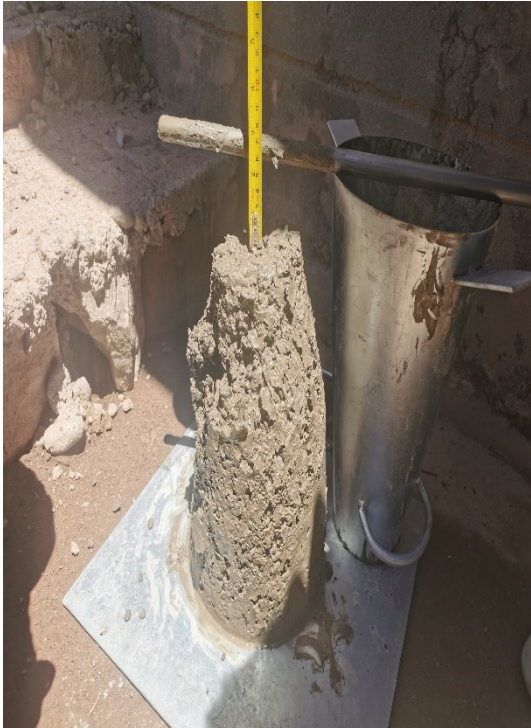
Fotografía N° 6: Ensayo de asentamiento con el cono de Abrams. Fuente: Elaboración propia.
