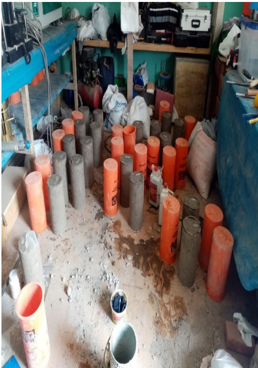
Fotografía N° 12: Desmoldeo de briquetas para compresión y tracción. Fuente: Elaboración propia.
