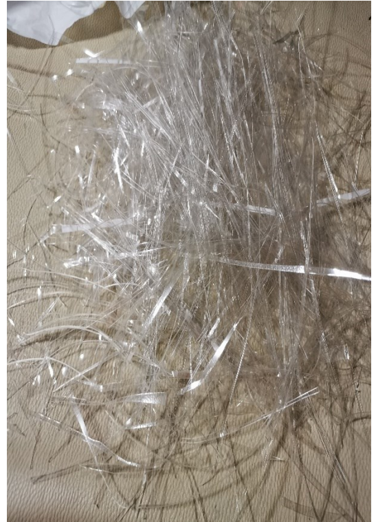
Fotografía N° 3: Fibra PET cortadas con dimensiones de 3 mm x 2 mm. Fuente: Elaboración propia.
