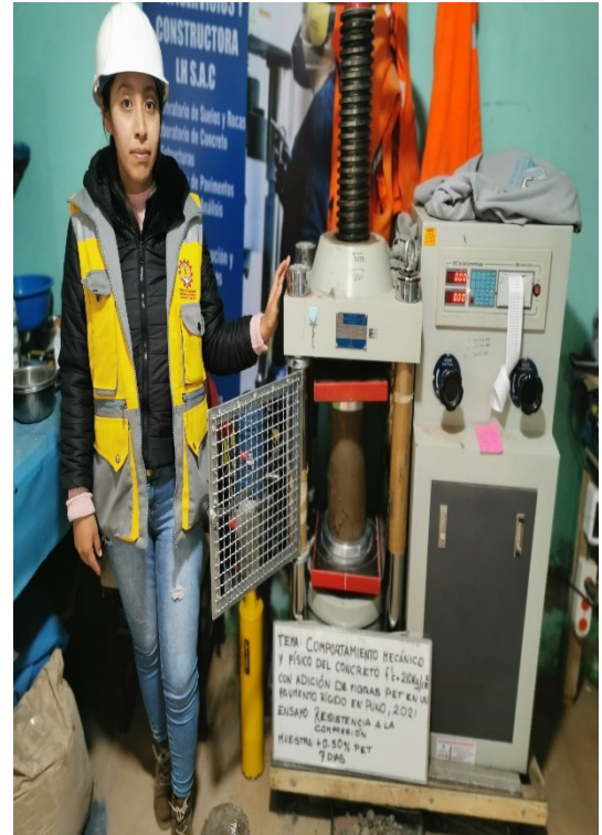
Fotografía N° 13: Rotura de briquetas a compresión a los 7 días de curado. Fuente: Elaboración propia.
