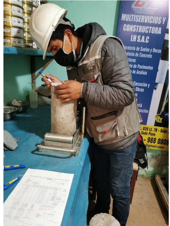
Fotografía N° 15: Preparación de briqueta para el ensayo a tracción. Fuente: Elaboración propia.
