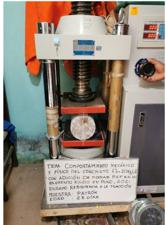
Fotografía N° 17: Rotura de briqueta sometida a esfuerzos de tracción a los 28 días. Fuente: Elaboración propia.
