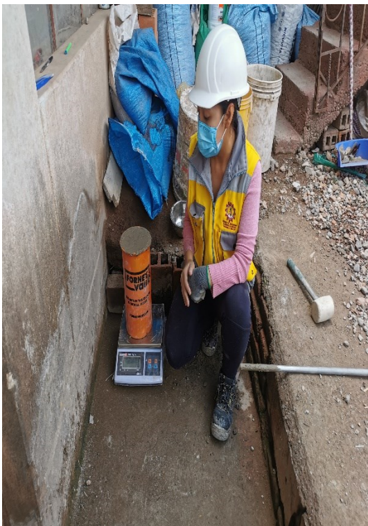
Fotografía N° 9: Ensayo de pesos unitario del concreto. Fuente: Elaboración propia.
