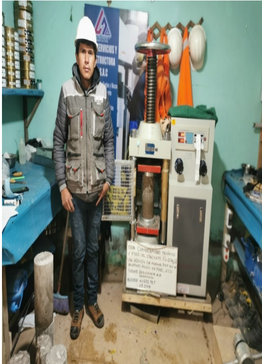
Fotografía N° 14: Rotura de briquetas a compresión a los 28 días de curado. Fuente: Elaboración propia.
