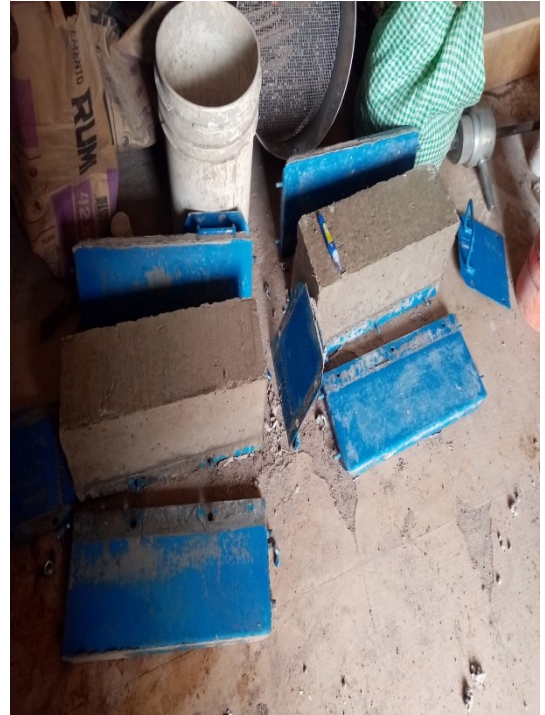
Fotografía N° 11: Desmoldeo de vigas para resistencia a la flexión. Fuente: Elaboración propia.
