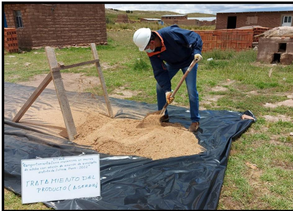
**Fotografía 6: Cálculo del aserrín para la dosificación**
