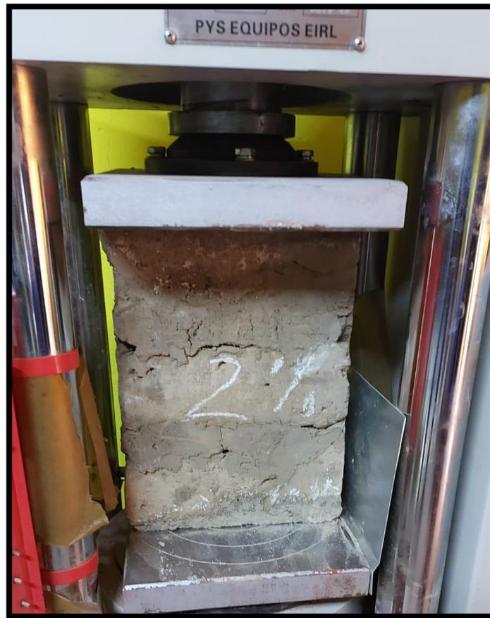
**Fotografía 16:** prueba de compresión diagonal
