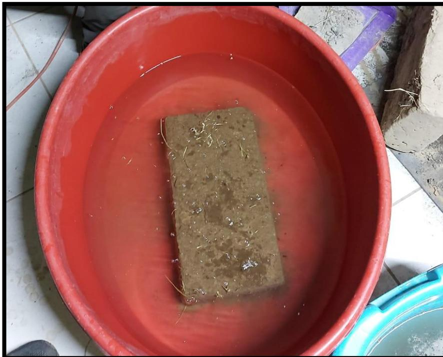
**Fotografía 11:** muestra resultante después de 24 horas sumergida
