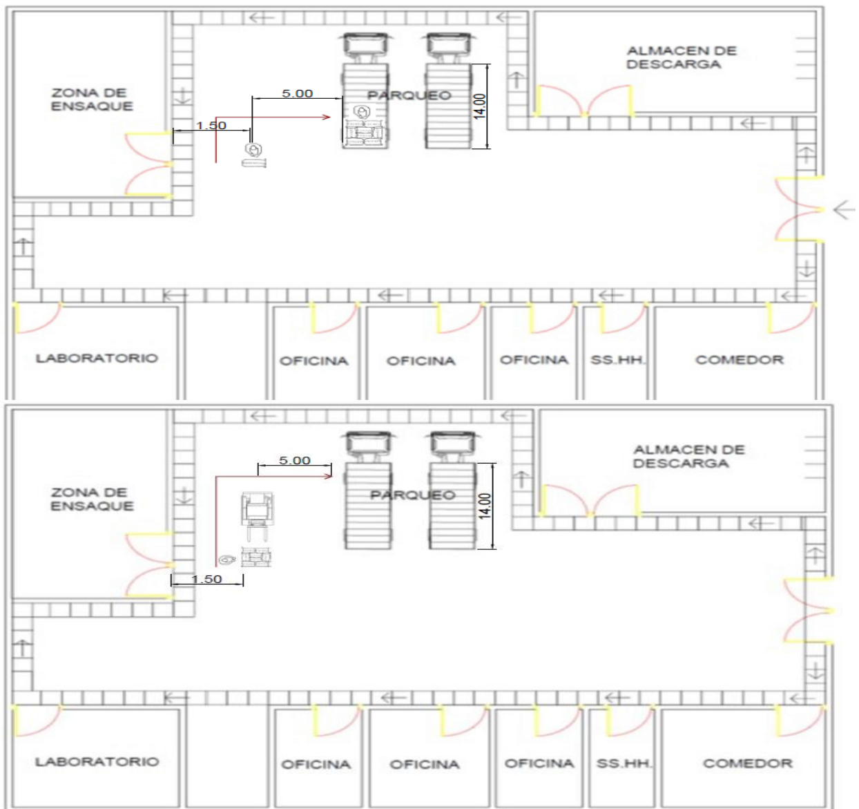
Figura 4.- Diagrama de recorrido del estibador antes y después de la mejora en el diseño de puesto de trabajo
