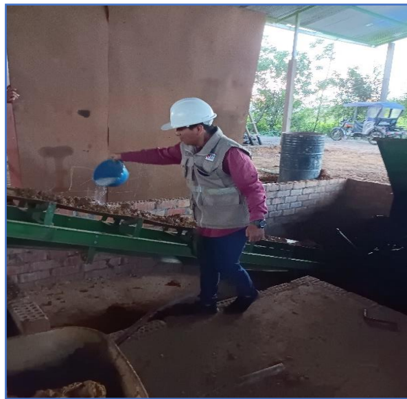
Figura N°04. Mezclado de la arcilla con el vidrio en la faja transportadora.
