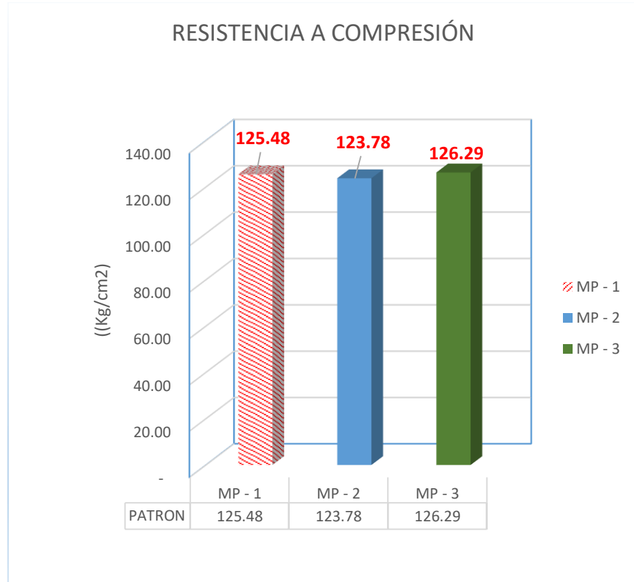
Figura N° 25. Resistencia a la compresión ladrillo de arcilla muestra patrón.
