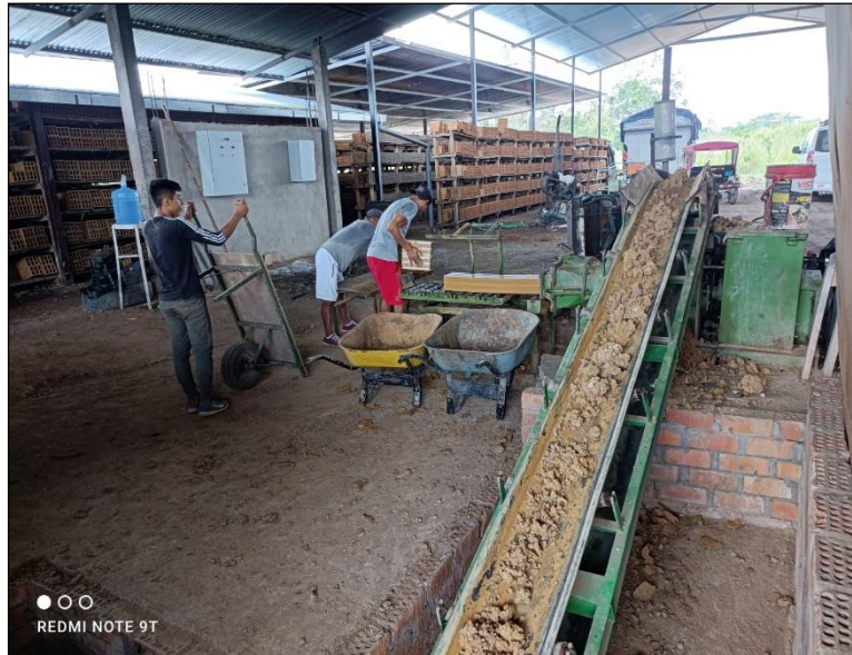
Obtención del ladrillo solido con los diferentes porcentajes de adición del vidrio reciclado triturado.
