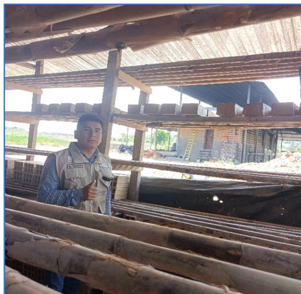
Figura N°06. Secado de los ladrillos solidos artesanales.
