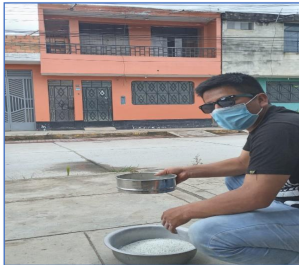
Figura N°02. Trituración y tamizado manual del vidrio.
