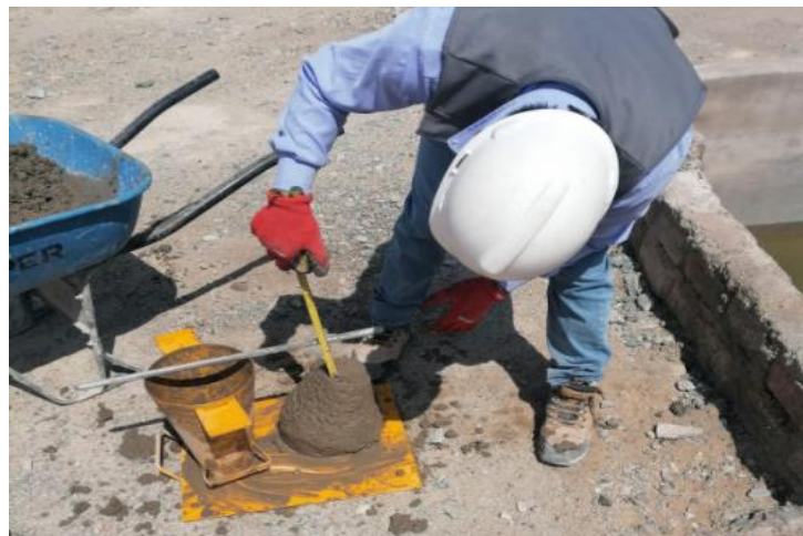
Figura 11. Determinación del asentamiento
