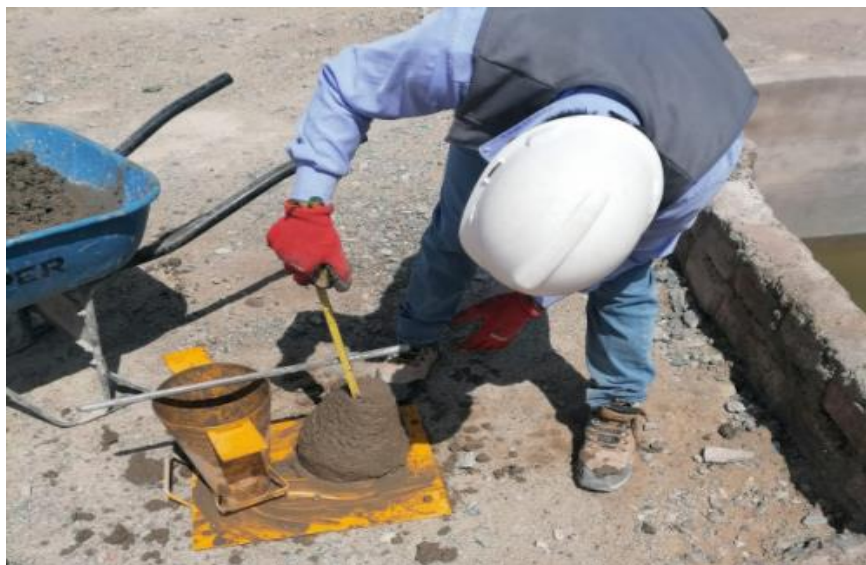
Realizando la fluidez o plasticidad del concreto con cono de Abrams
