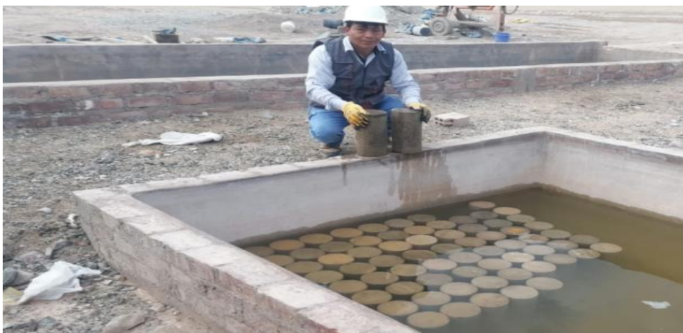
Curado de briquetas en agua potable hasta cumplir con la edad especificada
