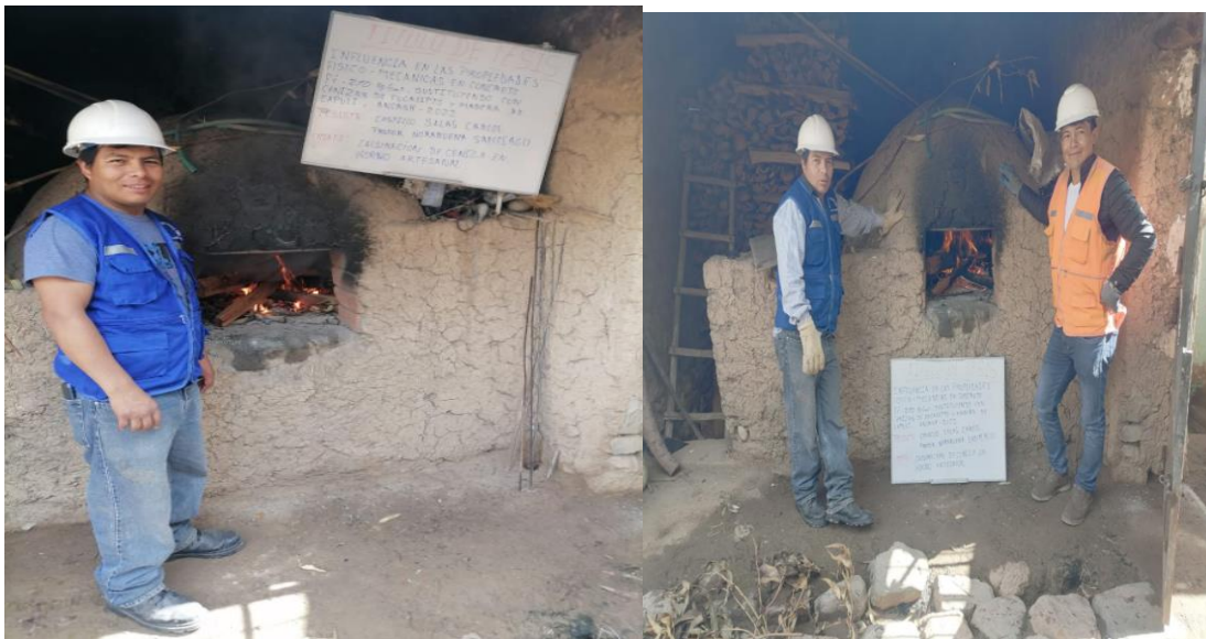
Calcinación de ceniza de eucalipto en horno artesanal
