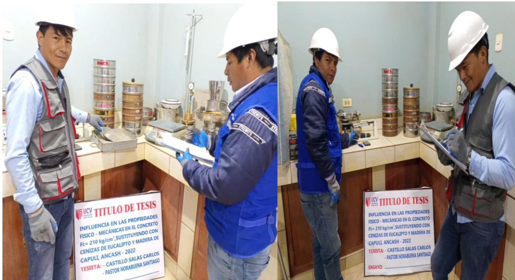
Realizando Granulometría de agregado fino
