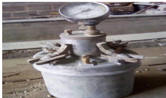
Figura 17: Determinación de aire del concreto
