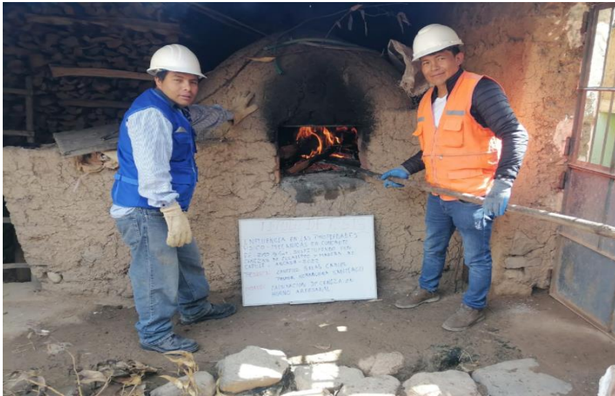
Calcinación de madera de capulí en horno artesanal
