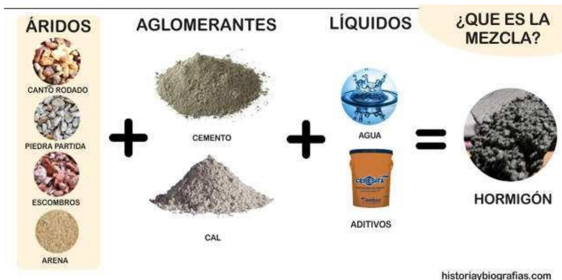
Figura 1. Composición del concreto
