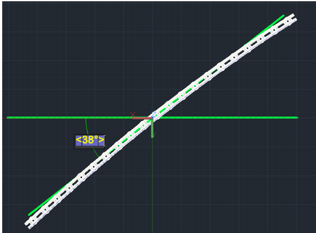
Ilustración 19: Ángulo de la barrera de contención
