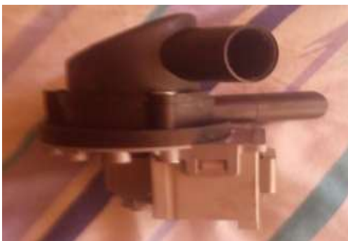
Bomba de agua
