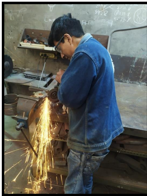
Figura 10. Trabajador sin epps completos
