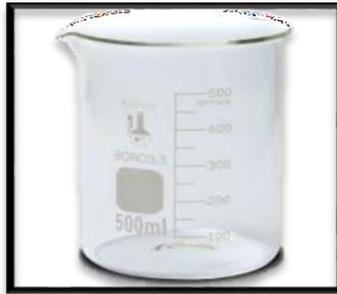
*Figura 12.* Vaso precipitado
