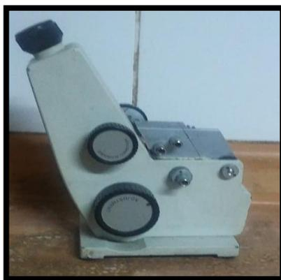
Figura 17. Refractómetro
