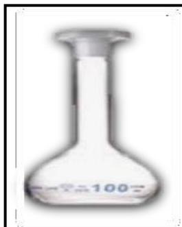
*Figura 11.* Balón volumétrico
