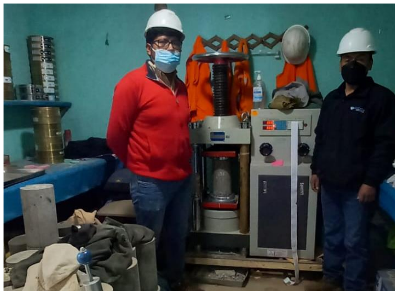
Figura 29: Ensayando las probetas a compresión
