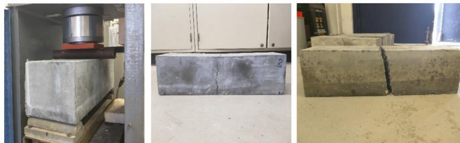
Figura 4: Esfuerzo de flexión en una vigueta.
