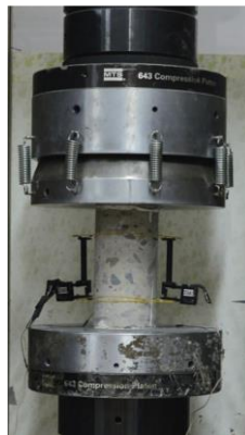
Figura 3: Esfuerzo de rotura de briquetas.
