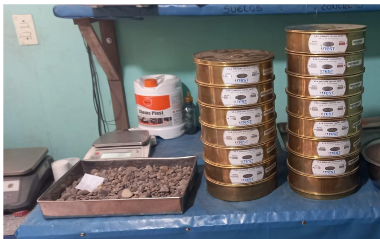
Figura 17: ensayo de granulometría para el agregado grueso
