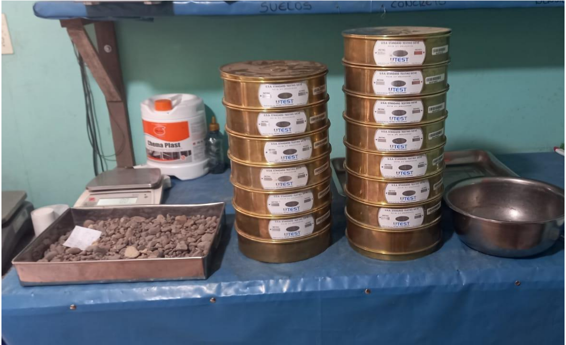
Fotografía 5: ensayo de granulometría
