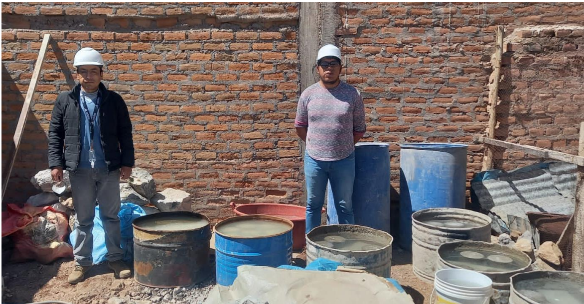
Fotografía 12: curado de probetas
