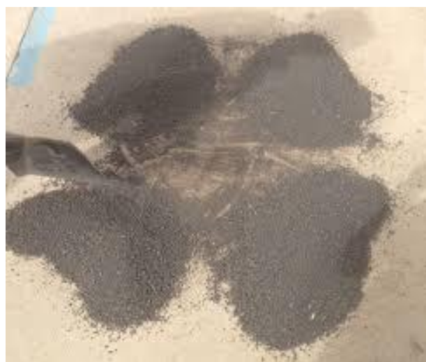
Figura 15: cuarteo de agregados
