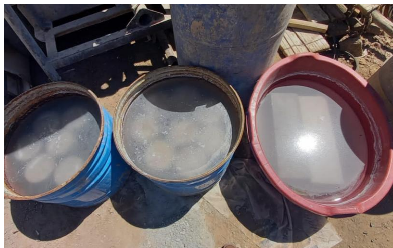
Figura 28: Probetas a ensayarse después de 7 días de curado
