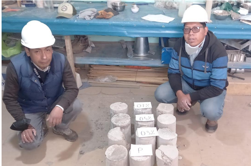
Figura 30: Probetas ensayadas a compresión
