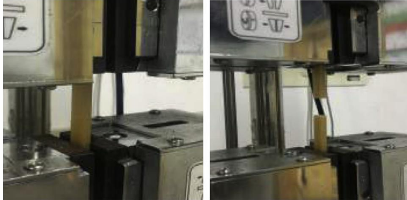
Figura 5: Ensayo de resistencia a la tracción
