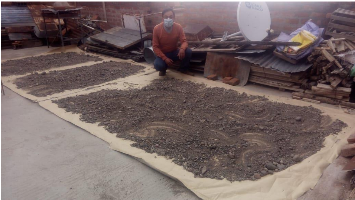
Fotografía 4: secado de los áridos
