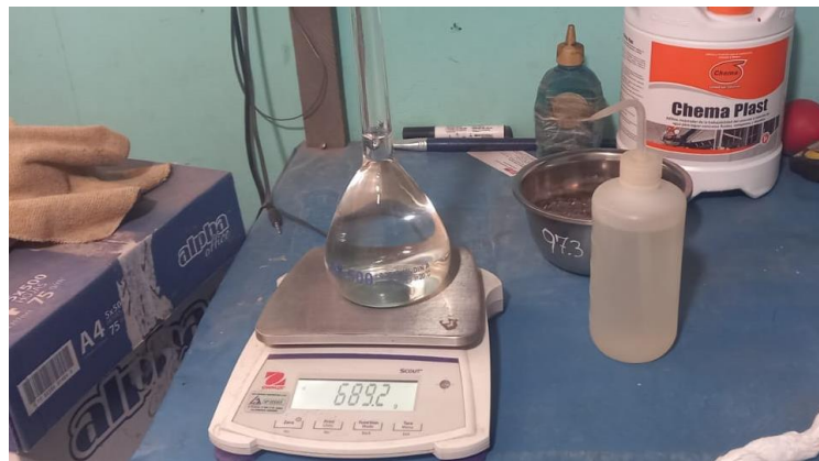
Figura 18: Pesado del picnómetro + agua
