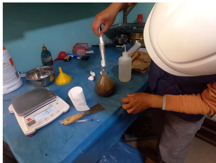
Figura 20: Secando con material absorbente las burbujas de agua
