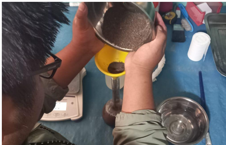
Figura 19: Agregando el agregado fino al picnómetro
