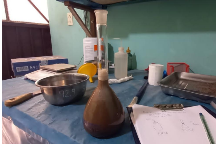
Figura 21: Forma total del picnómetro + muestra + agua
