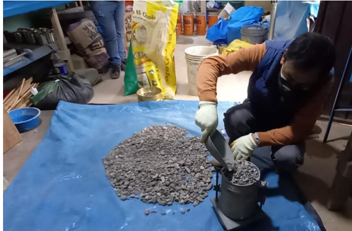
Figura 23: Ensayo de compactación del agregado grueso
