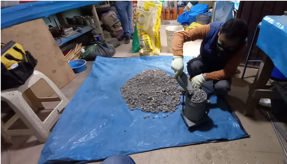
Fotografía 6: ensayo de compactación agregado grueso
