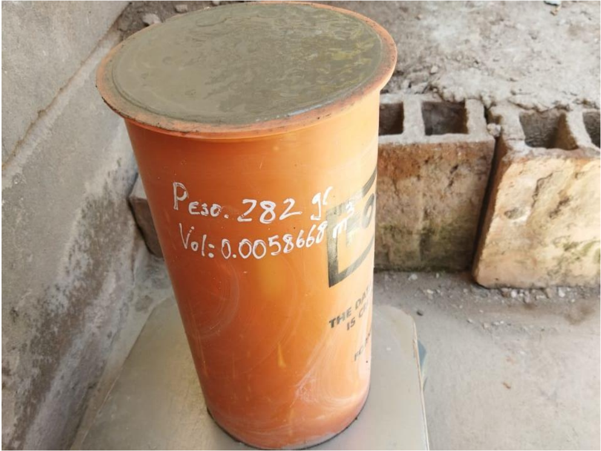
Fotografía 11: vaciado de probetas cilíndricas
