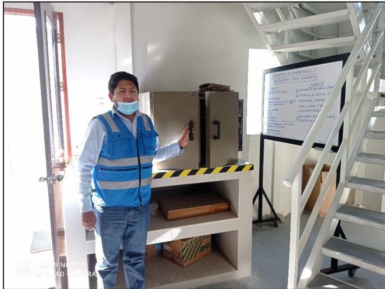
Figura 3.6. Horno de Laboratorio, para determinar contenido de Humedad
