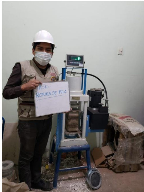
Figura 7. Ensayo de resistencia a compresión de pilas
