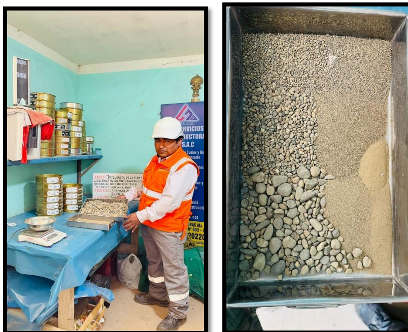
Figura 17 Después se procede a realizar las pruebas a realizar ensayo de granulométrica.
