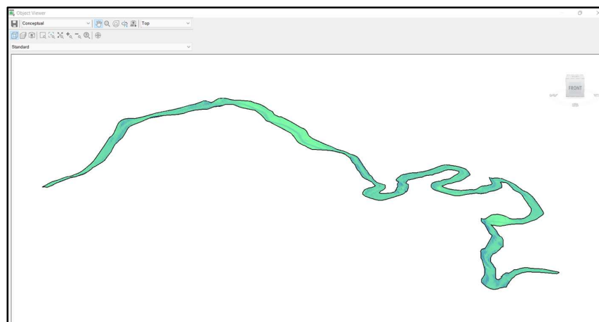
Figura 26. Modelo digital de terreno con estación total
