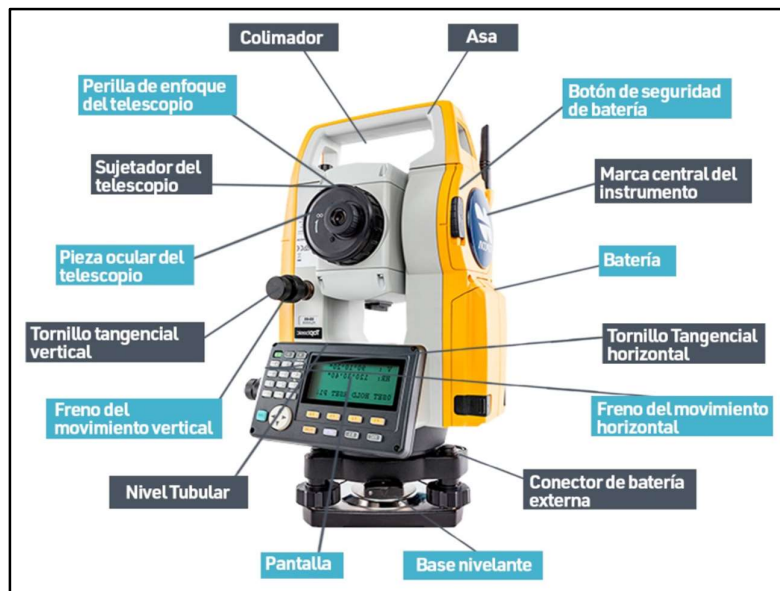
Figura 6. Partes de la estación total
