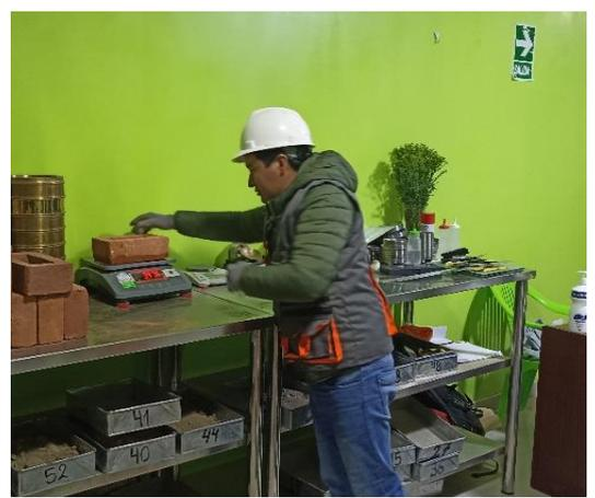
**Fotografía 36:** Ensayo de succión
