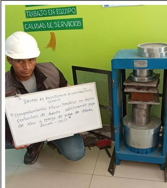
**Fotografía 37:** Ensayo de resistencia a compresión simple
