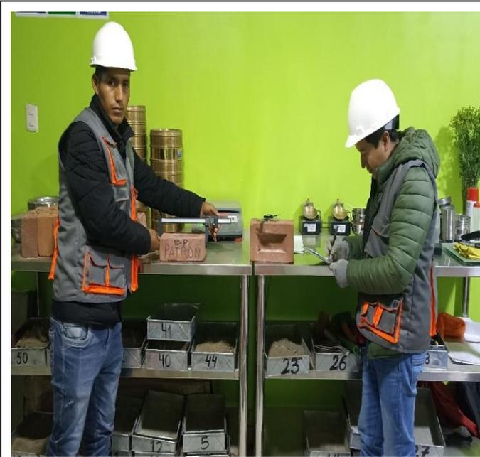
**Fotografía 25:** Ensayo de variación dimensional
