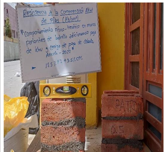
**Fotografía 40:** nivelación de las pilas
