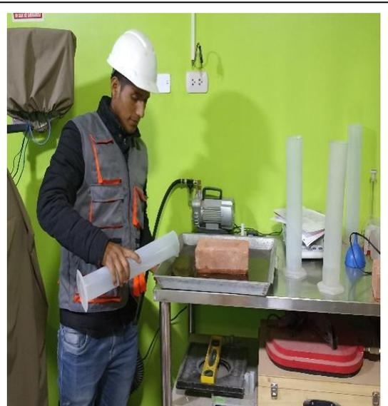
**Fotografía 34:** Adición de agua para el ensayo de succión
