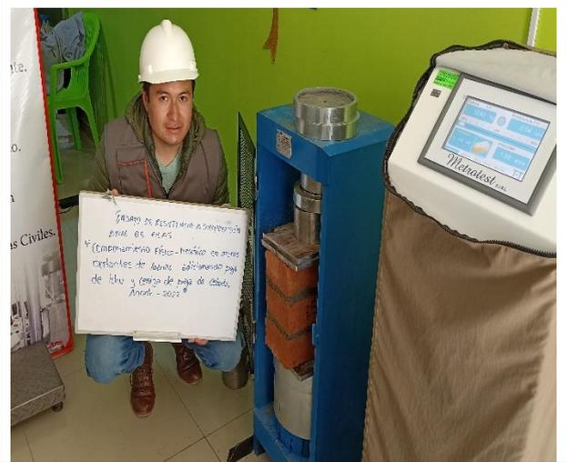
**Fotografía 44:** Ensayo de Resistencia a compresión Axial
