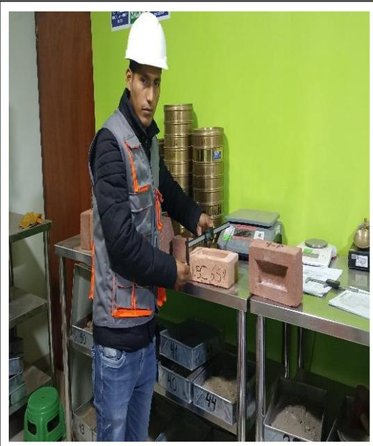
**Fotografía 26:** Ensayo de variación dimensional
