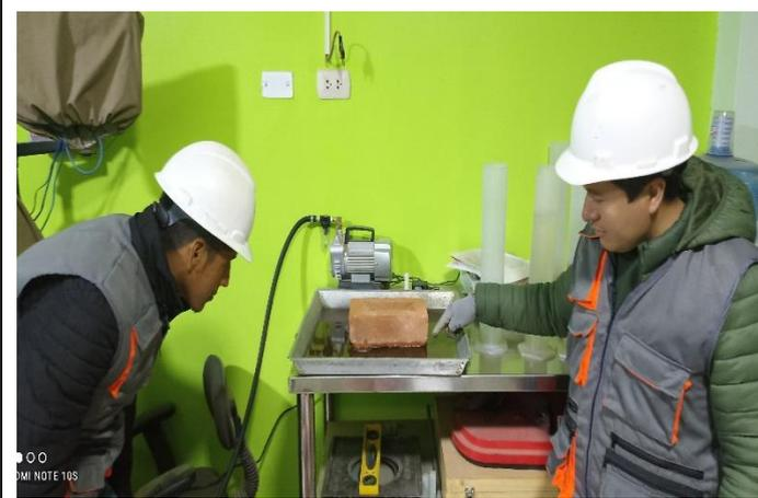
**Fotografía 35:** Ensayo de succión
