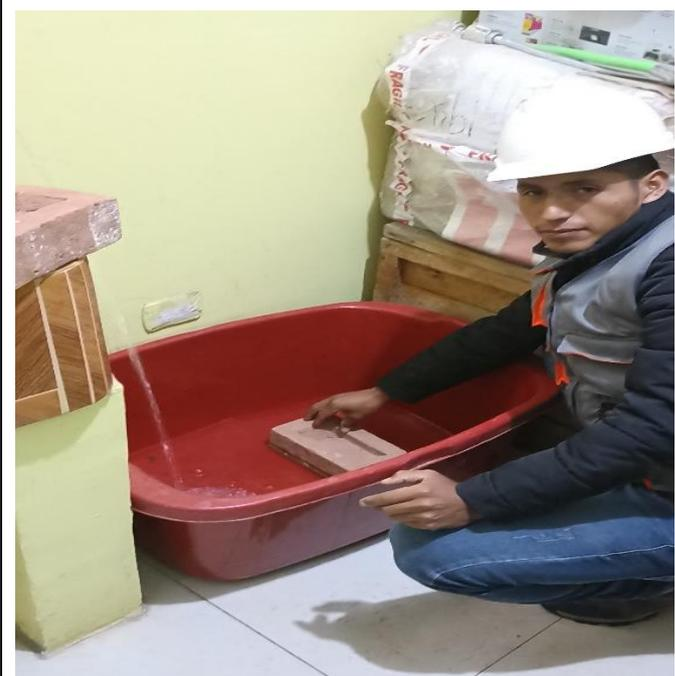
**Fotografía 31:** Ensayo de Porcentaje de Absorción.
