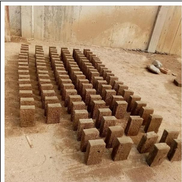
**Fotografía 17:** Secado de ladrillo en temperatura normal
