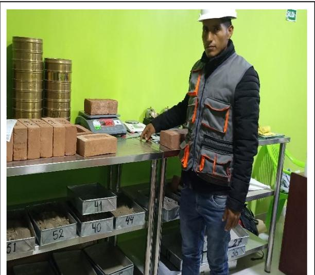
**Fotografía 30:** Realizando el peso del ladrillo para el ensayo de Porcentaje de absorción
