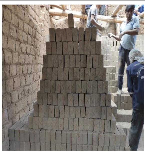
**Fotografía 18:** Colocación de ladrillo en el hornillo artesanal
