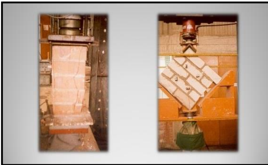
Figura 4. Albañilería en forma de prismas
