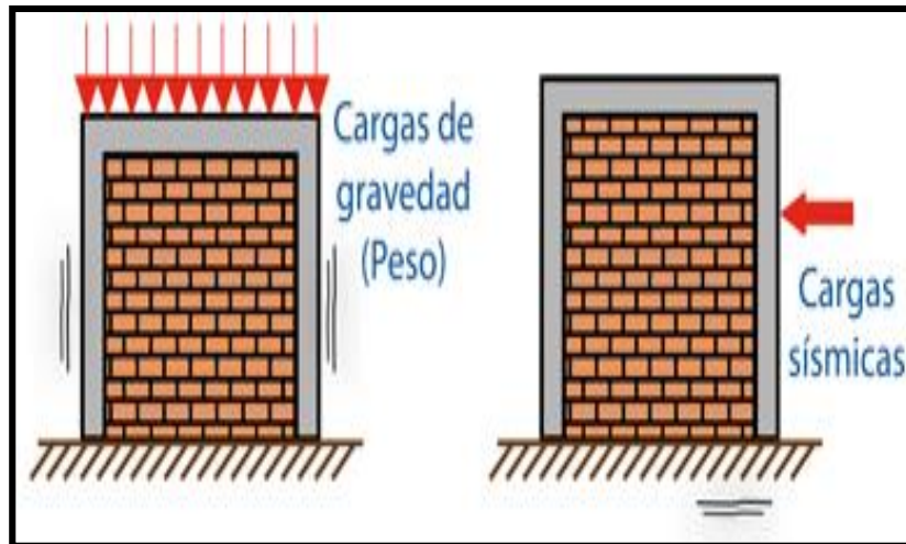
Figura 1. Carga sísmica y de gravedad en muros de albañilería
